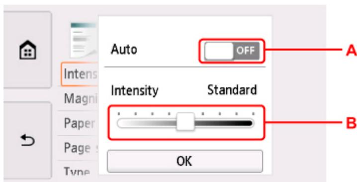
A: Selezionare per attivare/disattivare la regolazione automatica dell'intensità.
