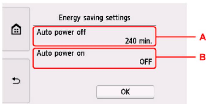
A: Specificare il periodo di tempo dopo il quale la stampante si spegne automaticamente se non viene effettuata alcuna operazione o se non vengono inviati dati di stampa alla stampante.
