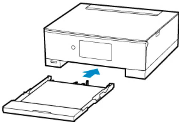
Il formato carta viene rilevato e impostato automaticamente nella stampante.
