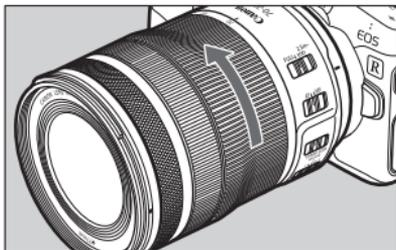
**1** Ruotare l'anello di zoom fino alla posizione di minima lunghezza focale (70 mm).
