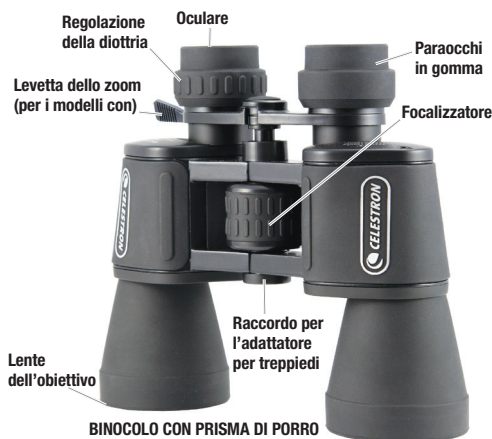
BINOCOLO CON PRISMA DI PORRO
