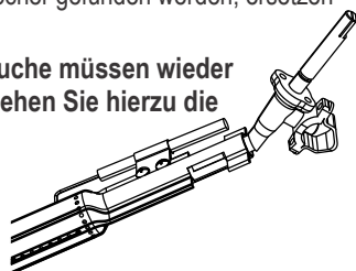
Die korrekte Verbindung vom Brenner zum Ventil
