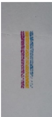
Imm. 17: Campione di colori che viene riprodotto durante la pulizia automatica della testina di stampa
