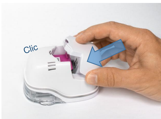
Imm. 34: Inserimento della batteria
