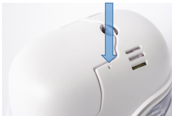
Imm. 37: Apertura per resettare il dispositivo
