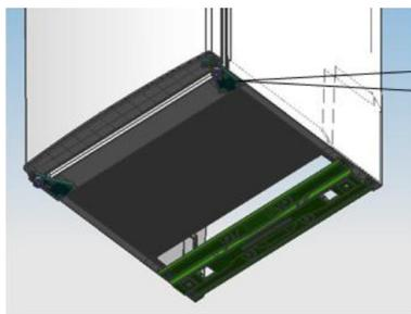
5. Spostare il supporto inferiore della porta e il blocco di posizionamento sul lato opposto
