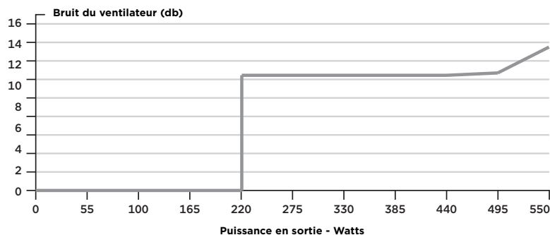
Courbe de bruit du ventilateur de l'alimentation CORSAIR RM550x
