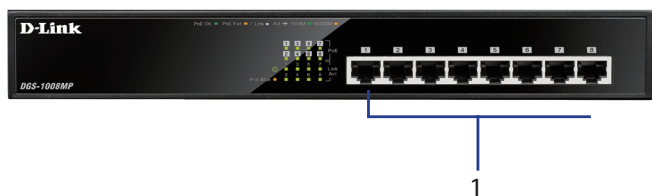
2. ábra: Csatlakozók az elülső panelen
