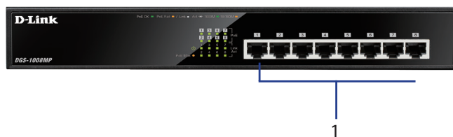
Figura 2: Conectori panou frontal
