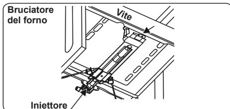
Rimuovere gli iniettori tramite una chiave da 7 mm e sostituirli con quelli del set di ricambio. Assicurarsi di utilizzare i diametri corrispondenti adatti al tipo di
