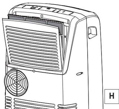
Per togliere la polvere depositata sul filtro usare un aspirapolvere. Se è molto sporco immergerlo in acqua tiepida risciacquando più volte. La temperatura dell'acqua va mantenuta sotto i 40° C.
