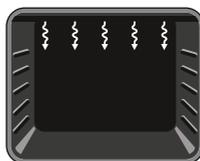
**Funzione grill:** il termostato del forno e le spie si accendono ed entra in funzione l'elemento riscaldante del grill. Questa funzione è utilizzata
