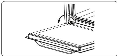
2. Aprire il fermo di bloccaggio (a) (con l'aiuto di un cacciavite) fino alla posizione finale.
