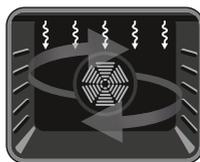
**Funzione cottura ventilata e grill:** il termostato del forno e le spie si accendono ed entrano in funzione il grill e la ventola. Questa funzione è ideale per grigliare
