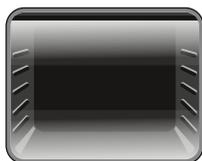
**Funzione cottura statica:** il termostato del forno e le spie si accendono, ed entrano in funzione gli elementi riscaldanti inferiore e superiore. La funzione di cottura statica
