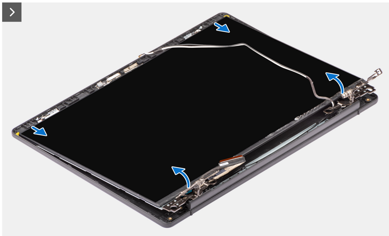
Figura 78. Rimozione del pannello del display
