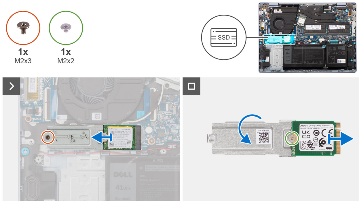
Figura 32. Rimozione dell'unità SSD
