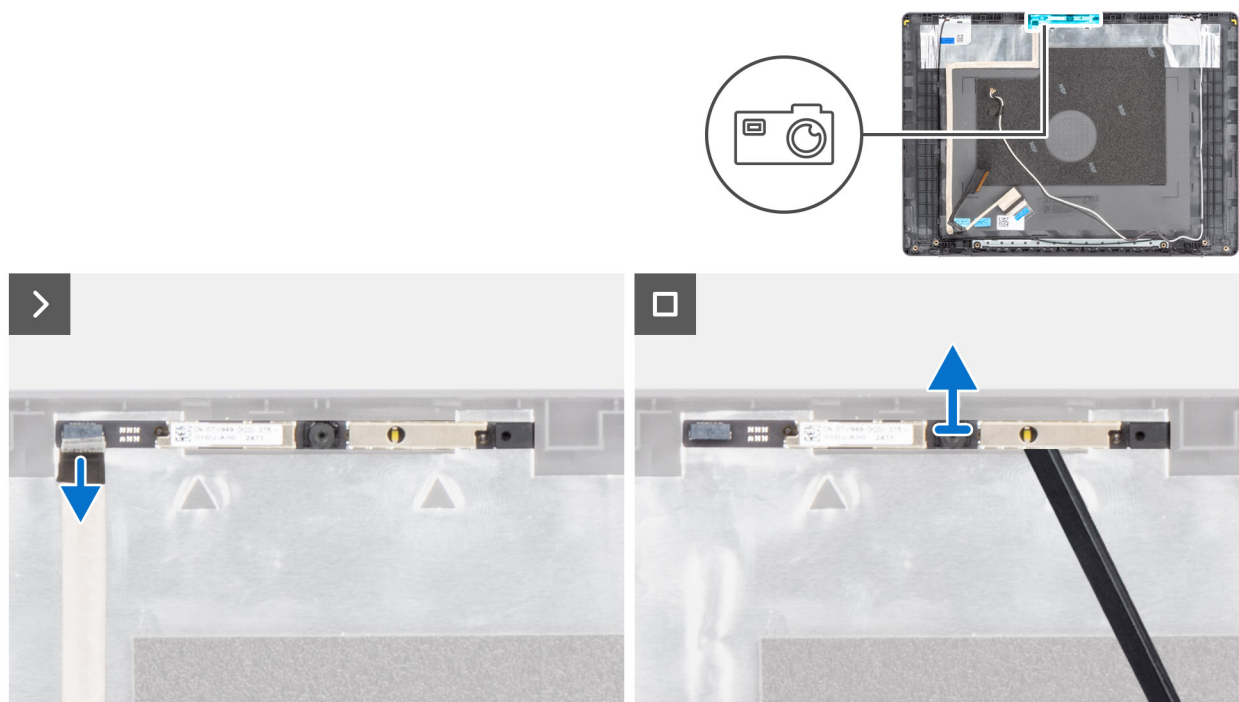
Figura 87. Rimozione della fotocamera
