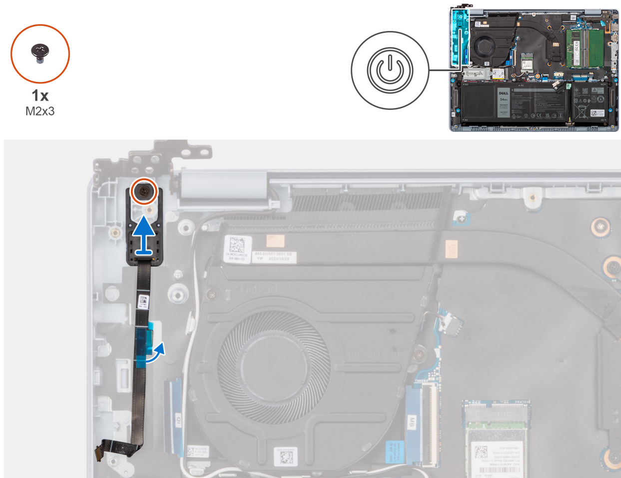
Figura 54. Immagine: Rimozione del pulsante di accensione
