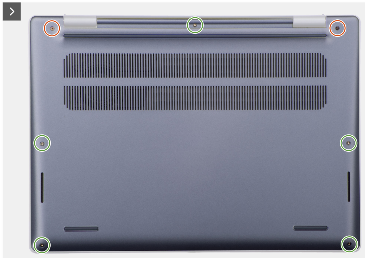
Figura 16. Rimozione del coperchio della base
