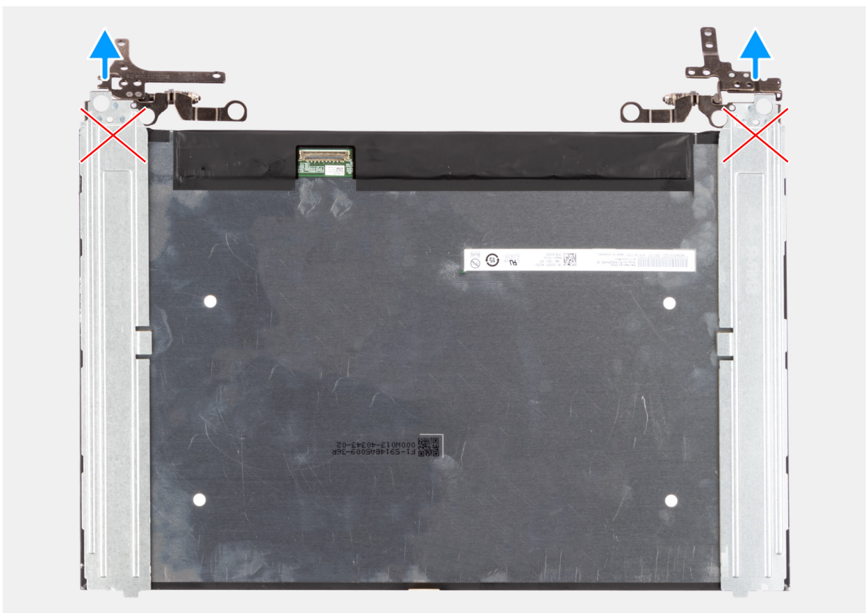
Figura 80. Rimozione del pannello del display
