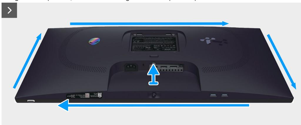
**Figura 14. Rimozione del coperchio posteriore**
