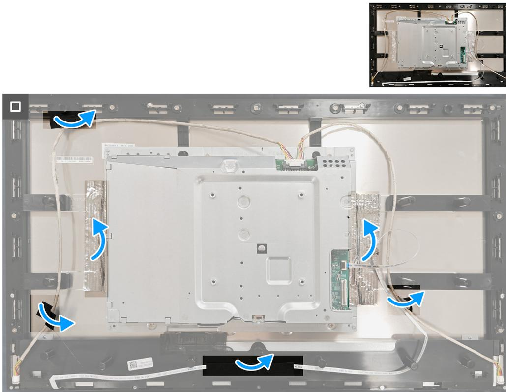
**Figura 29. Installazione della schermatura metallica**
