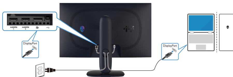
Figura 8. Collegamento del cavo DisplayPort (DP a DP)
