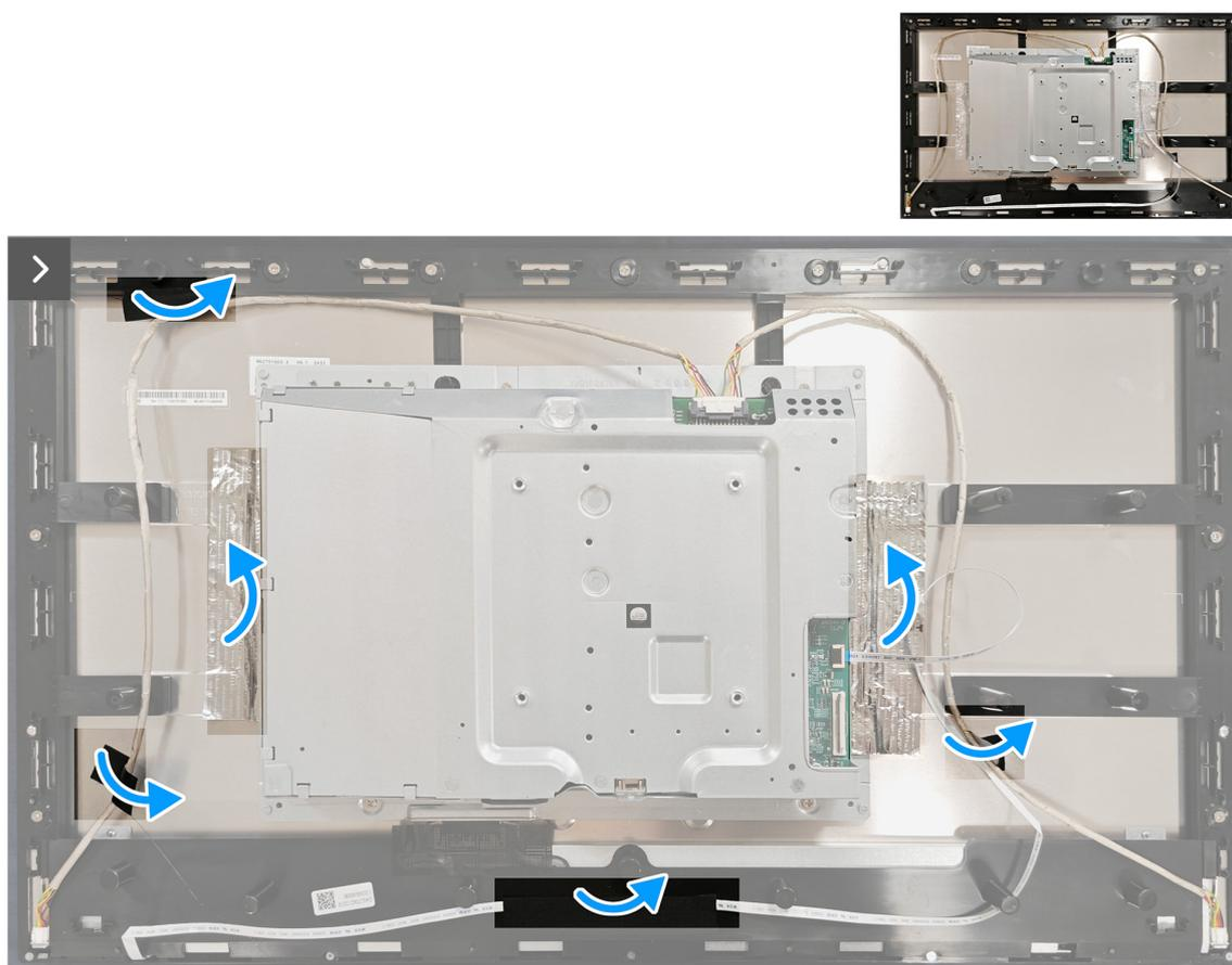
**Figura 20. Rimozione della schermatura metallica**
