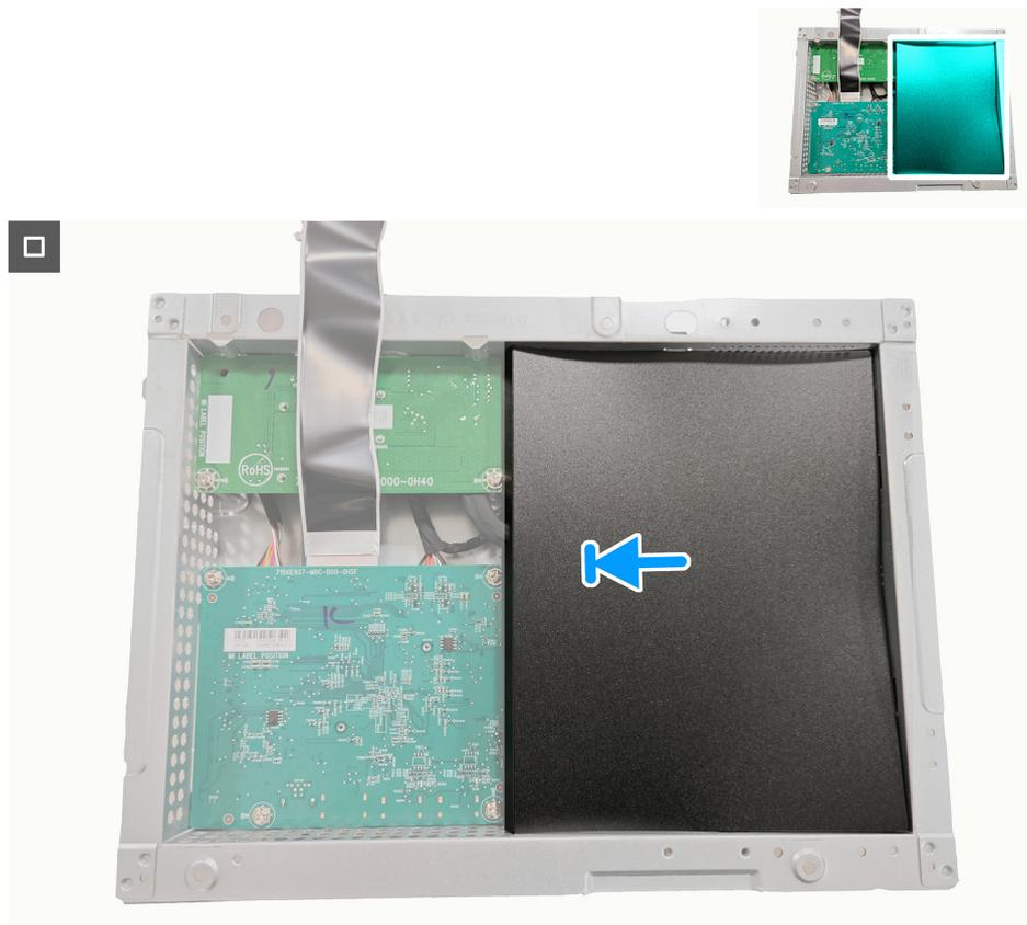
**Figura 35. Installazione della scheda di sistema e della scheda di alimentazione**
