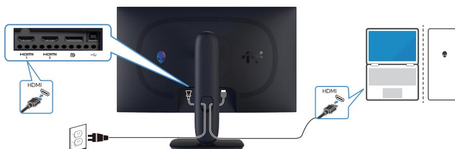
Figura 9. Collegamento del cavo HDMI
