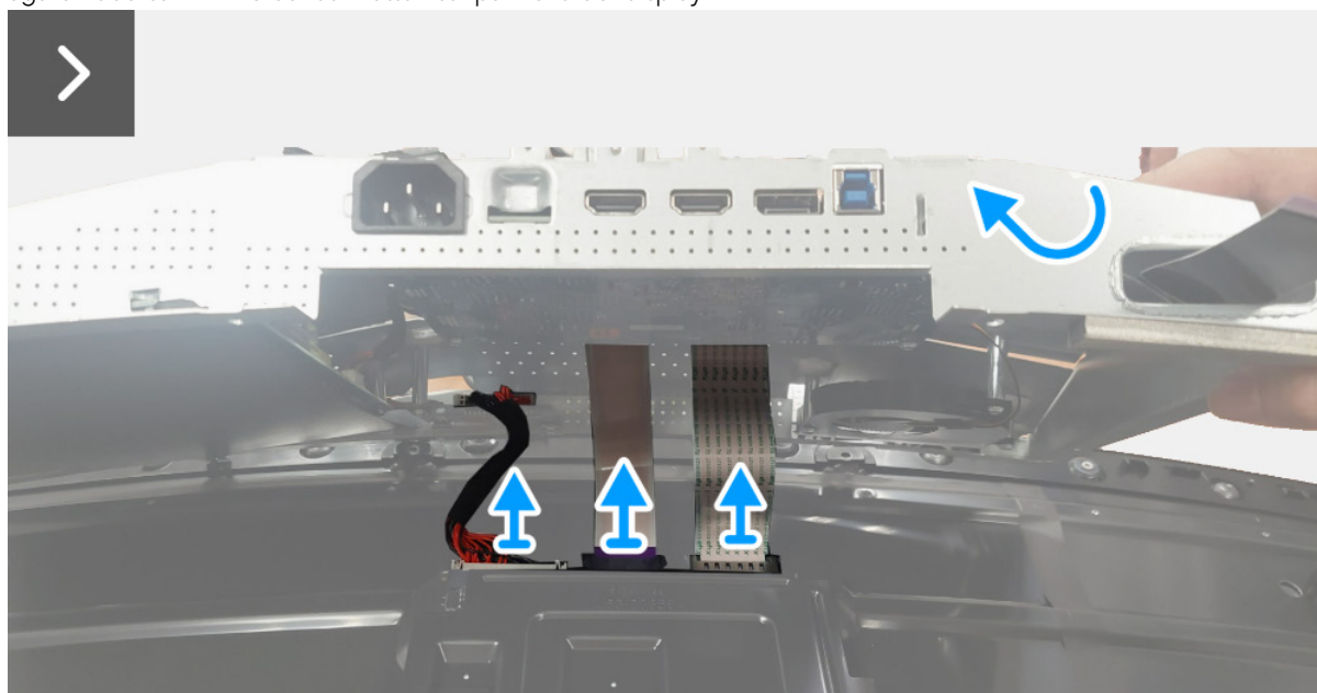
Immagine 21. Rimozione della protezione in metallo
