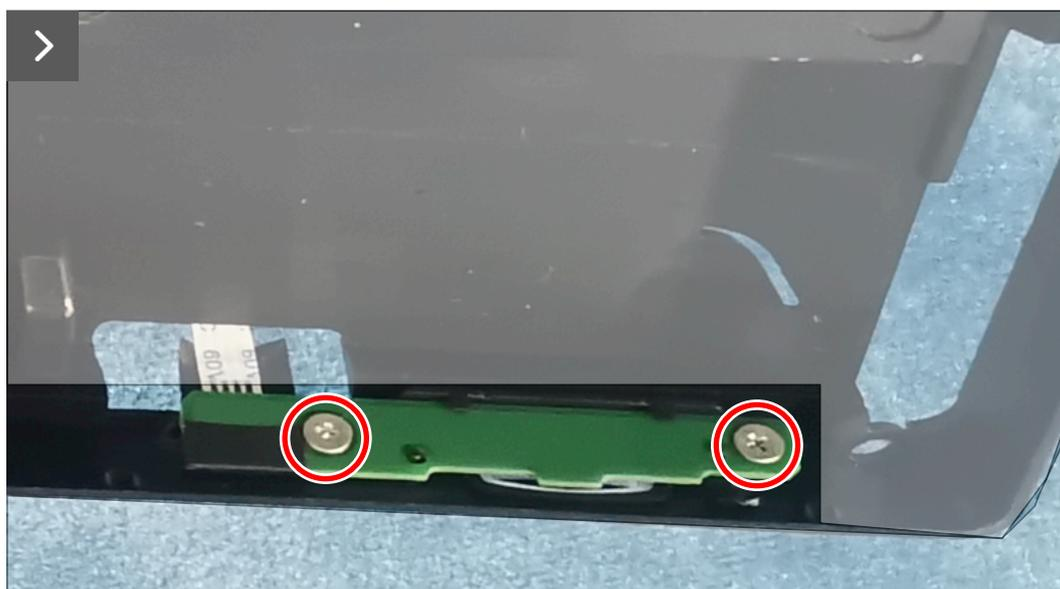
**Figura 40. Installazione della scheda del tasto di alimentazione**
