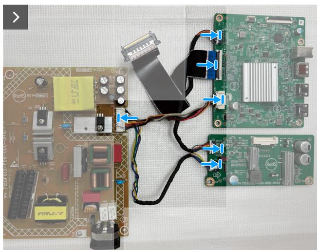
**Figura 33. Installazione della scheda di sistema e della scheda di alimentazione**
