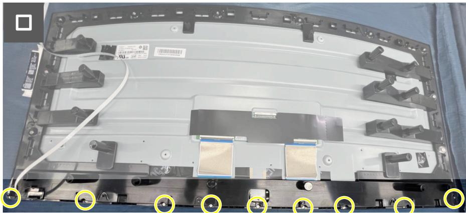
**Figura 37. Installazione della struttura centrale**
