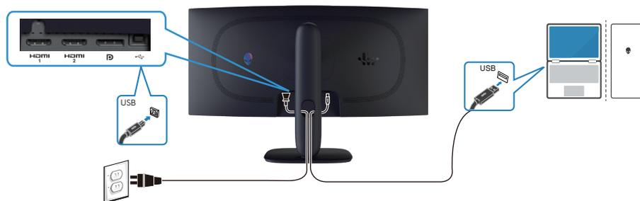
**Figura 10. Collegamento del cavo USB tipo B (tipo B-tipo A)**
