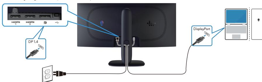
Figura 8. Collegamento del cavo DisplayPort (DP a DP)
