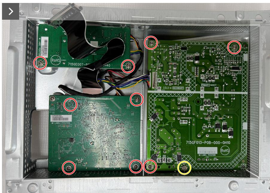
**Figura 31. Rimozione della scheda di sistema e della scheda di alimentazione**
