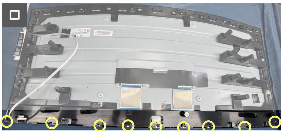
**Figura 36. Rimozione della struttura centrale**
