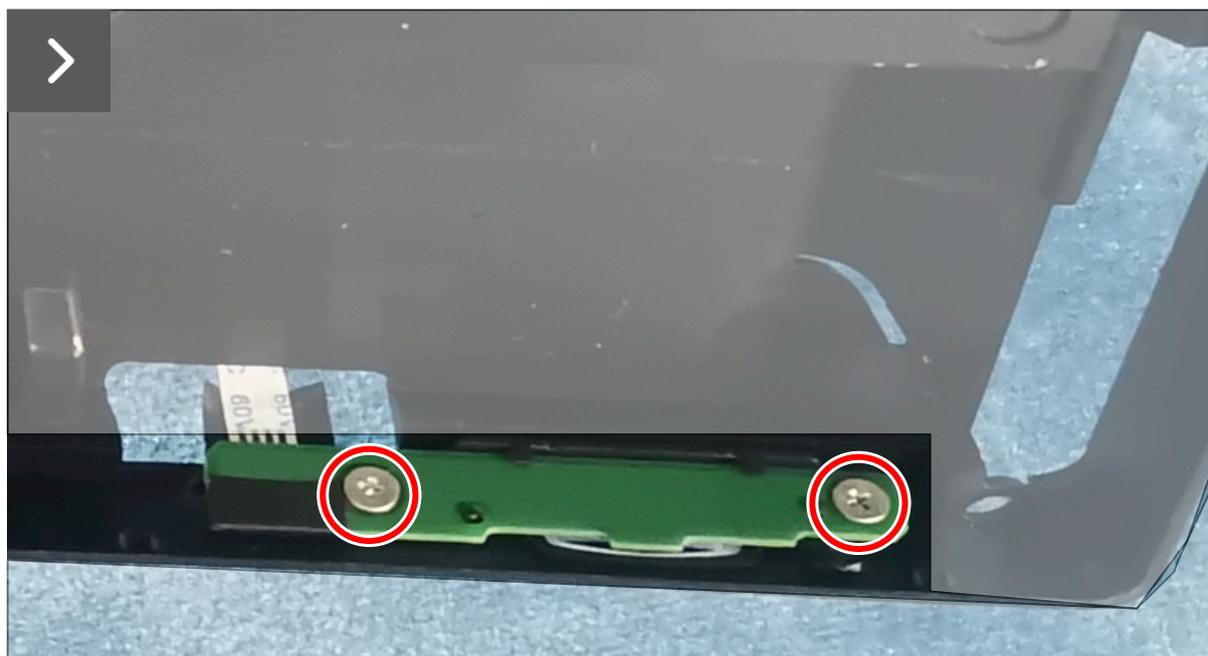
**Figura 38. Rimozione della scheda del tasto di alimentazione**
