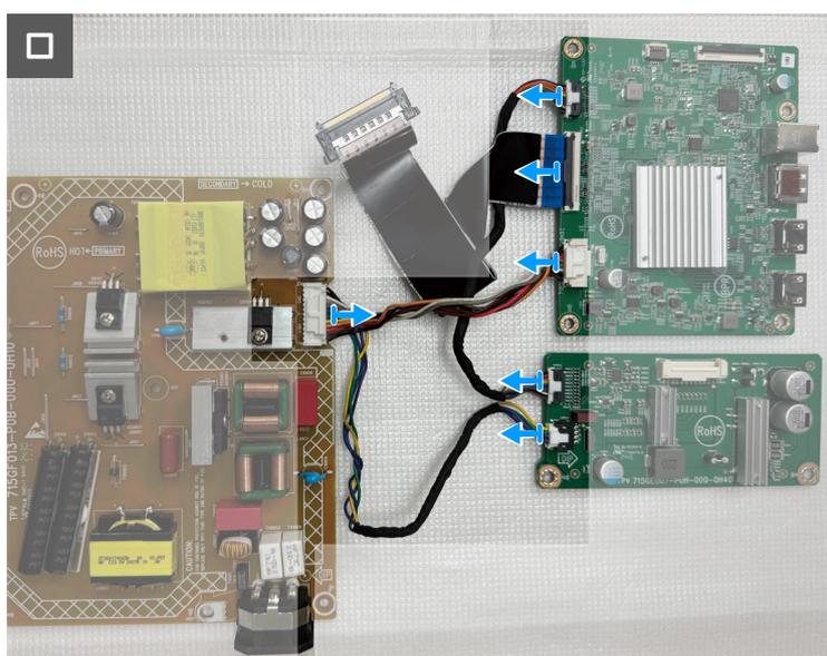
**Figura 32. Rimozione della scheda di sistema e della scheda di alimentazione**
