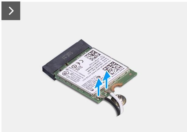
Figura 30. Rimozione della scheda wireless
