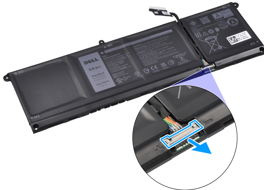
Figura 23. Rilascio del connettore del cavo della batteria
