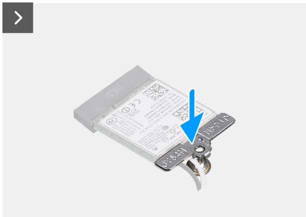
Figura 31. Installazione della scheda wireless
