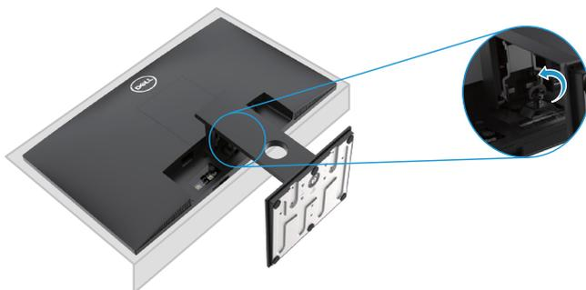
2. Inserire il montante fuori della monitor completamente.
