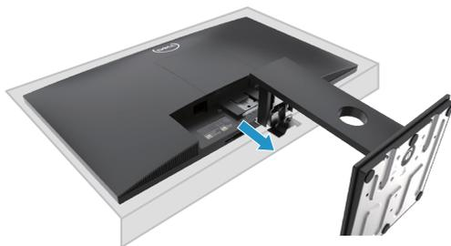
3. Allentare completamente vite della base del supporto per rimuovere la base dal montante.
