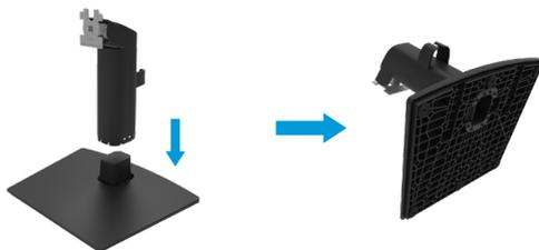
2. Fissare il supporto montato al monitor.
