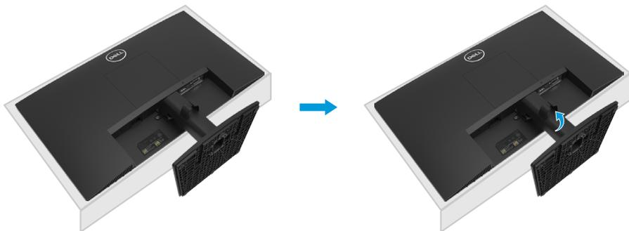
2. a. Usare un cacciavite lungo per spingere il fermo che si trova nel foro appena sopra il supporto.
