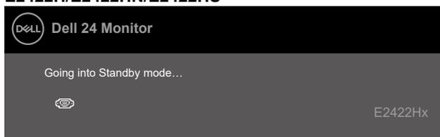
Se il cavo VGA, DP o HDMI non è collegato, viene visualizzata una finestra di dialogo mobile. Se lasciato in questo stato, il monitor accederà a Modalità Standby dopo 4 minuti.
