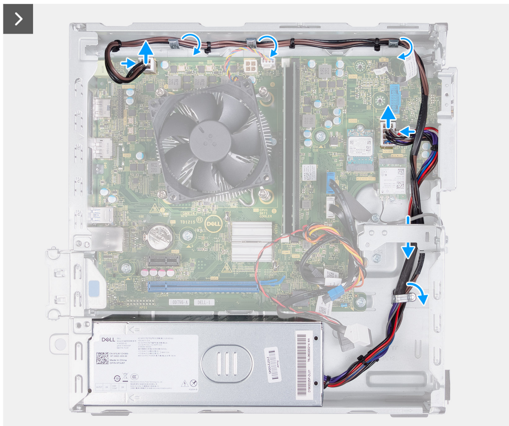
Figura 40. Rimozione dei cavi dalle guide di instradamento
