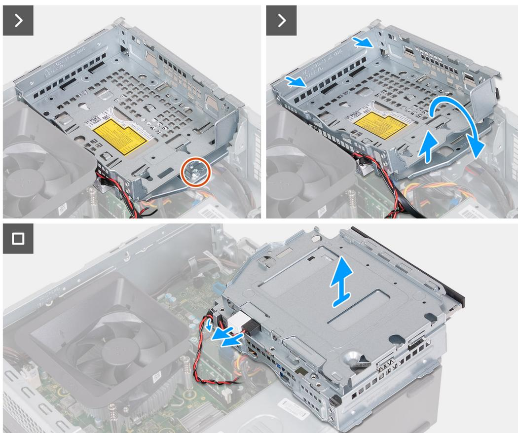
Figura 18. Rimozione della gabbia del disco rigido e dell'unità ottica
