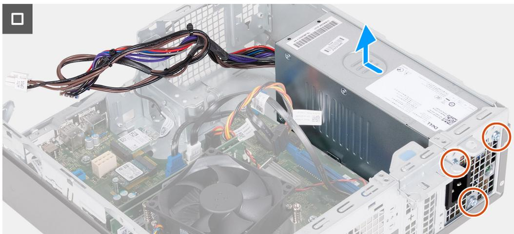
Figura 41. Rimozione dell'unità di alimentazione
