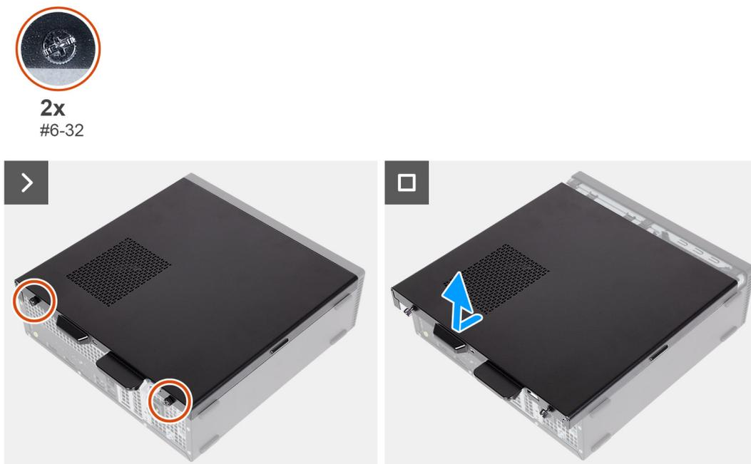
Figura 12. Rimozione del pannello laterale sinistro
