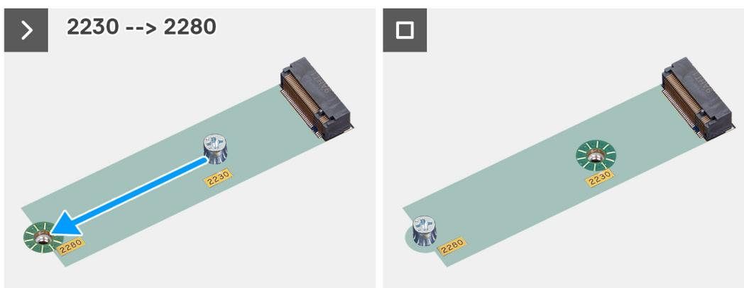
Figura 30. Fissaggio della vite da 2230 a 2280
