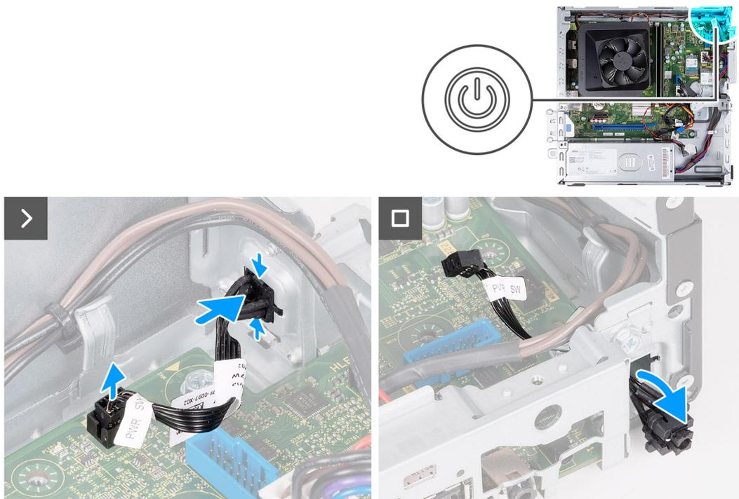
Figura 22. Rimozione del pulsante di accensione
