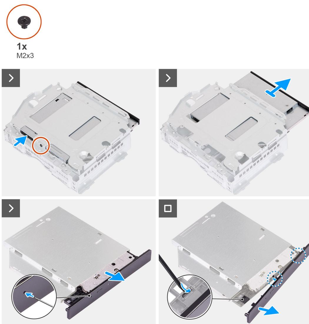
Figura 20. Rimozione dell'unità ottica
