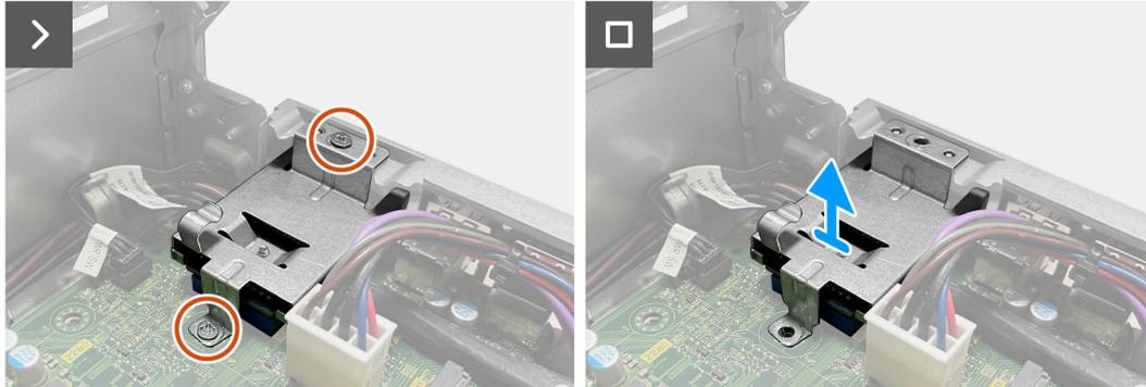
**Figura 36. Rimozione del lettore di schede multimediali**
