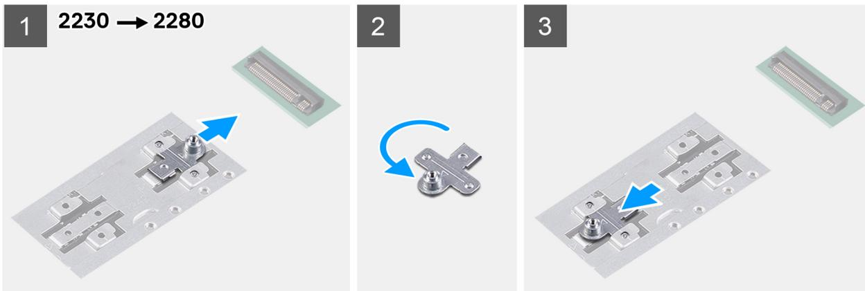
L'immagine seguente fornisce una rappresentazione visiva della procedura per installare la staffa di montaggio dell'unità SSD quando si sostituisce un'unità SSD M.2 2280 con un'unità SSD M.2 2230 nello slot M.2 uno.
