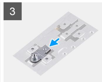
L'immagine seguente fornisce una rappresentazione visiva della procedura per installare la staffa di montaggio dell'unità SSD quando si sostituisce un'unità SSD M.2 2280 con un'unità SSD M.2 2230 nello slot M.2 uno.
