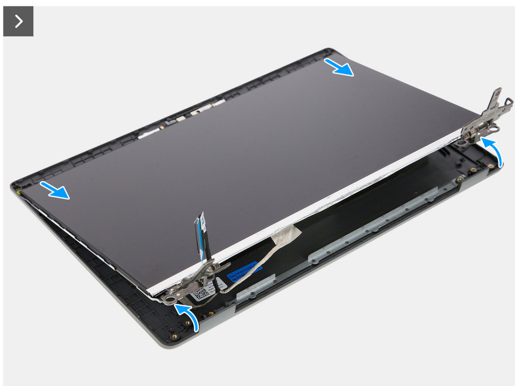
Figura 56. Rimozione del pannello del display
