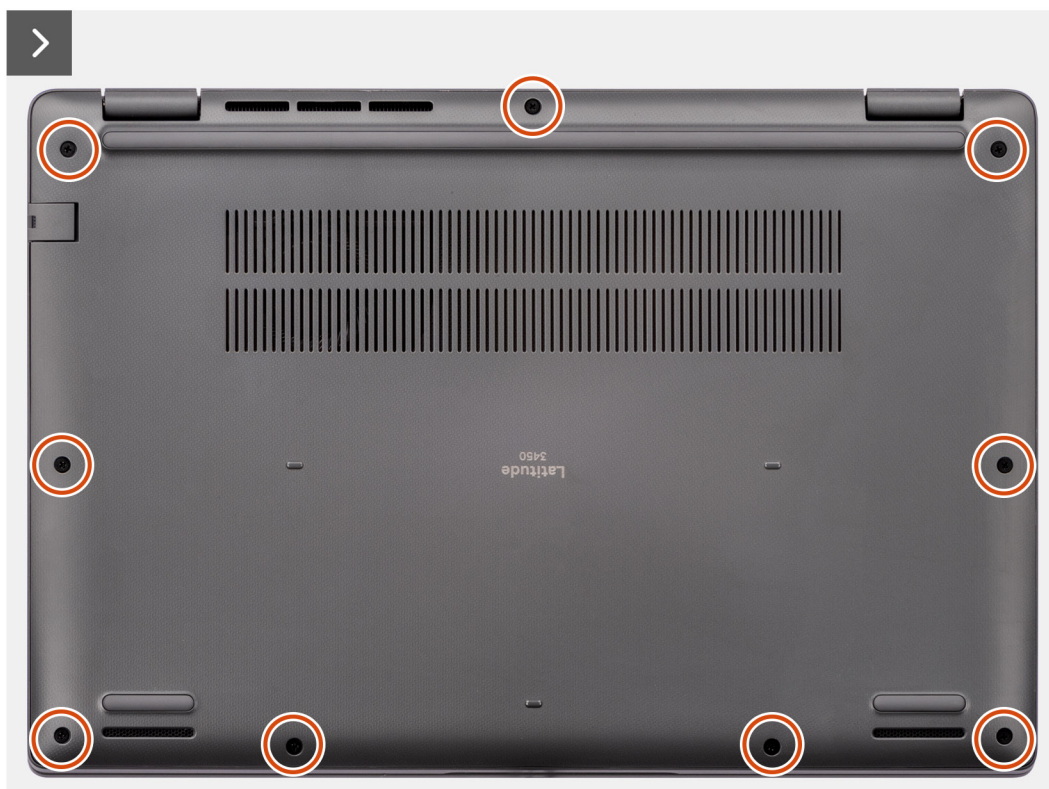
Figura 9. Rimozione del coperchio della base
