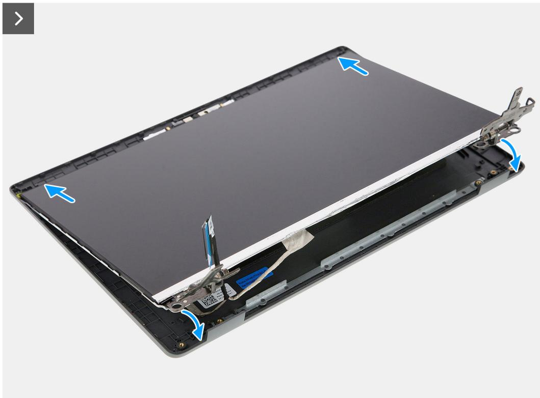
Figura 61. Installazione del pannello del display
