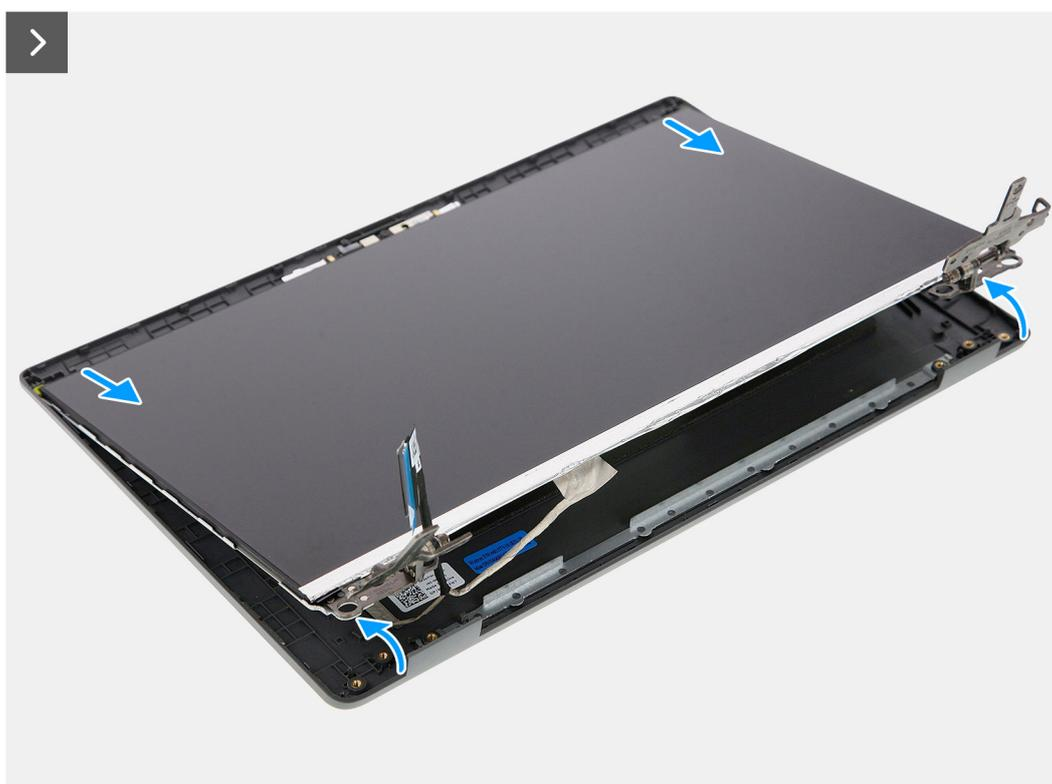
Figura 56. Rimozione del pannello del display
