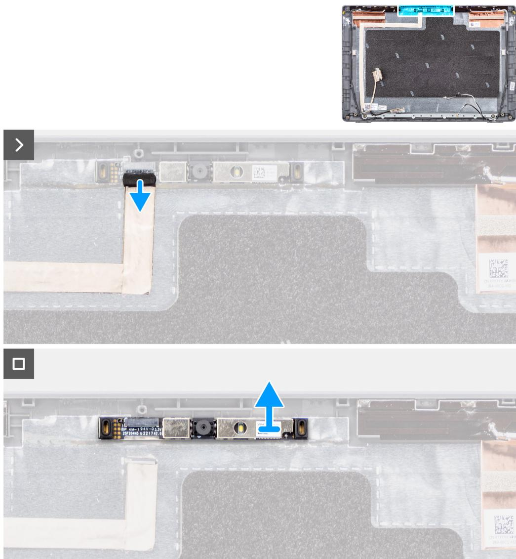
Figura 64. Rimozione della fotocamera
