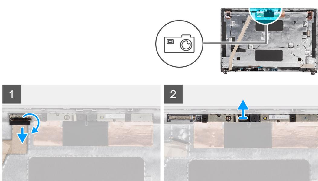
**Figura 2. Rimozione del modulo della fotocamera a infrarossi**
