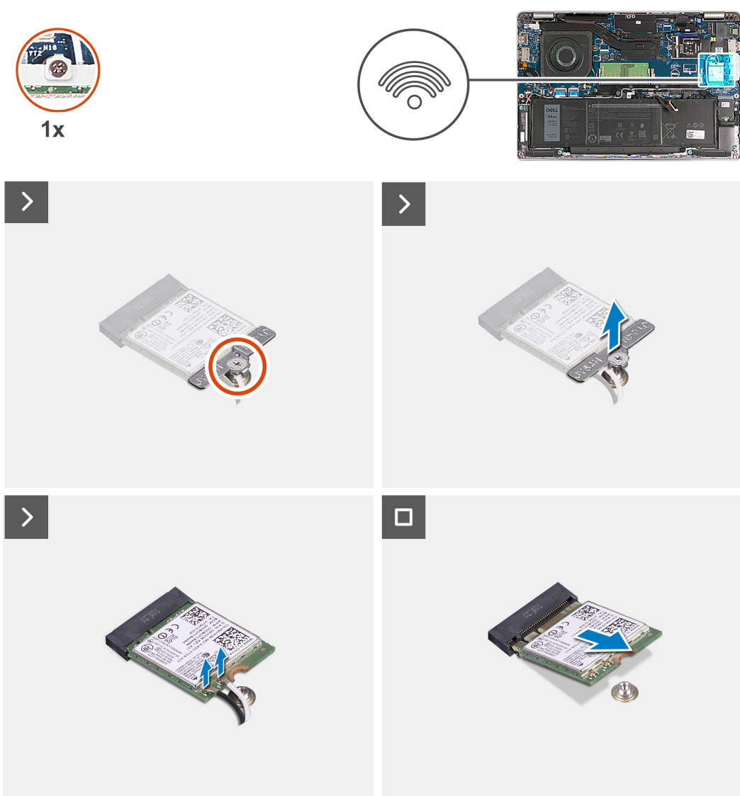
Figura 10. Rimozione della scheda wireless
