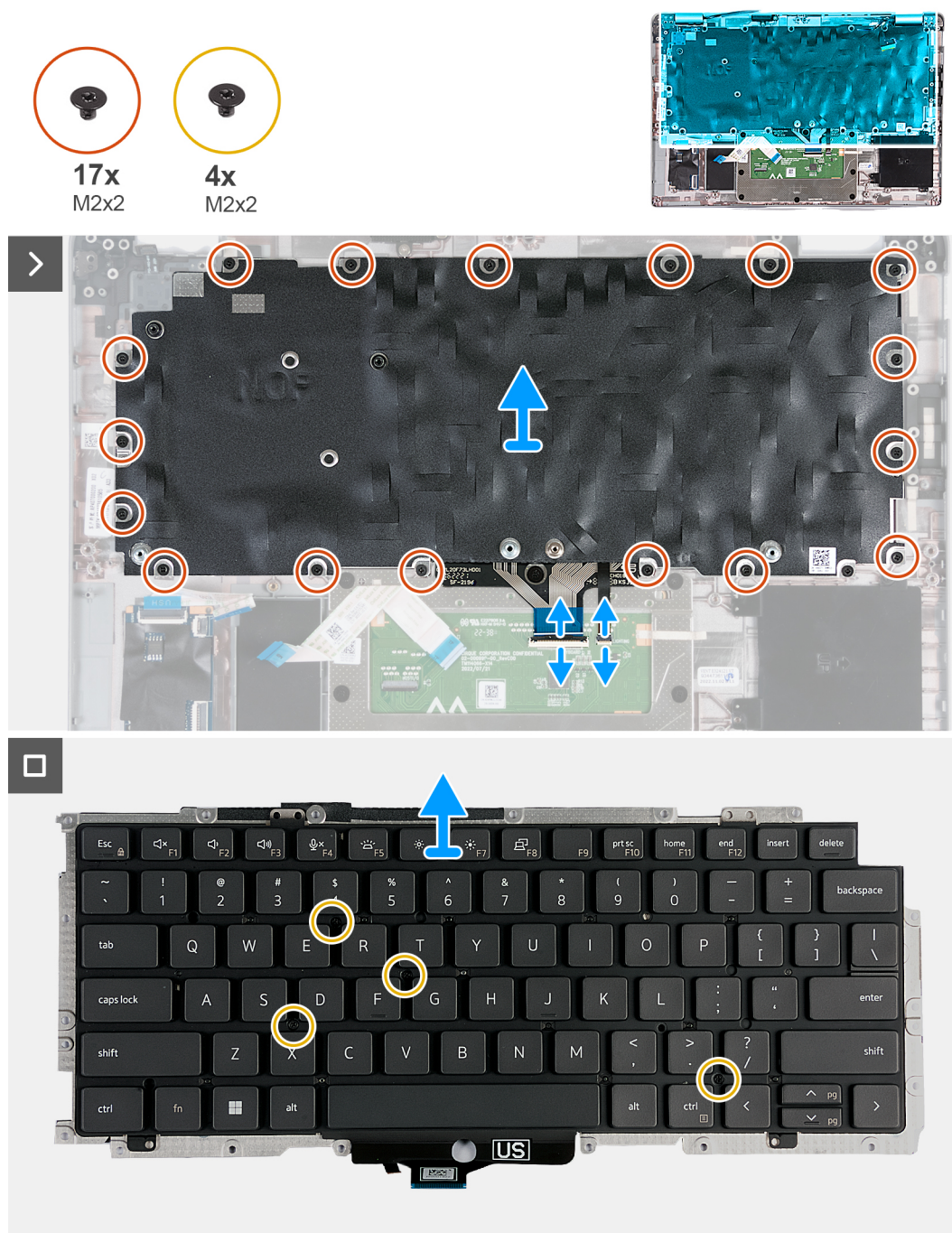
Figura 61. Rimozione della tastiera
