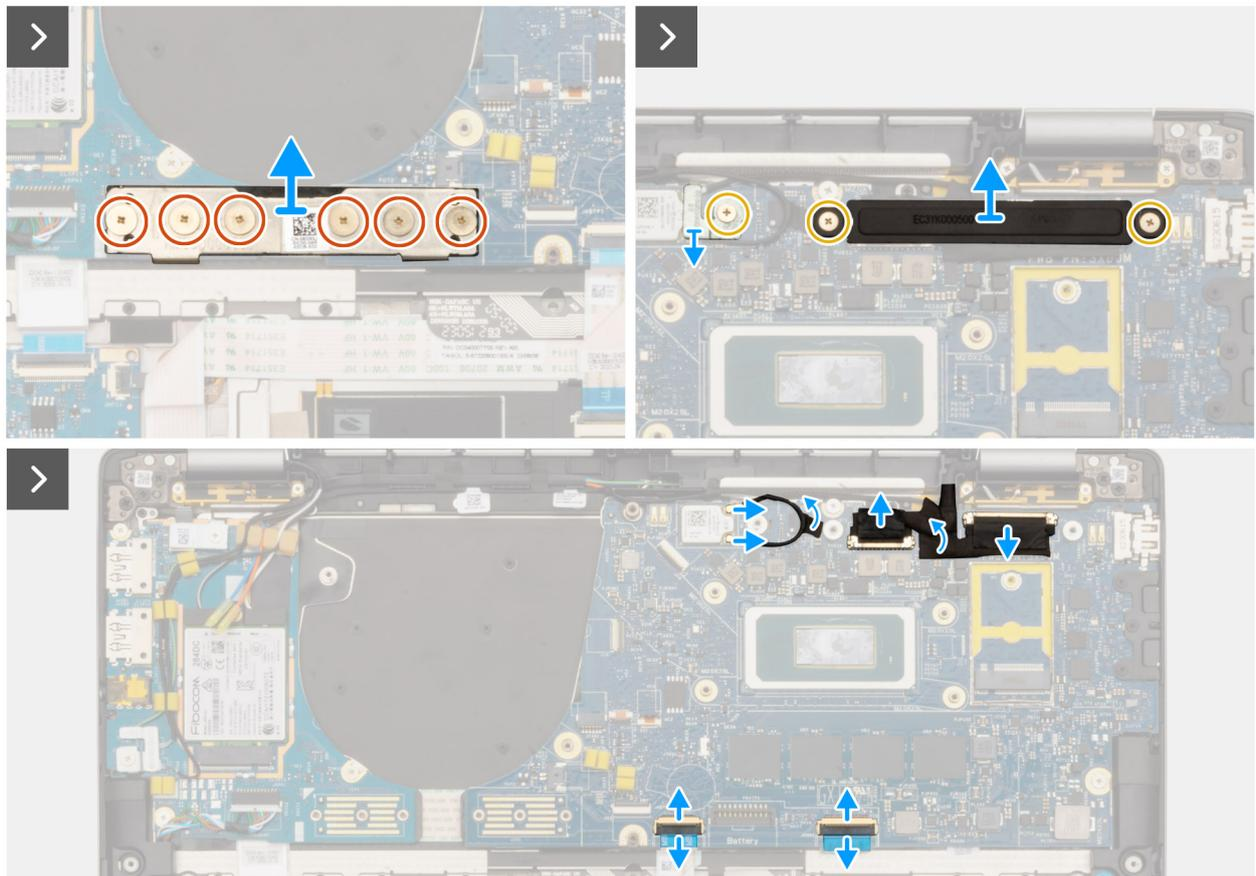
Figura 59. Rimozione della scheda di sistema
