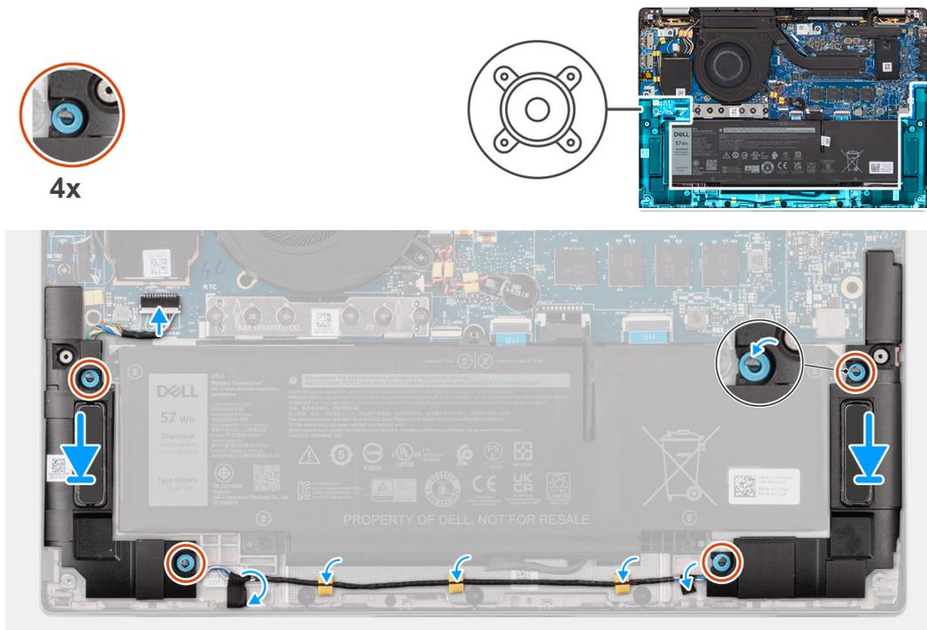
Figura 34. Installazione degli altoparlanti per sistemi classici
