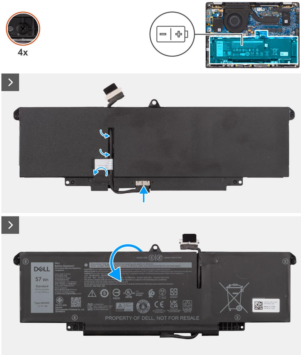
Figura 42. Installazione della batteria a 3 celle
