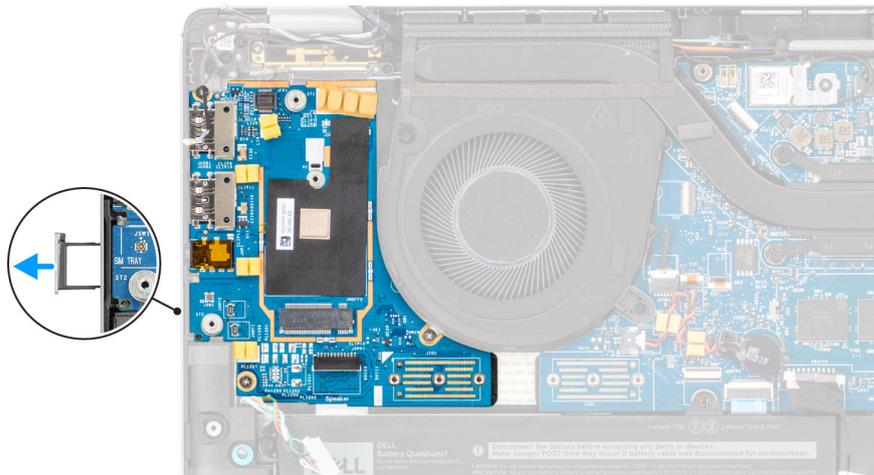
Figura 14. Rimozione della scheda figlia di I/O
