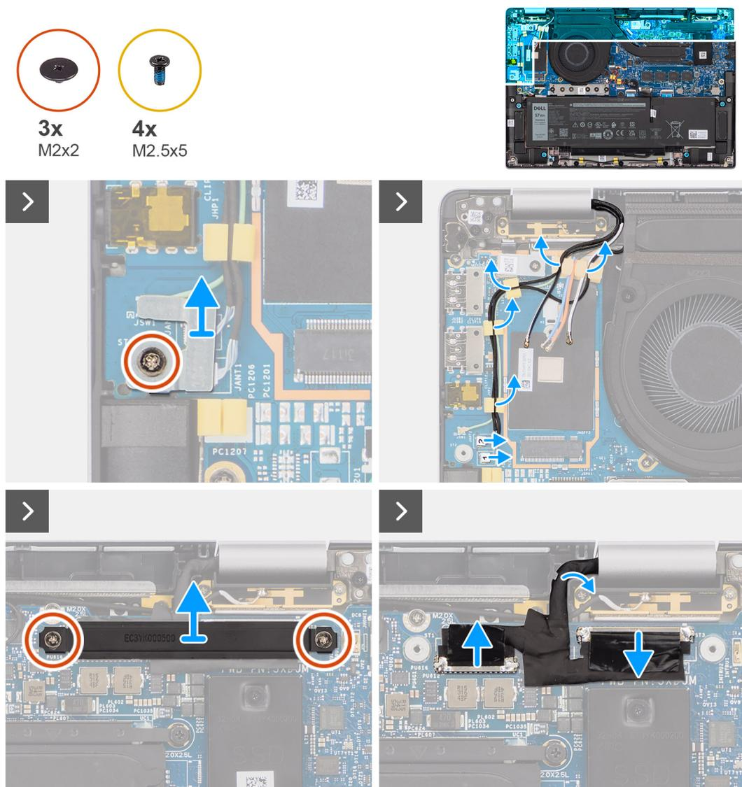
Figura 48. Rimozione del gruppo del display
