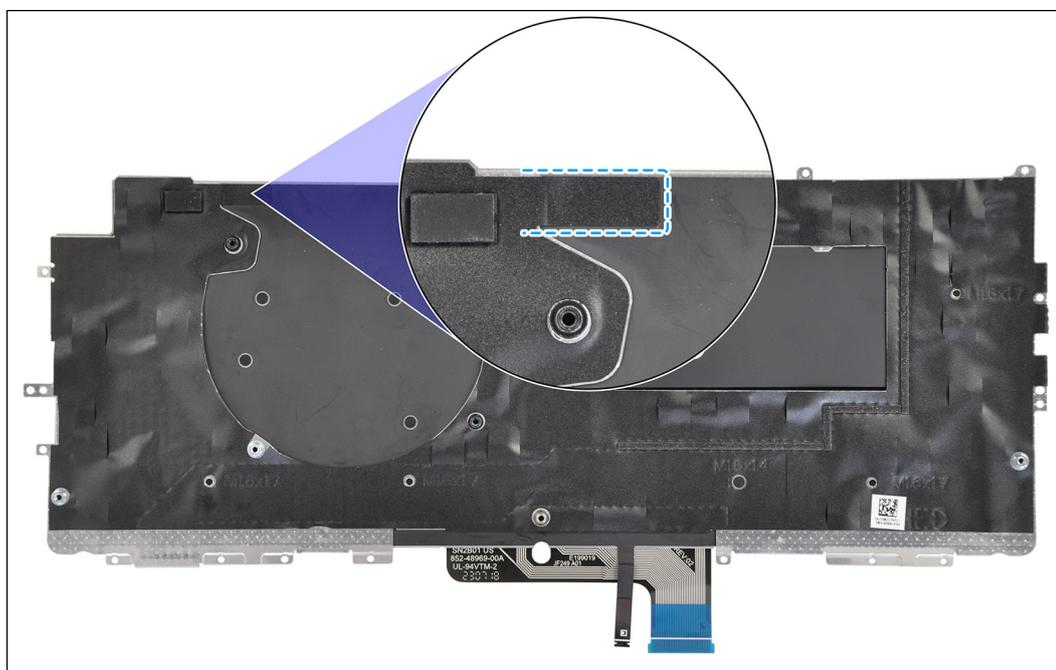
**Figura 80. Rimozione del nastro mylar della tastiera**
