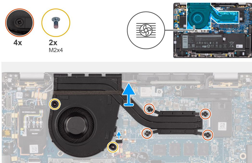
Figura 46. Rimozione del gruppo dissipatore di calore e ventola
