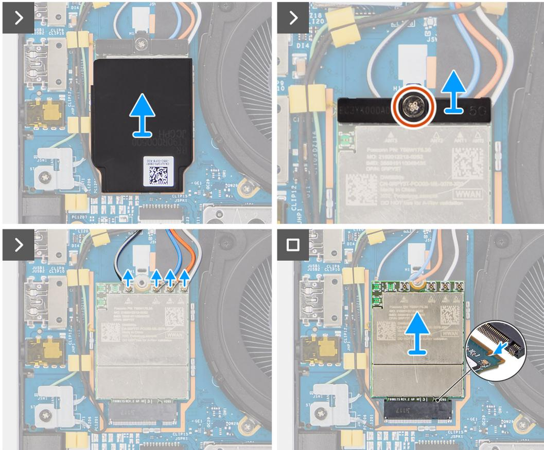
Figura 26. Rimozione della scheda WWAN 5G
