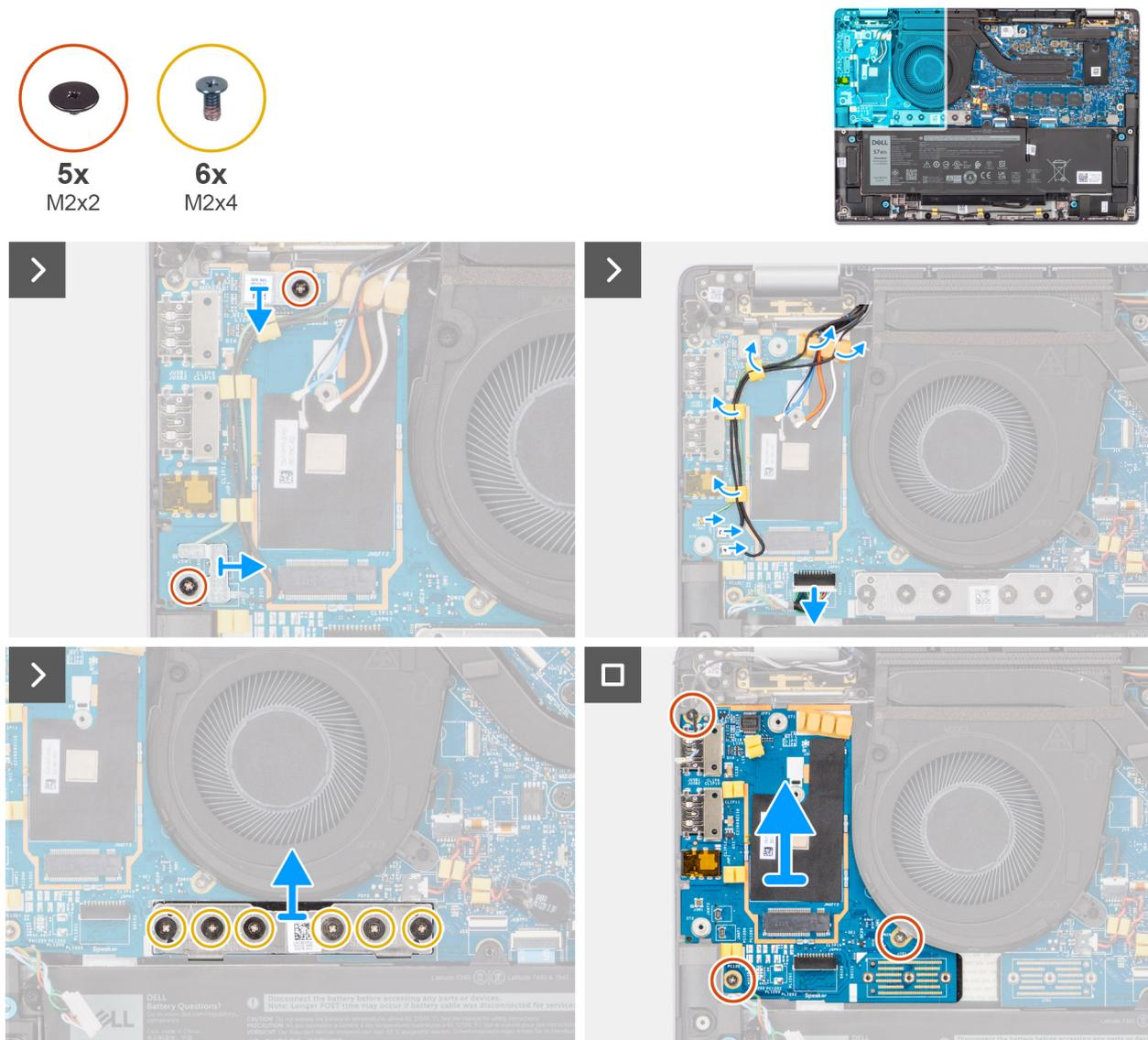
**Figura 71. Rimozione della scheda figlia di I/O**
