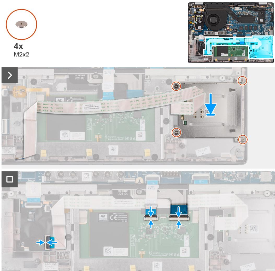
**Figura 57. Installazione del lettore di smart card**
