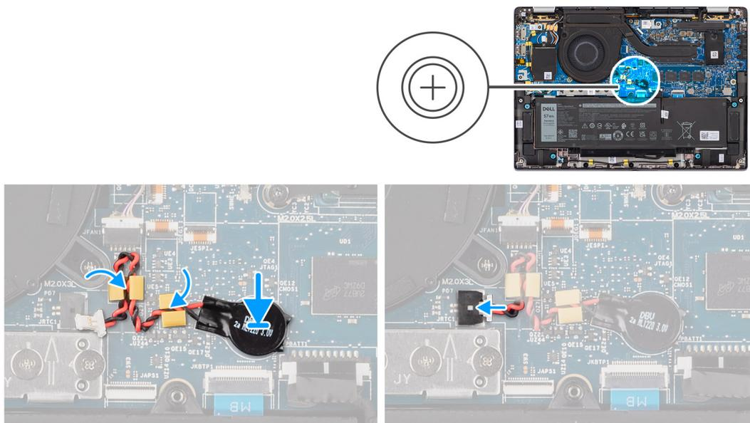
**Figura 36. Installazione della batteria a bottone**
