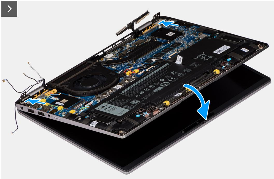
Figura 53. Installazione del gruppo del display
