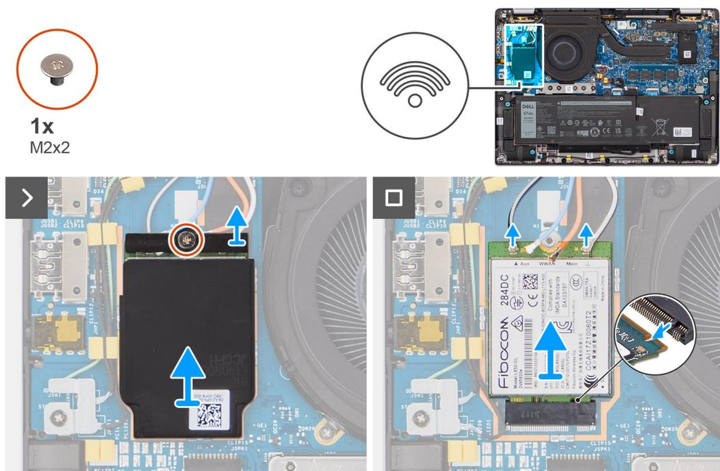
**Figura 24. Rimozione della scheda WWAN 4G**
