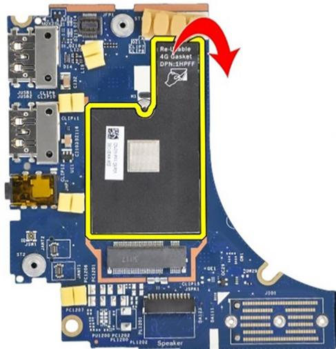
Figura 73. Configurazione Latitude 7450 2-in-1 4G WWAN (adesivo a guarnizione)
