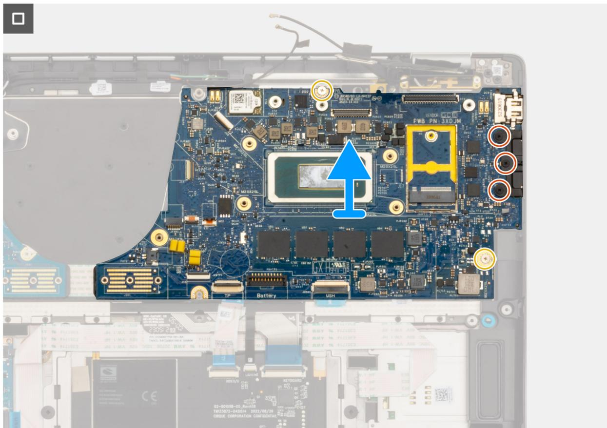
**Figura 60. Rimozione della scheda di sistema**
