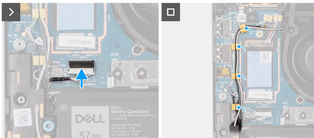
Figura 32. Installazione degli altoparlanti per ultralight
