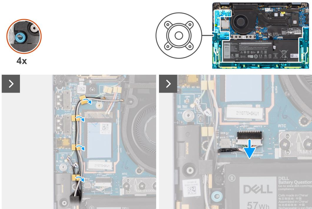
Figura 29. Rimozione degli altoparlanti per ultralight
