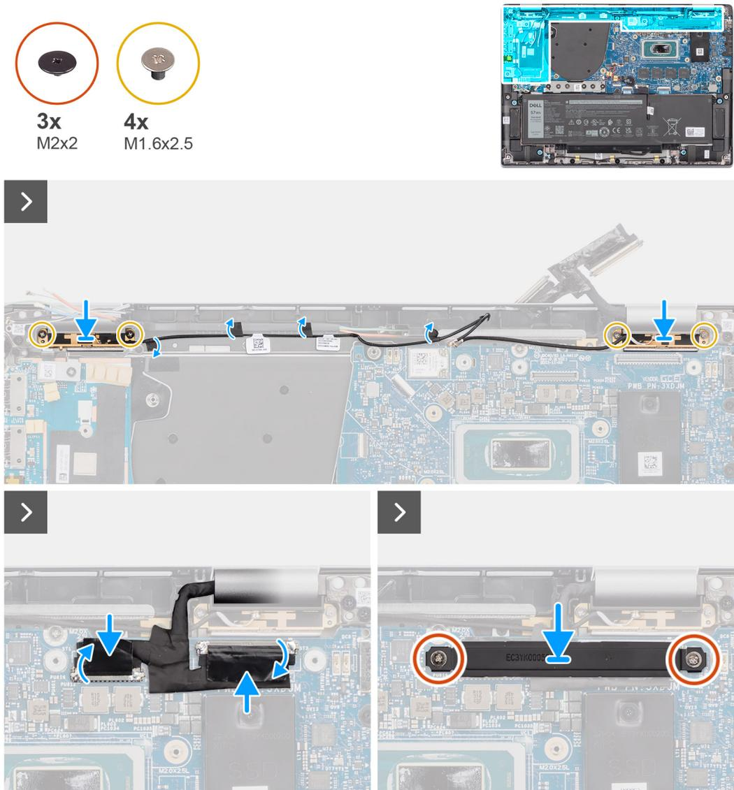
Figura 68. Installazione del modulo dell'antenna WLAN
