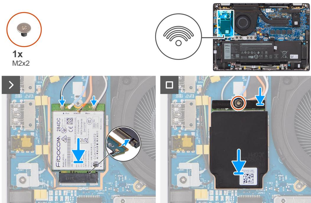
**Figura 25. Installazione della scheda WWAN 4G**
