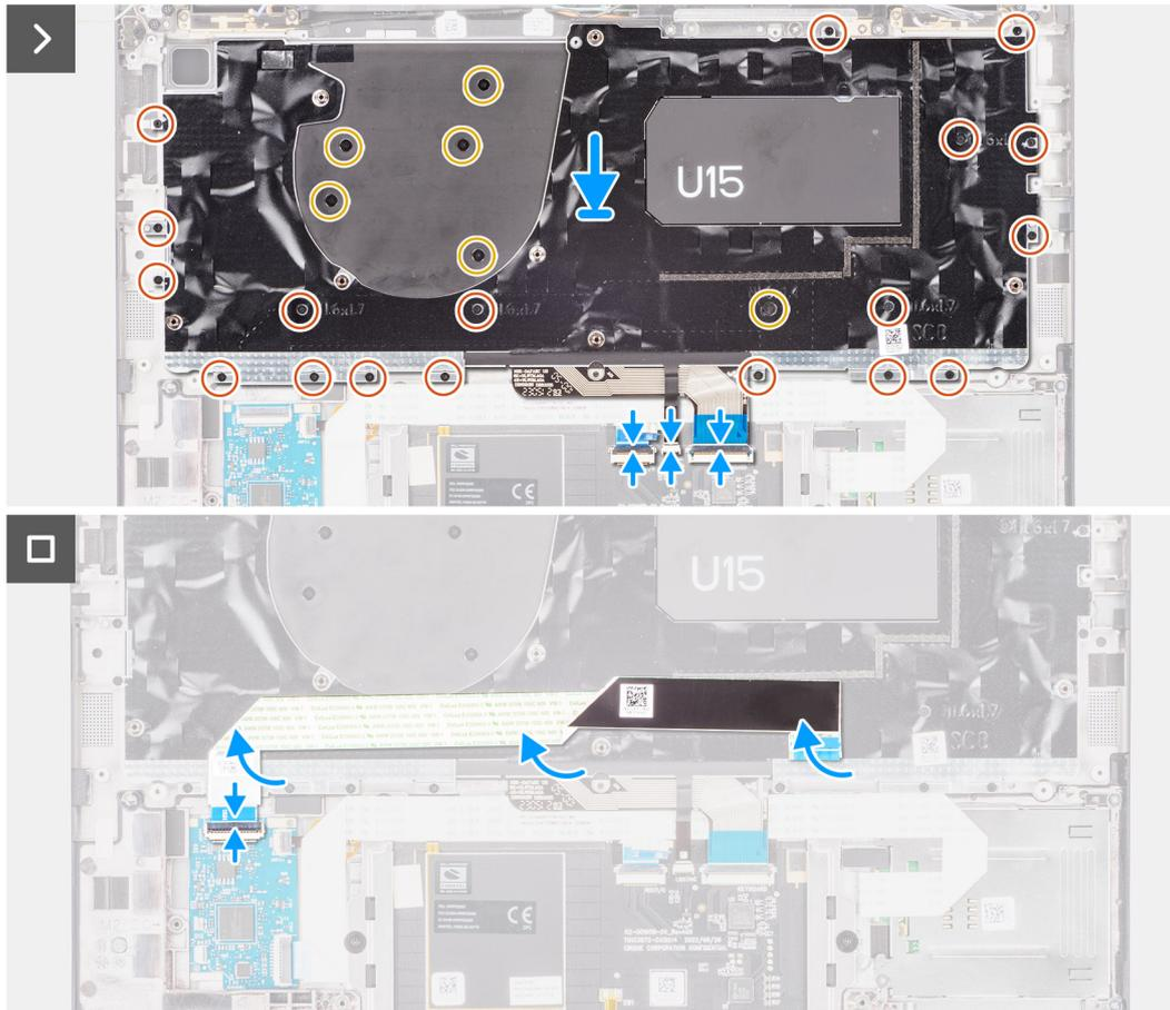
**Figura 81. Installazione della tastiera**
