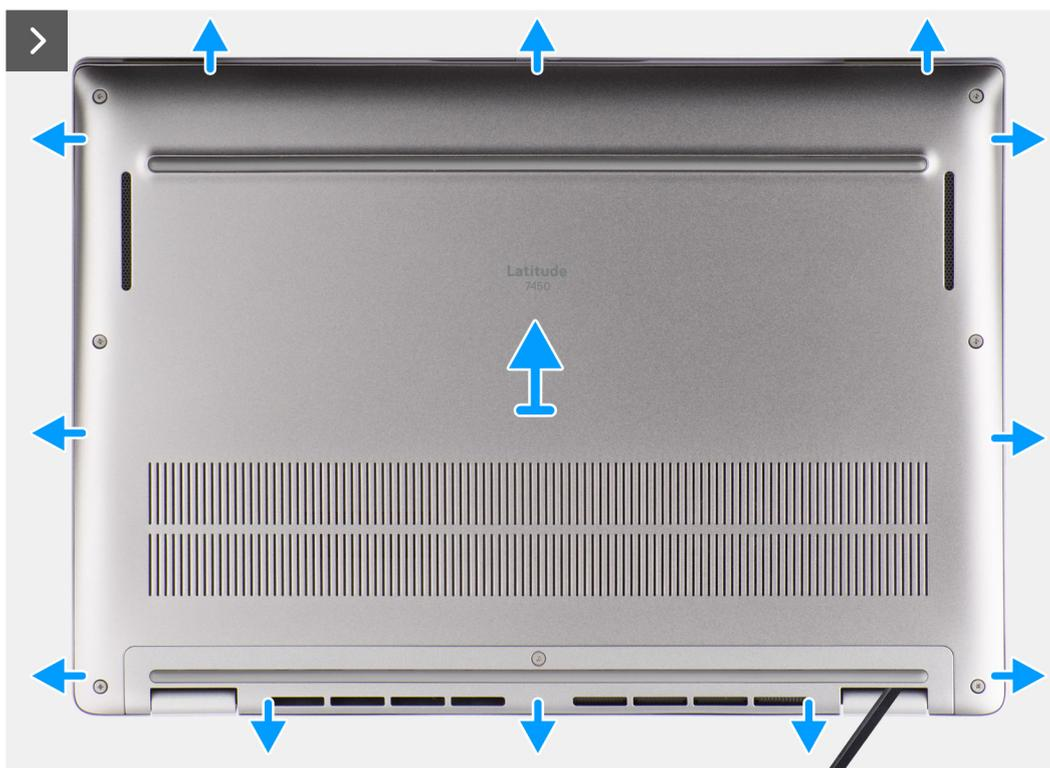
Figura 17. Rimozione del coperchio della base
