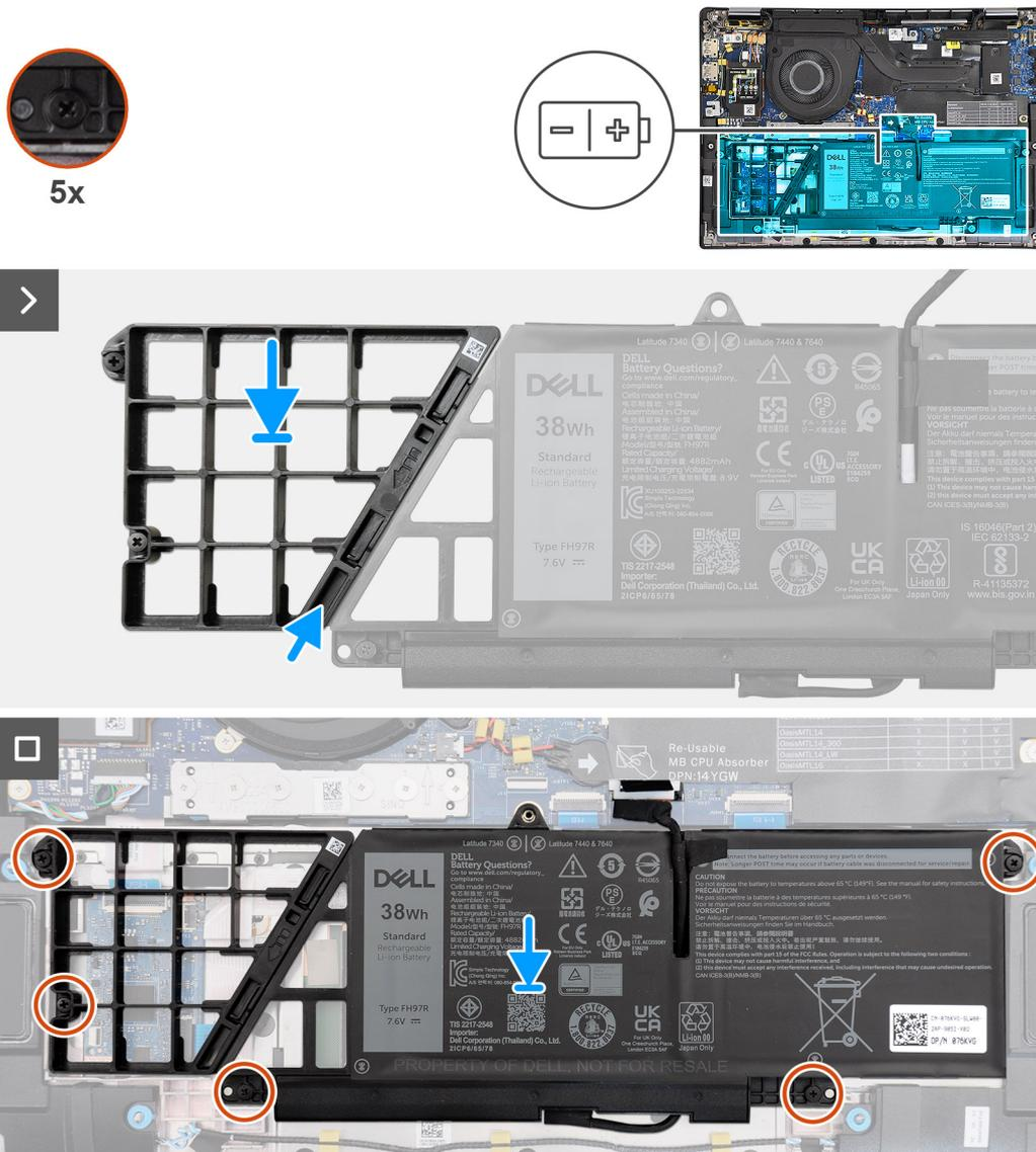
Figura 39. Installazione della batteria a 2 celle
