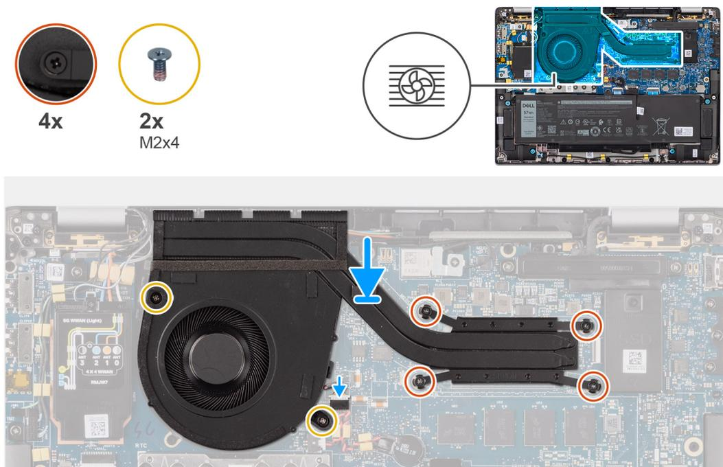
**Figura 47. Installazione del gruppo dissipatore di calore e ventola**
