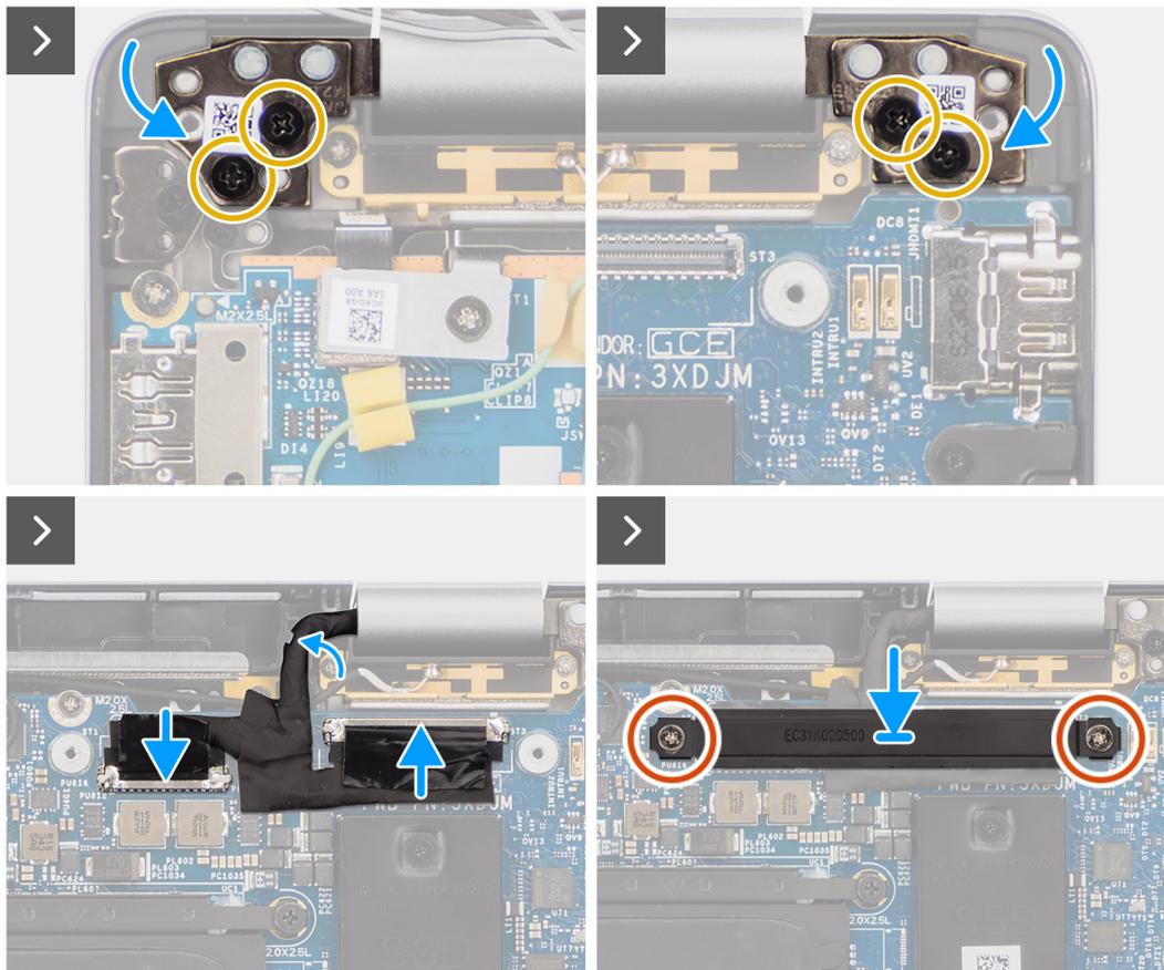
Figura 54. Installazione del gruppo del display
