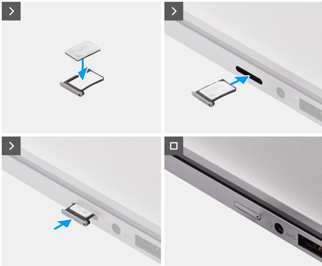
**Figura 15. Installazione del vassoio della scheda SIM**
