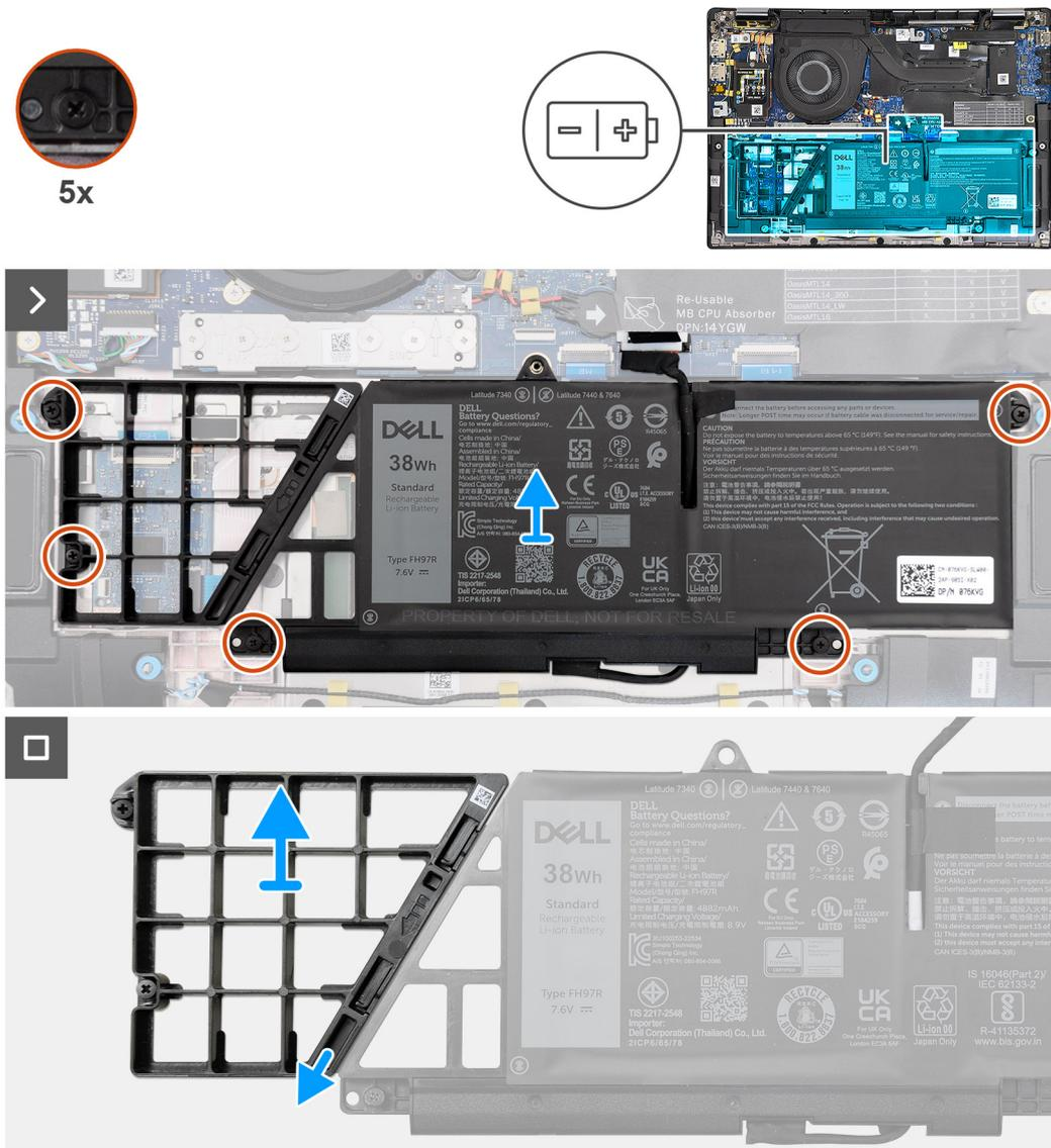
**Figura 37. Rimozione della batteria a 2 celle**
