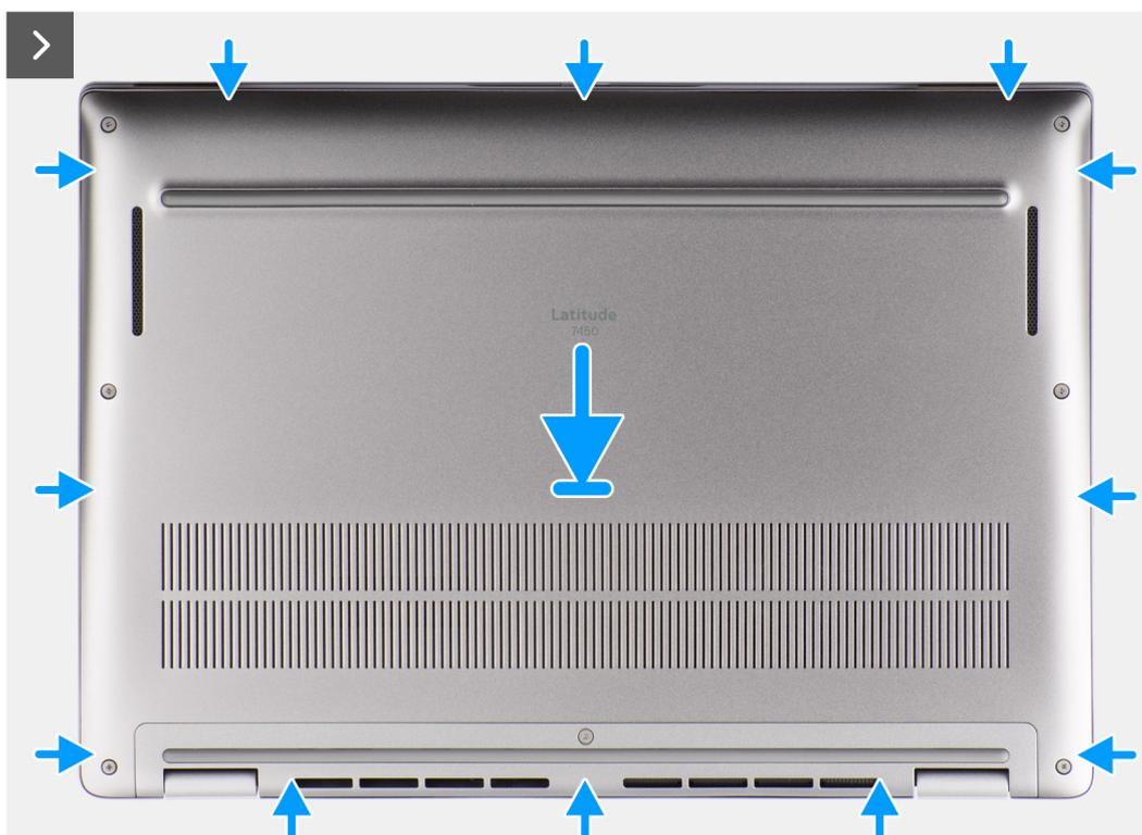
Figura 20. Installazione del coperchio della base
