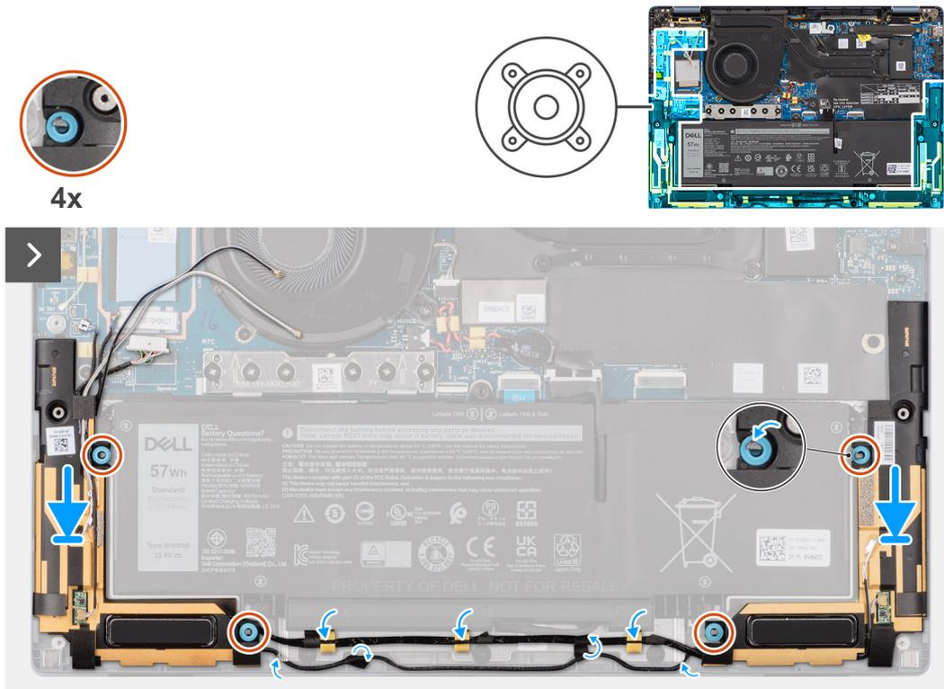
Figura 31. Installazione degli altoparlanti per ultralight
