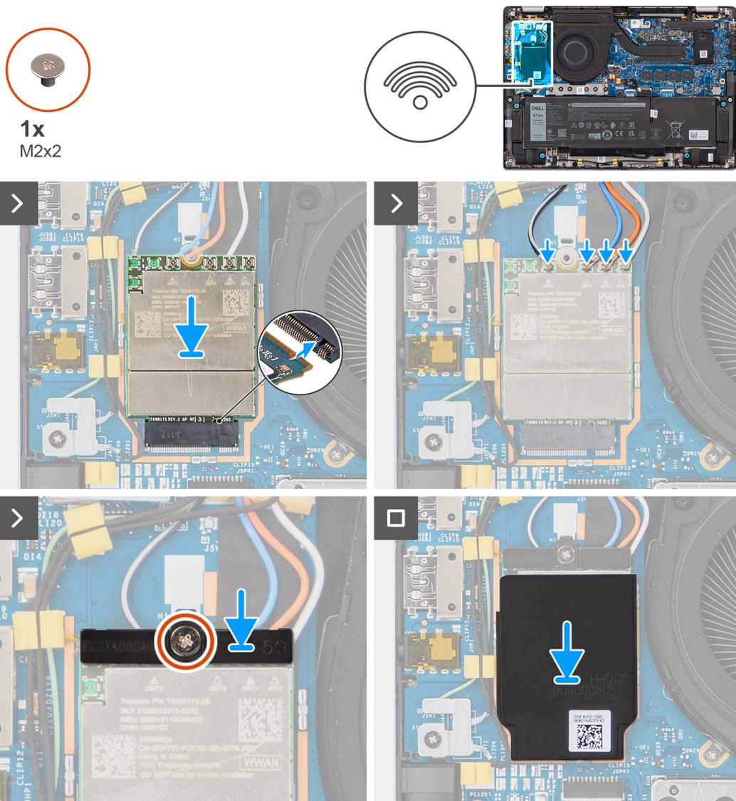
**Figura 27. Installazione della scheda WWAN 5G**
