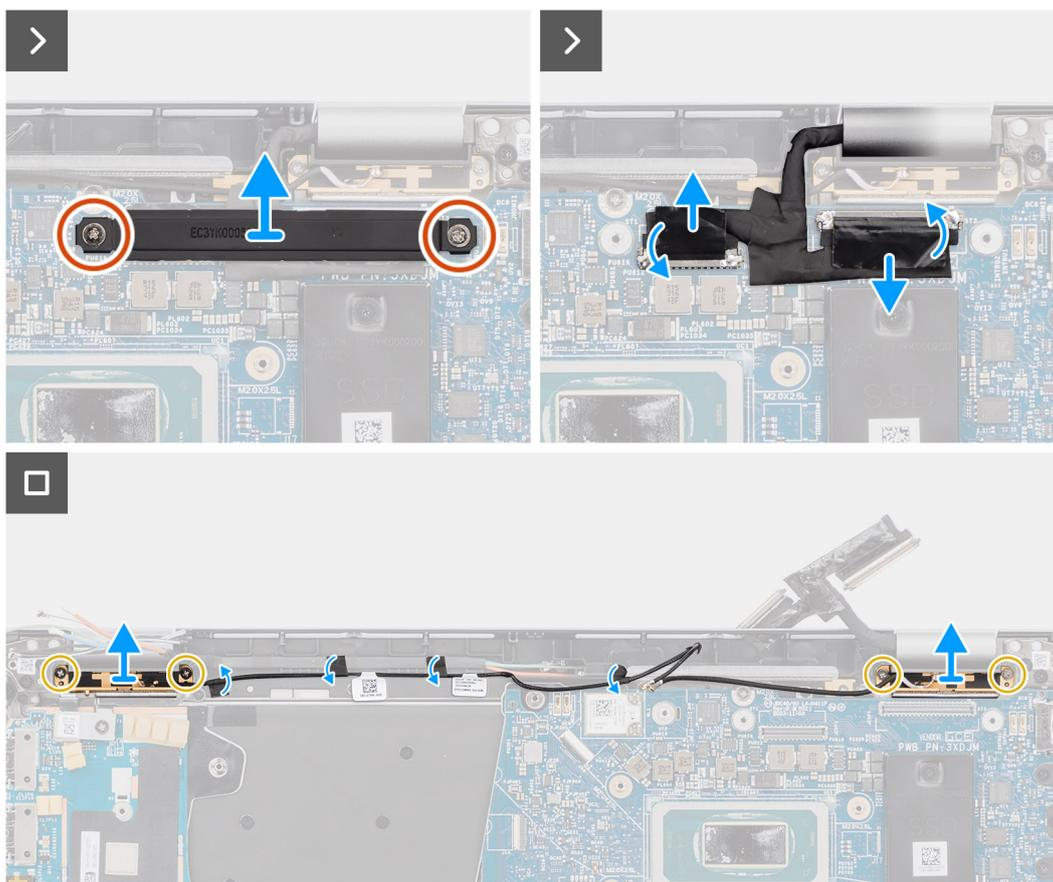
**Figura 67. Rimozione del modulo dell'antenna WLAN**
