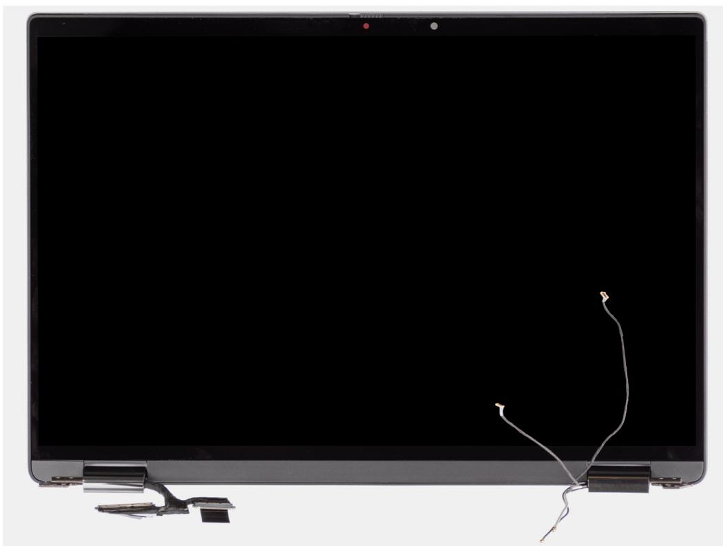
**Figura 51. Gruppo del display con cavi dell'antenna WWAN**
