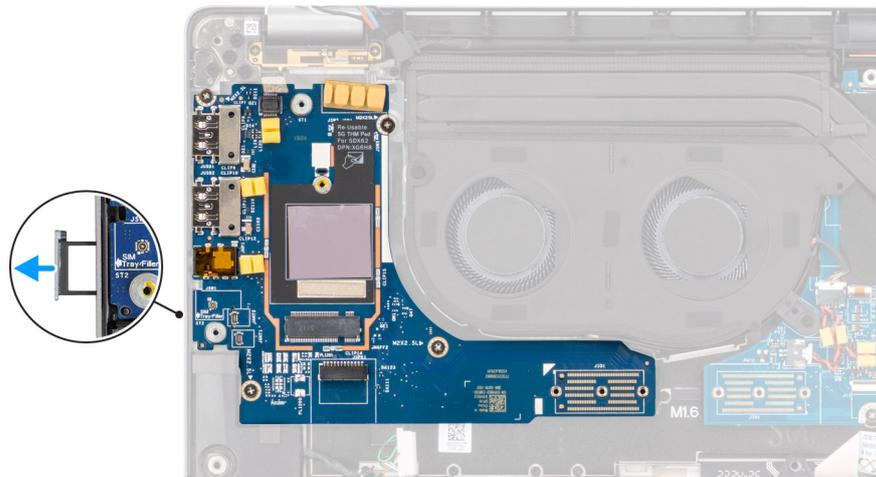
Figura 70. Rimozione della scheda figlia di I/O
