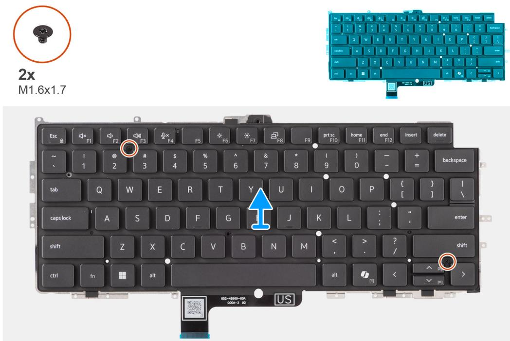
**Figura 79. Rimozione della tastiera**
