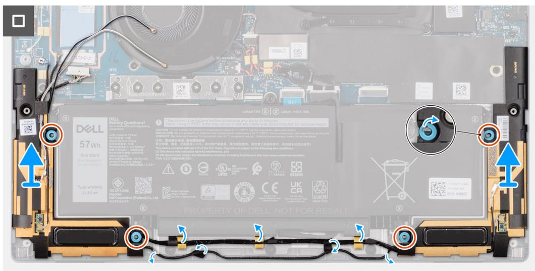
Figura 30. Rimozione degli altoparlanti per ultralight
