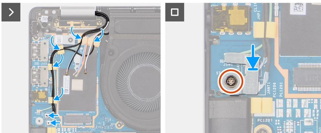
Figura 55. Installazione del gruppo del display
