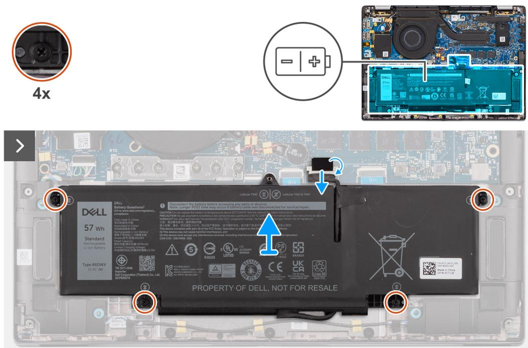
Figura 40. Rimozione della batteria a 3 celle
