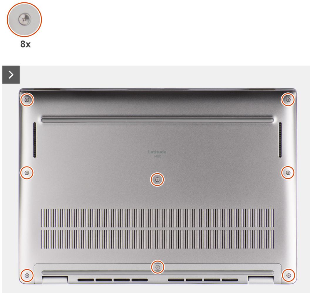
**Figura 16. Rimozione del coperchio della base**
