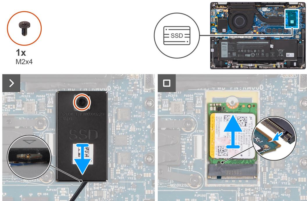
**Figura 22. Rimozione dell'unità SSD M.2 2230**
