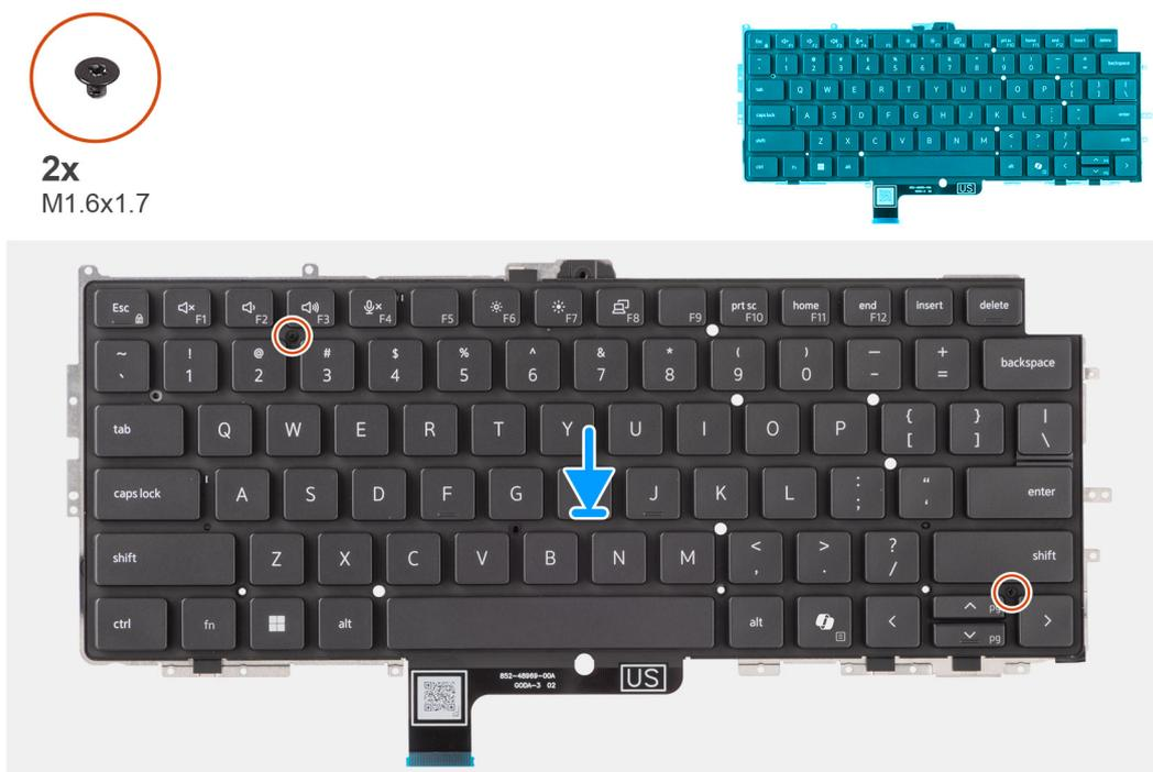
**Figura 82. Installazione della tastiera**
