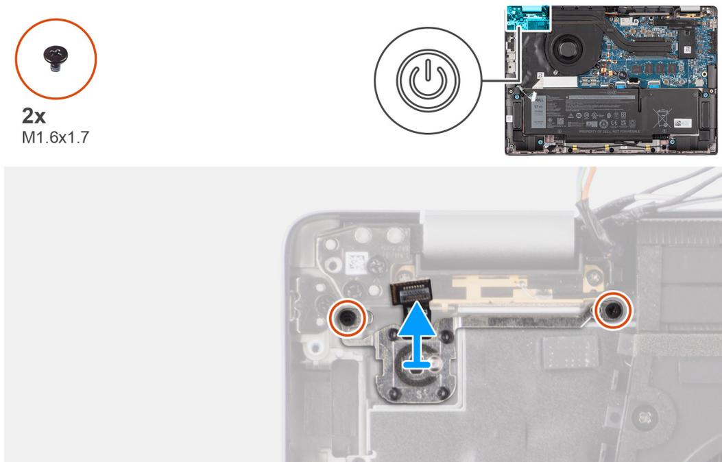
**Figura 76. Rimozione del pulsante di accensione con lettore di impronte digitali opzionale**
