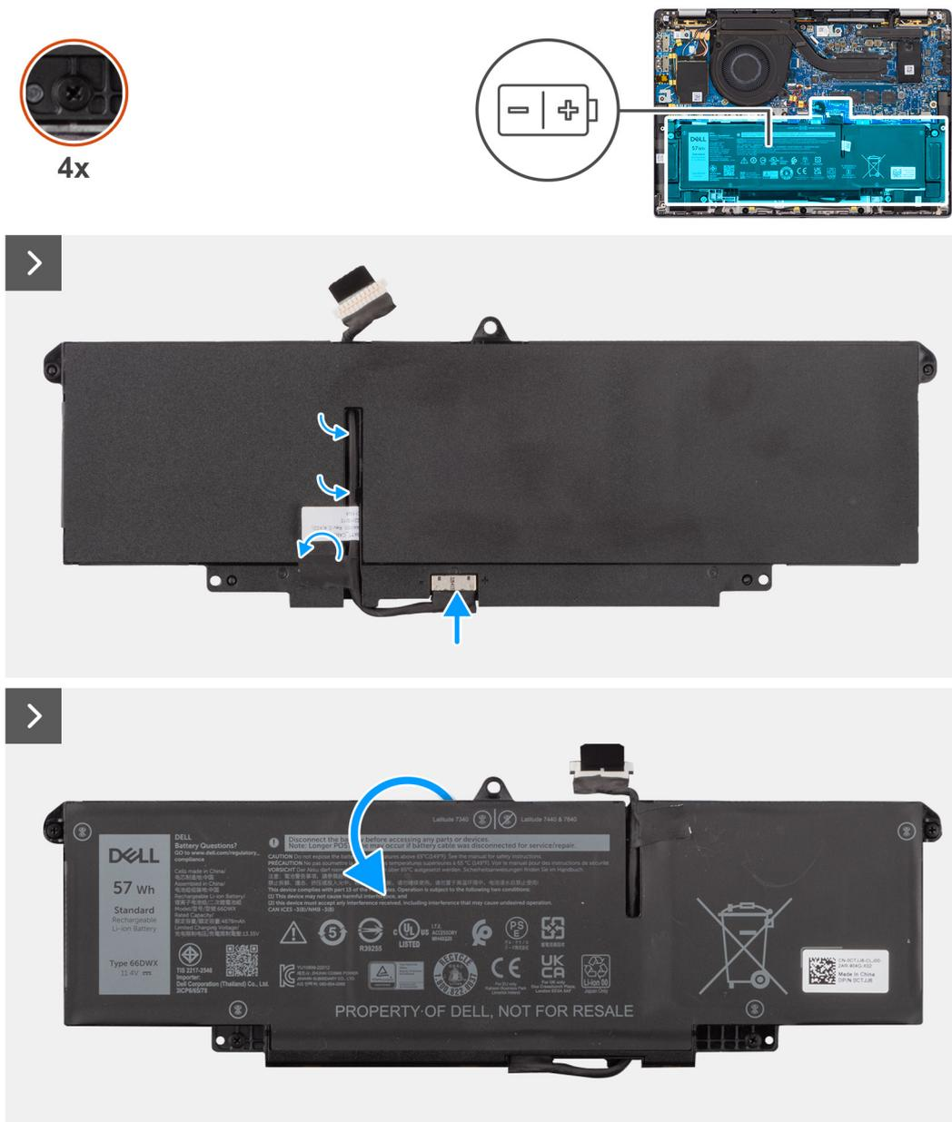
**Figura 45. Installazione del cavo della batteria**
