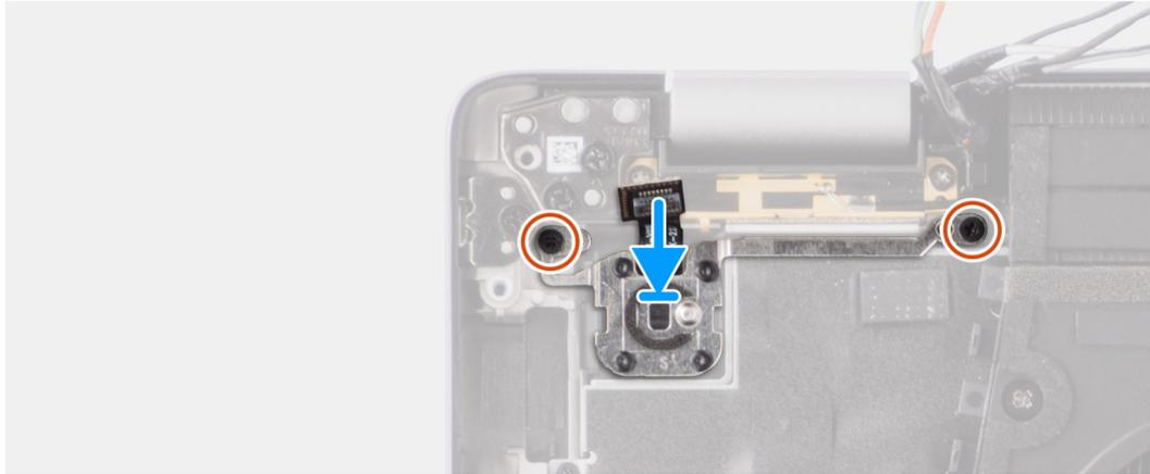
**Figura 77. Installazione del pulsante di accensione con lettore di impronte digitali opzionale**
