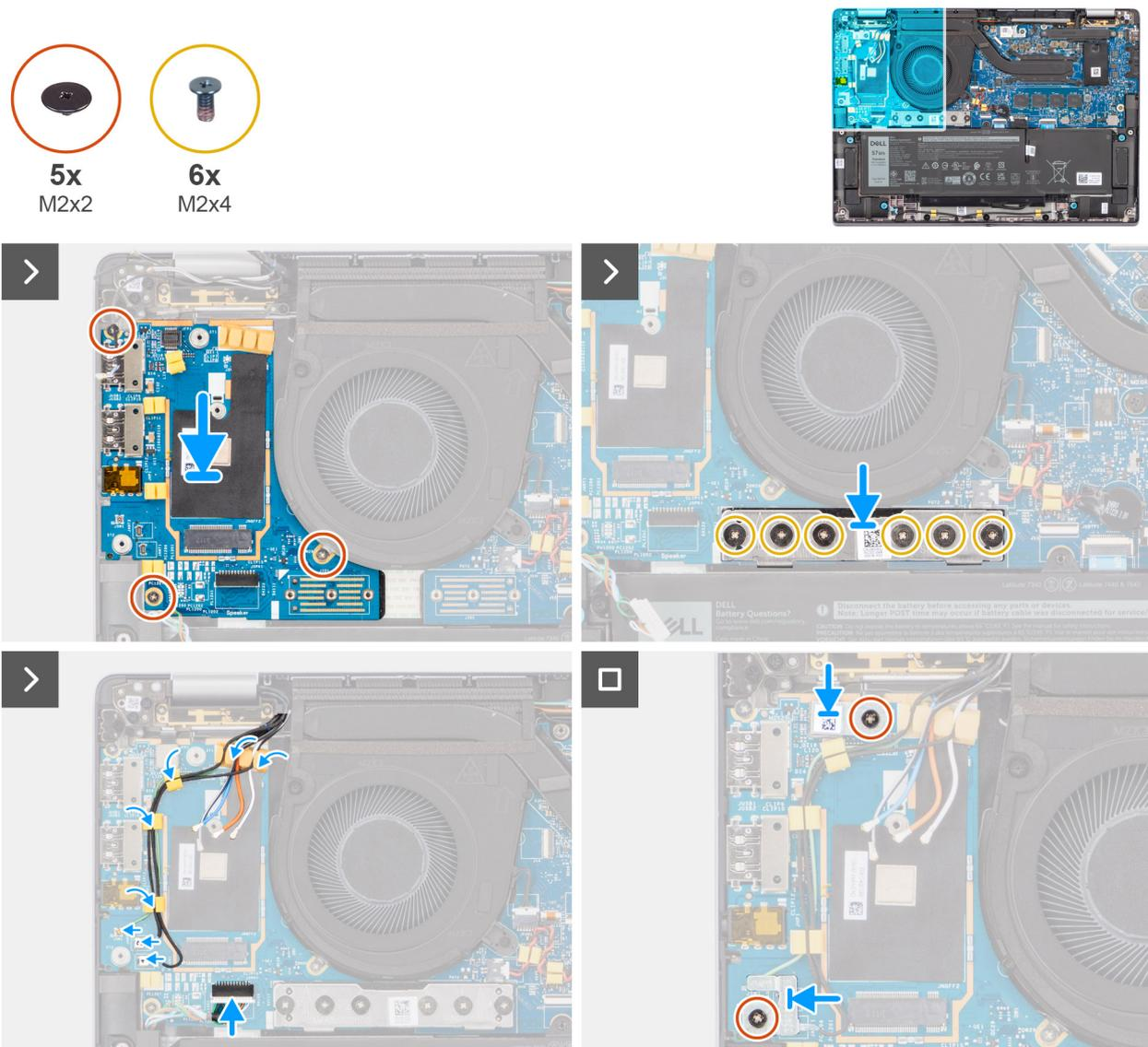
**Figura 75. Installazione della scheda figlia di I/O**
