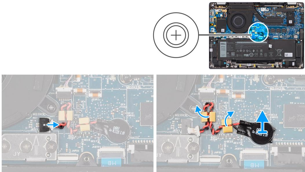
**Figura 35. Rimozione della batteria a bottone**
