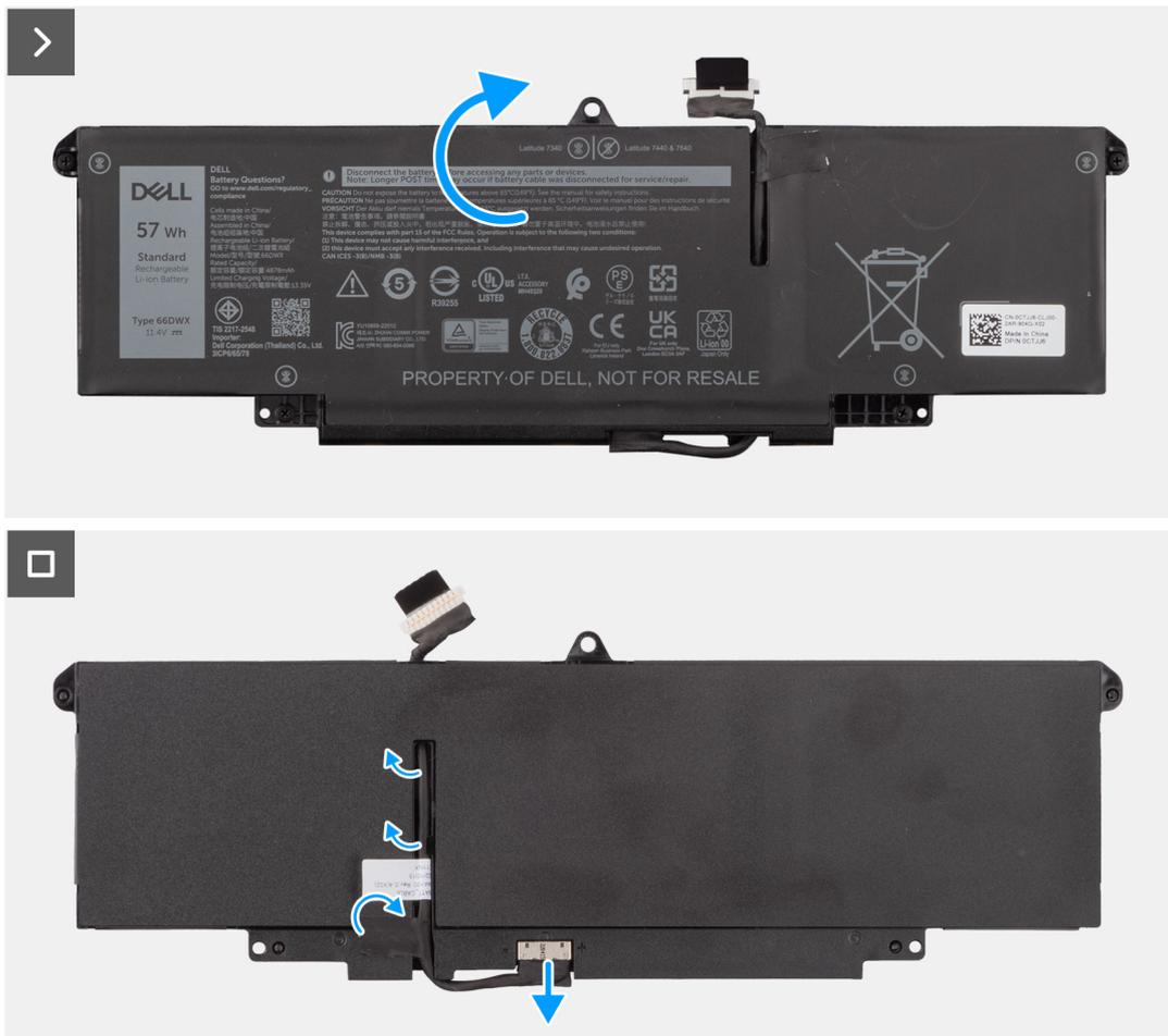
**Figura 41. Rimozione della batteria a 3 celle**
