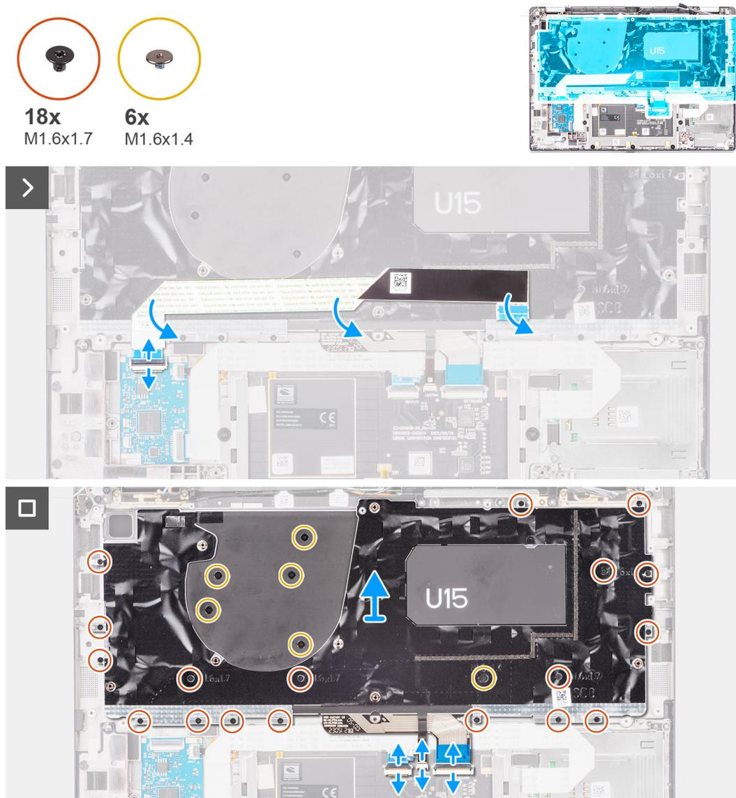
Figura 78. Rimozione della tastiera
