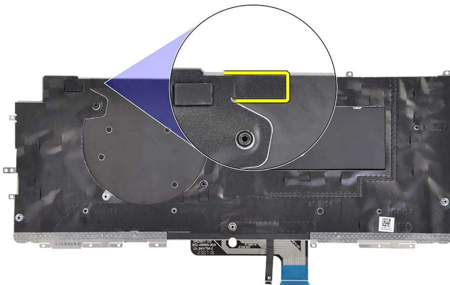
**Figura 83. Installazione del nastro Mylar della tastiera**
