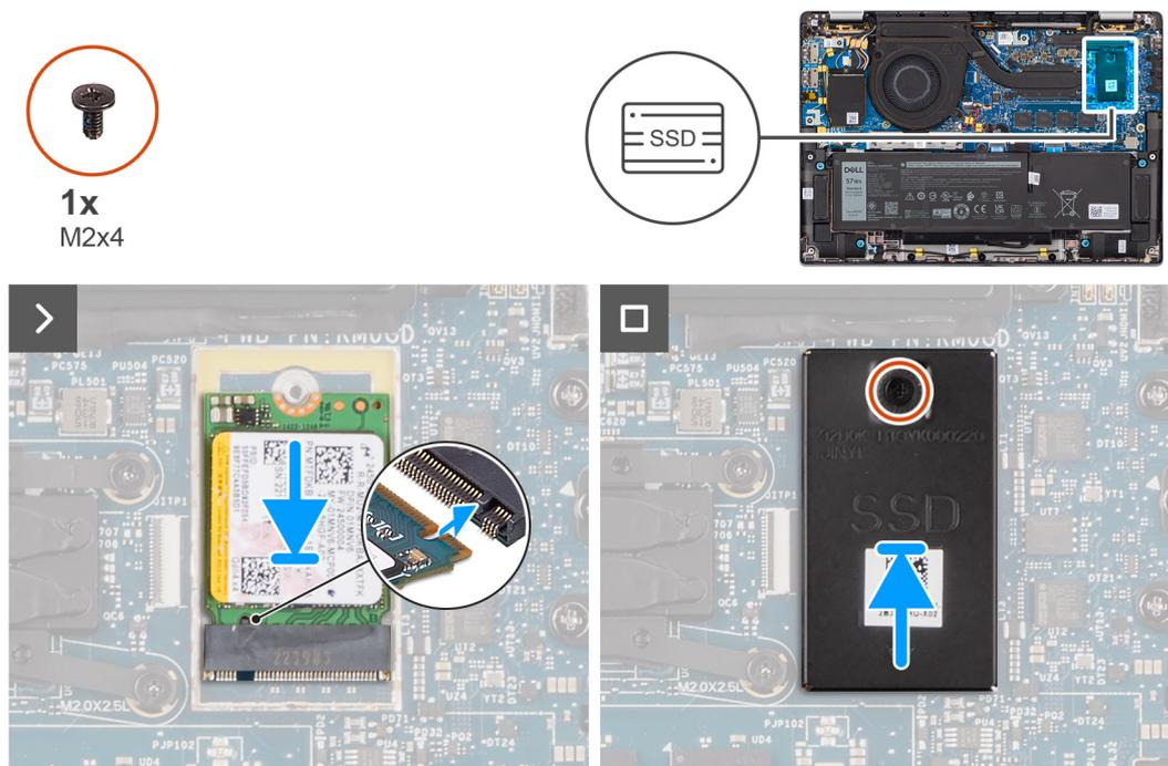
Figura 23. Installazione dell'unità SSD M.2 2230
