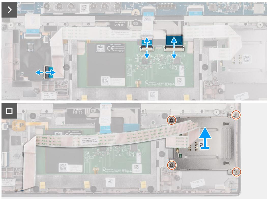
Figura 56. Rimozione del lettore di smart card
