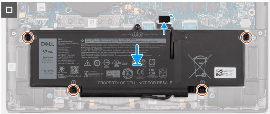
Figura 43. Installazione della batteria a 3 celle
