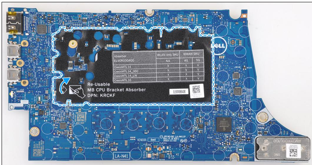
Figura 62. Ammortizzatore della staffa della CPU
