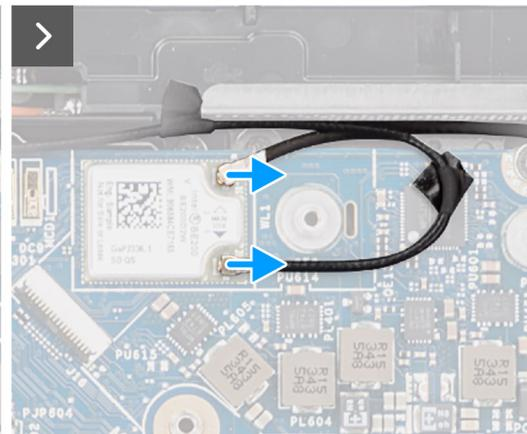
Figura 66. Rimozione del modulo dell'antenna WLAN
