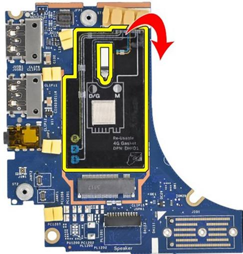
Figura 72. Configurazione Latitude 7450 Clamshell 4G WWAN (adesivo a guarnizione)
