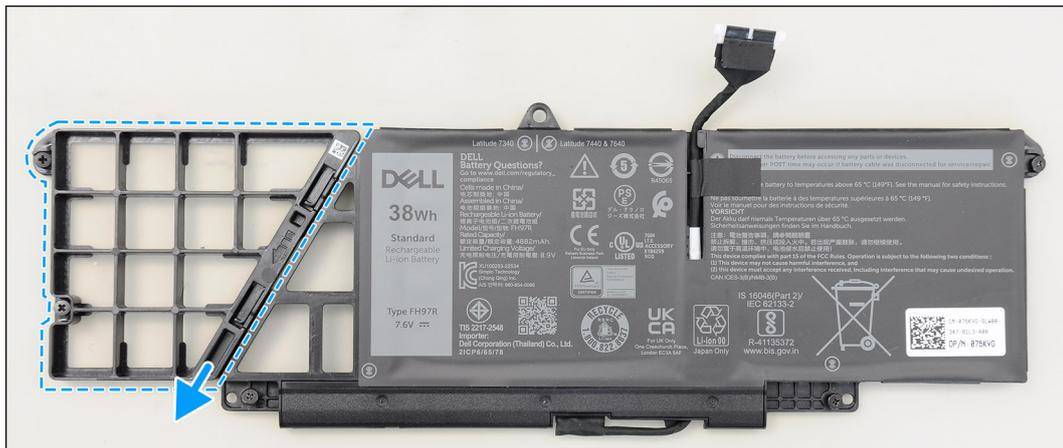
Figura 38. Rimozione della batteria a 2 celle
