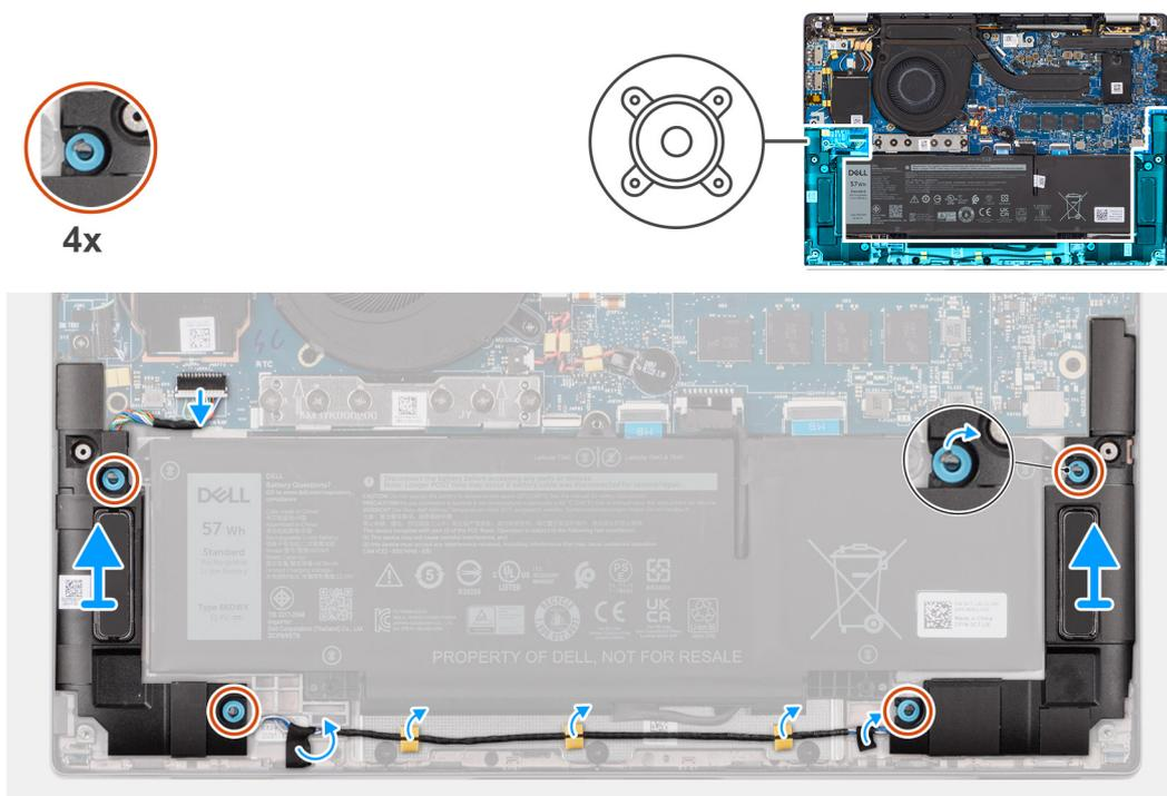
**Figura 33. Rimozione degli altoparlanti per sistemi classici**
