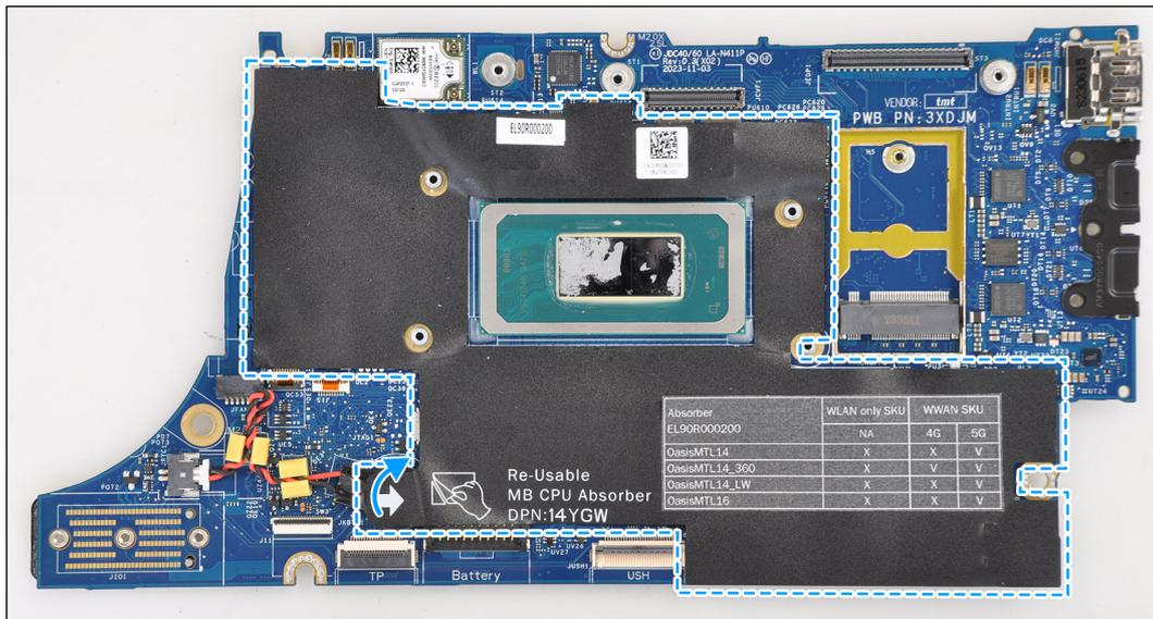
Figura 61. Ammortizzatore della CPU
