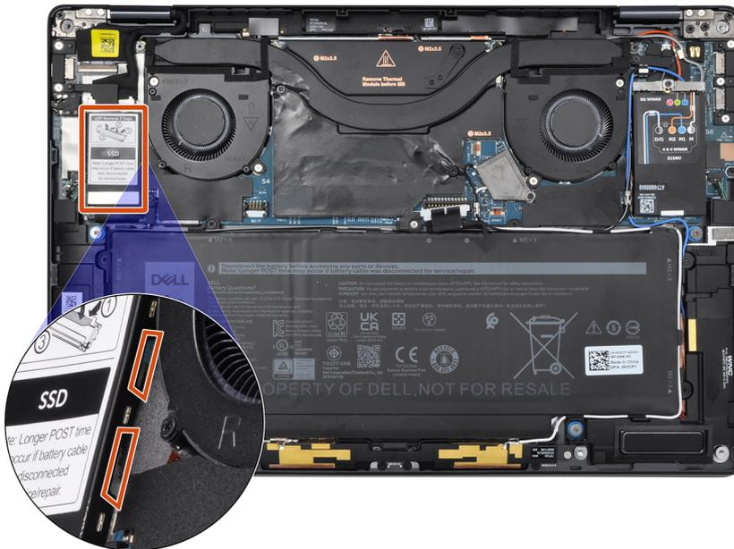
2. Rimuovere la vite (M1.2x1.5) singola che fissa l'unità SSD alla scheda di sistema.
