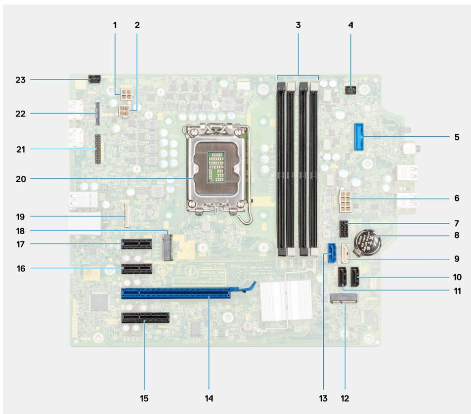
1. Connettore di alimentazione CPU ATX
