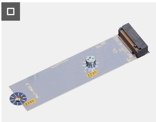
La figura indica la posizione delle unità SSD M.2230 e fornisce una rappresentazione visiva della procedura di installazione.
