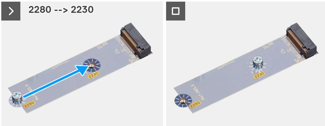
La figura indica la posizione delle unità SSD M.2 2230 e fornisce una rappresentazione visiva della procedura di installazione.
