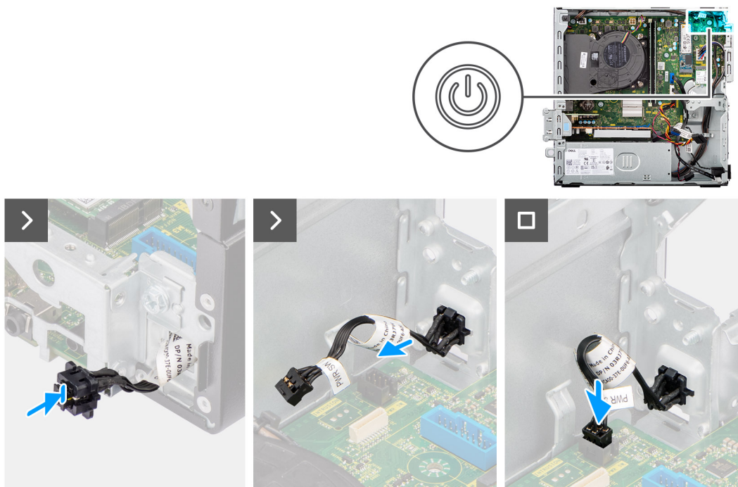
Figura 36. Installazione del pulsante di accensione
