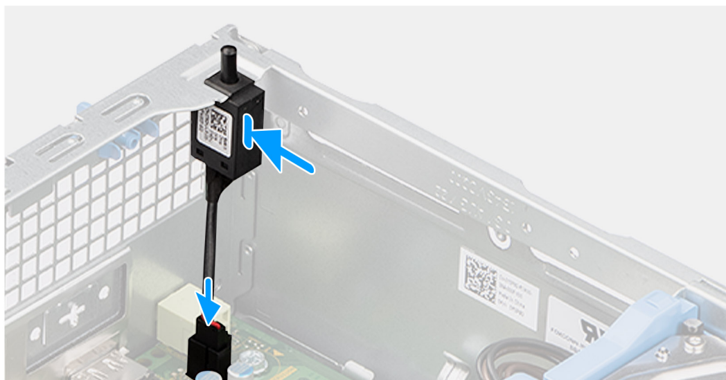
Figura 34. Installazione dello switch antintrusione
