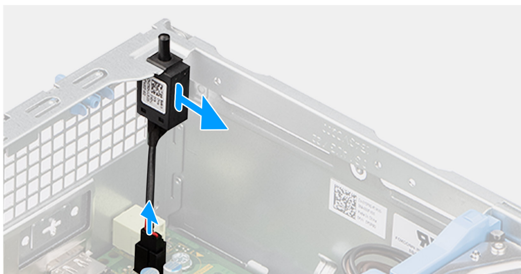
Figura 33. Rimozione dell'interruttore di intrusione
