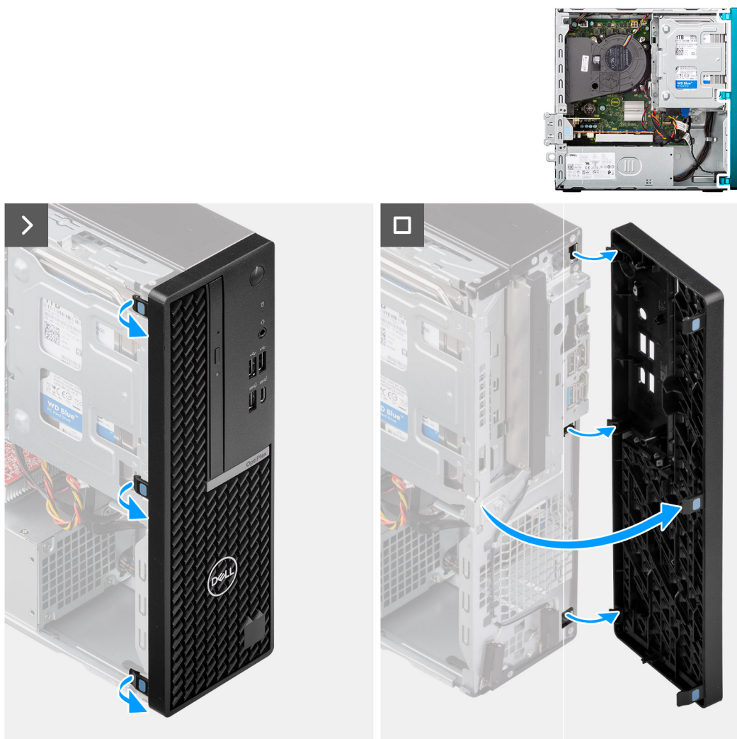
Figura 7. Rimozione del pannello anteriore
