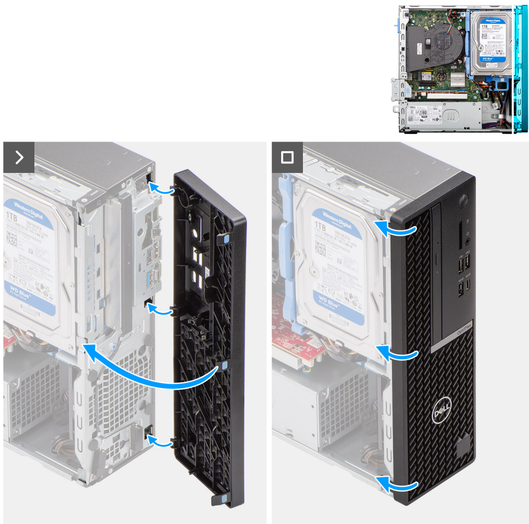
Figura 8. Installazione del pannello anteriore
