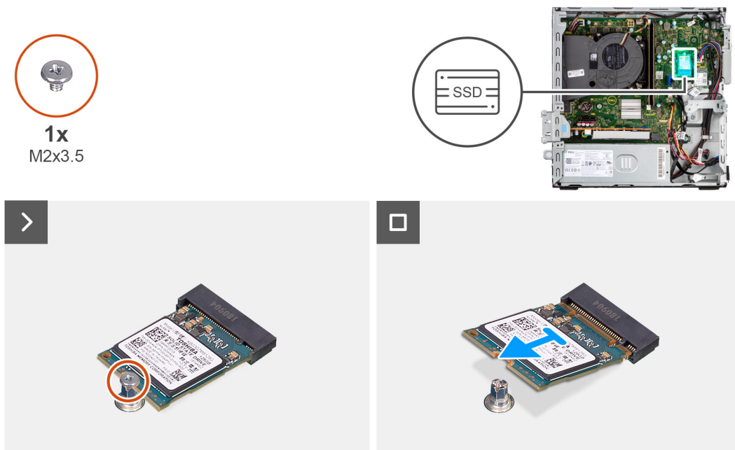
Figura 17. Rimozione dell'unità SSD M.2 2230
