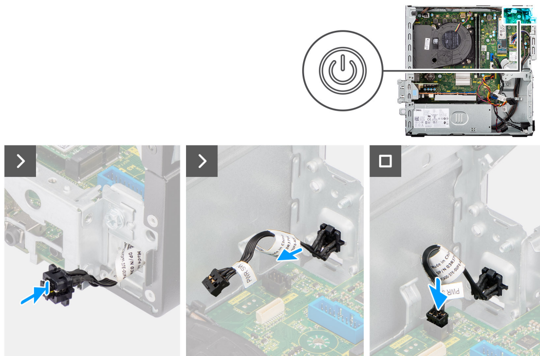
Figura 36. Installazione del pulsante di accensione
