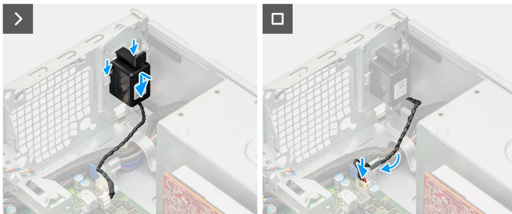
Figura 36. Installazione dell'altoparlante
