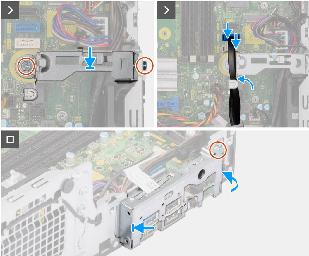
**Figura 73. Installazione della scheda di sistema**
