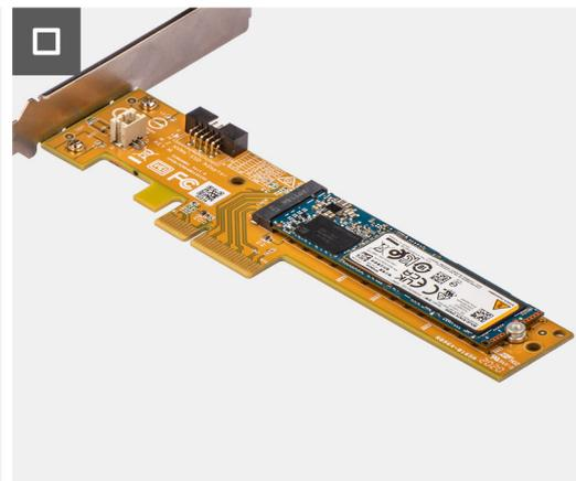
Figura 27. Installazione dell'unità SSD M.2 2280 sulla scheda Dell Ultra Speed Drive Gen3
