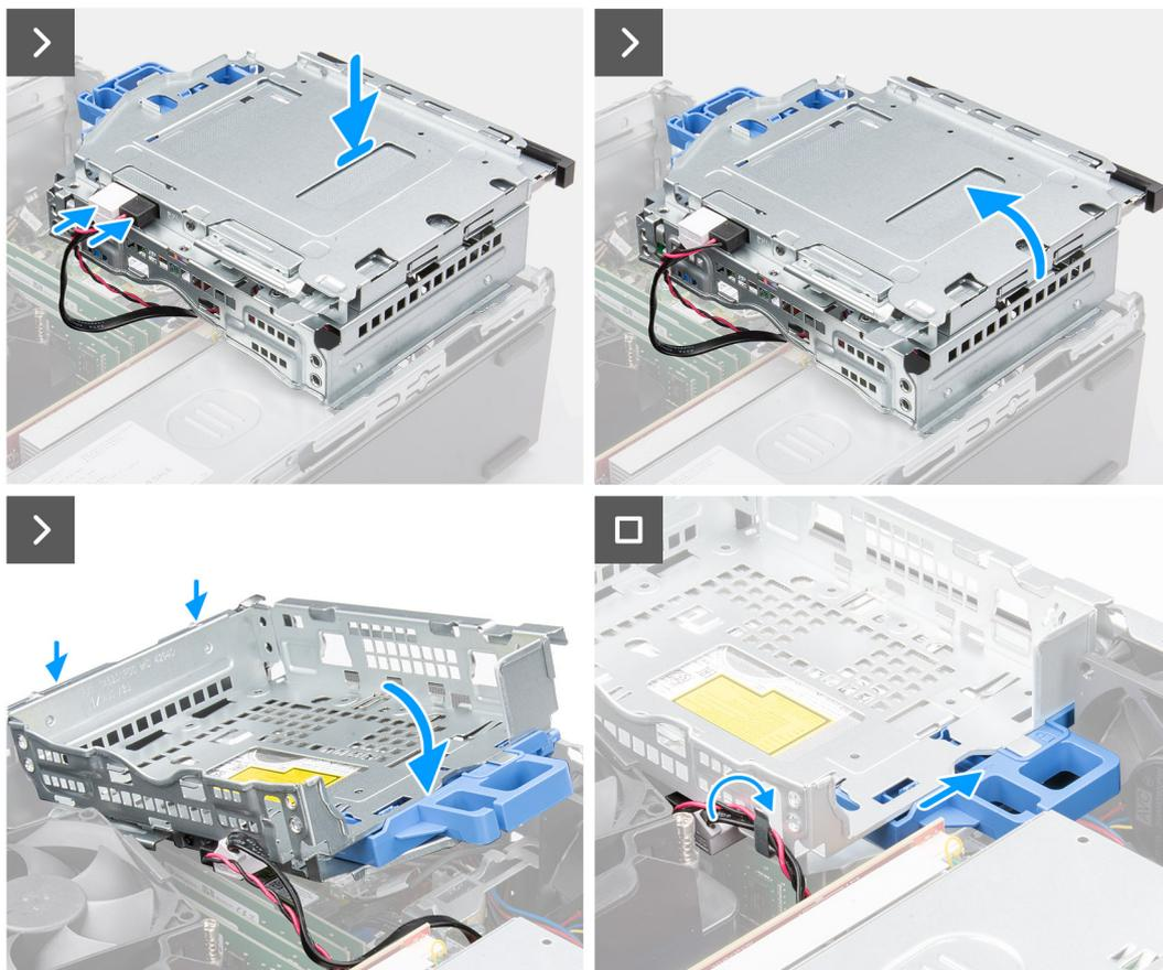
**Figura 12. Installazione della gabbia del disco rigido**
