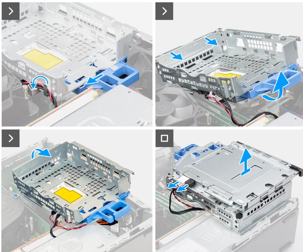
**Figura 11. Rimozione della gabbia del disco rigido**
