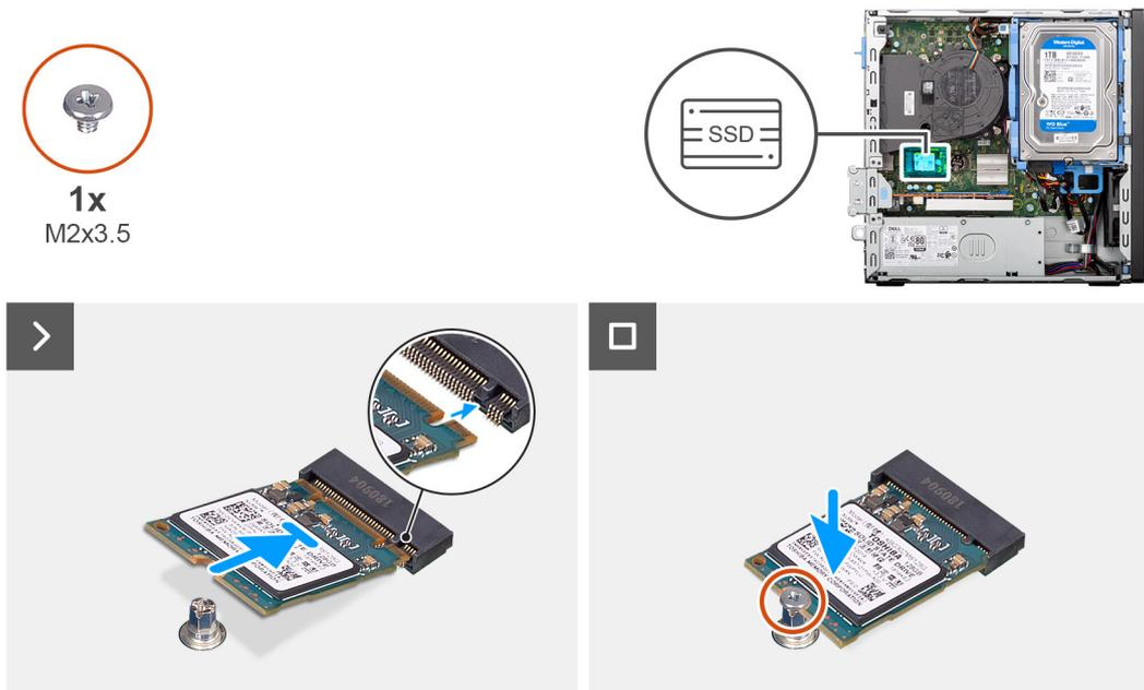
**Figura 18. Installazione dell'unità SSD M.2 2230 nello slot 0**
