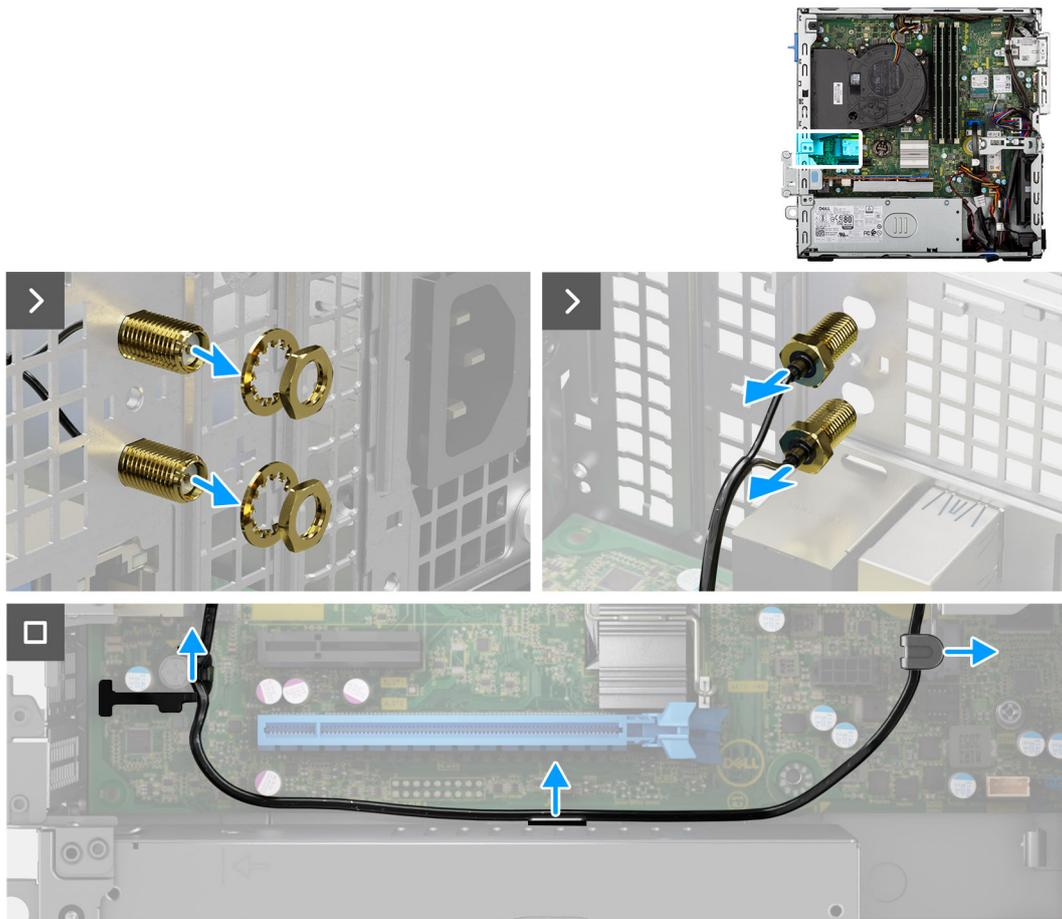
**Figura 46. Rimozione del modulo antenna SMA esterna**
