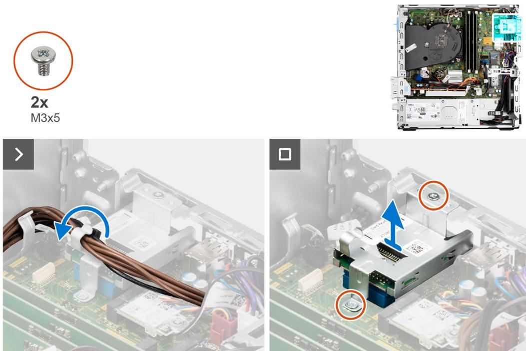
Figura 31. Rimozione del lettore di schede multimediali
