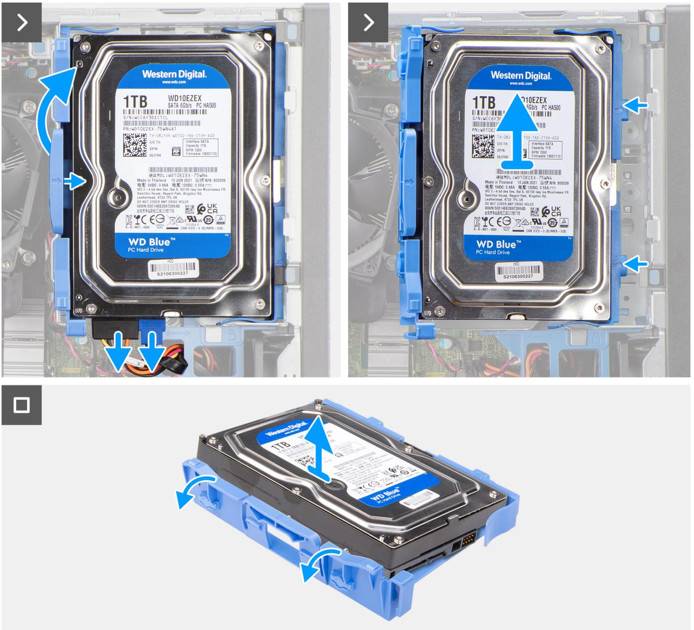
**Figura 9. Rimozione del disco rigido da 3,5 pollici**
