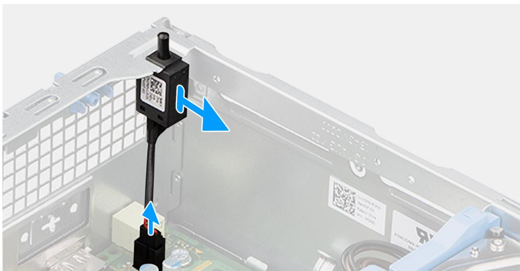
**Figura 37. Rimozione dell'interruttore di intrusione**
