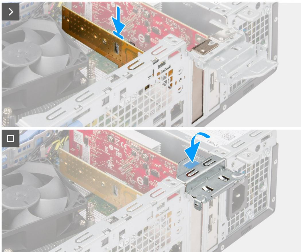
**Figura 28. Installazione della scheda Dell Ultra Speed Drive Gen3**
