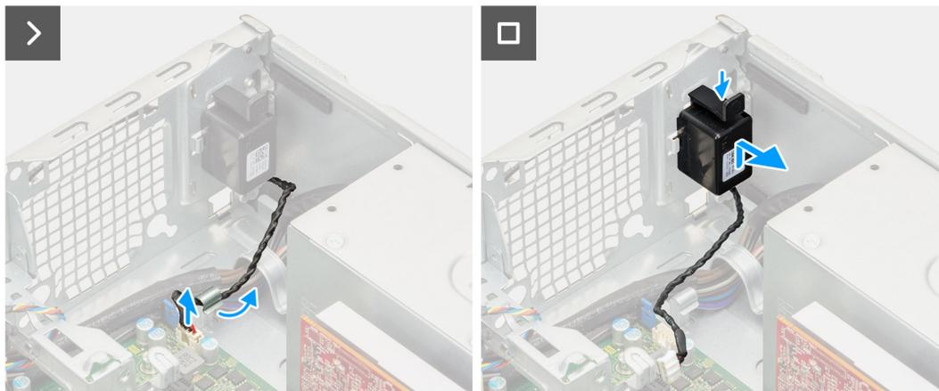
Figura 35. Rimozione degli altoparlanti
