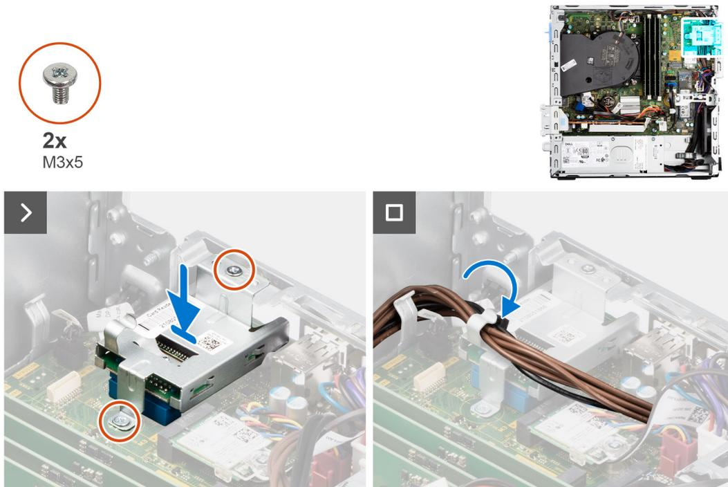
**Figura 32. Installazione del lettore di schede multimediali**
