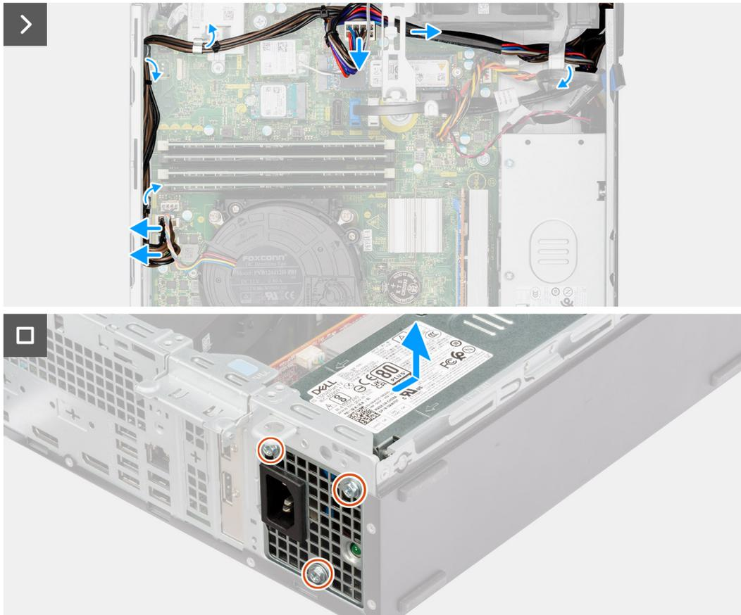
Figura 48. Rimozione dell'unità di alimentazione
