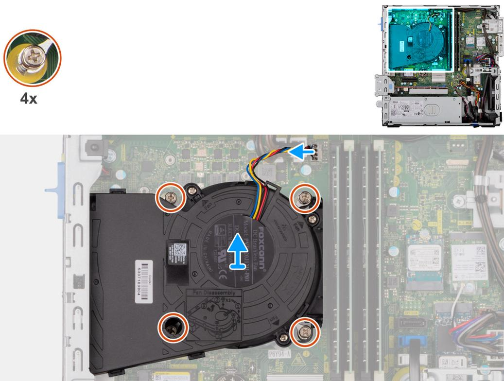
Figura 50. Rimozione del gruppo ventola del processore e dissipatore di calore
