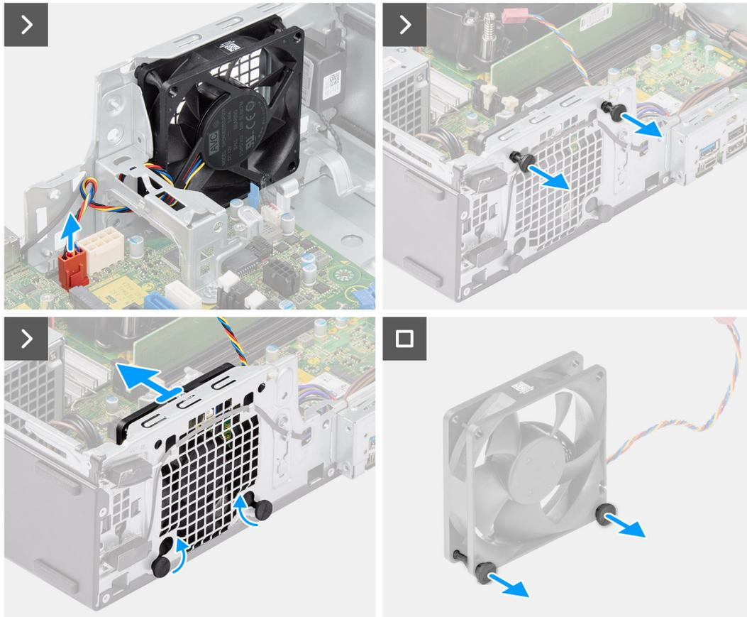
**Figura 41. Rimozione della ventola di sistema**
