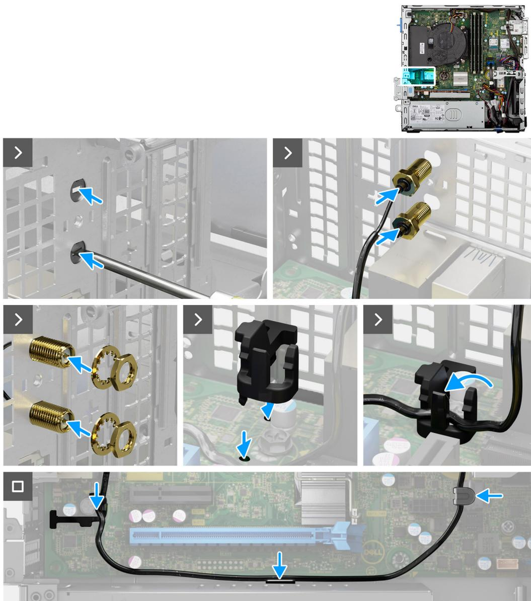
**Figura 47. Installazione del modulo dell'antenna SMA esterna**
