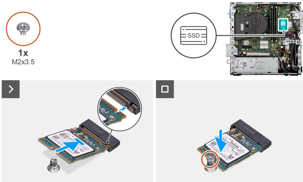
**Figura 20. Installazione delle unità SSD M.2 2230 nello slot 1**
