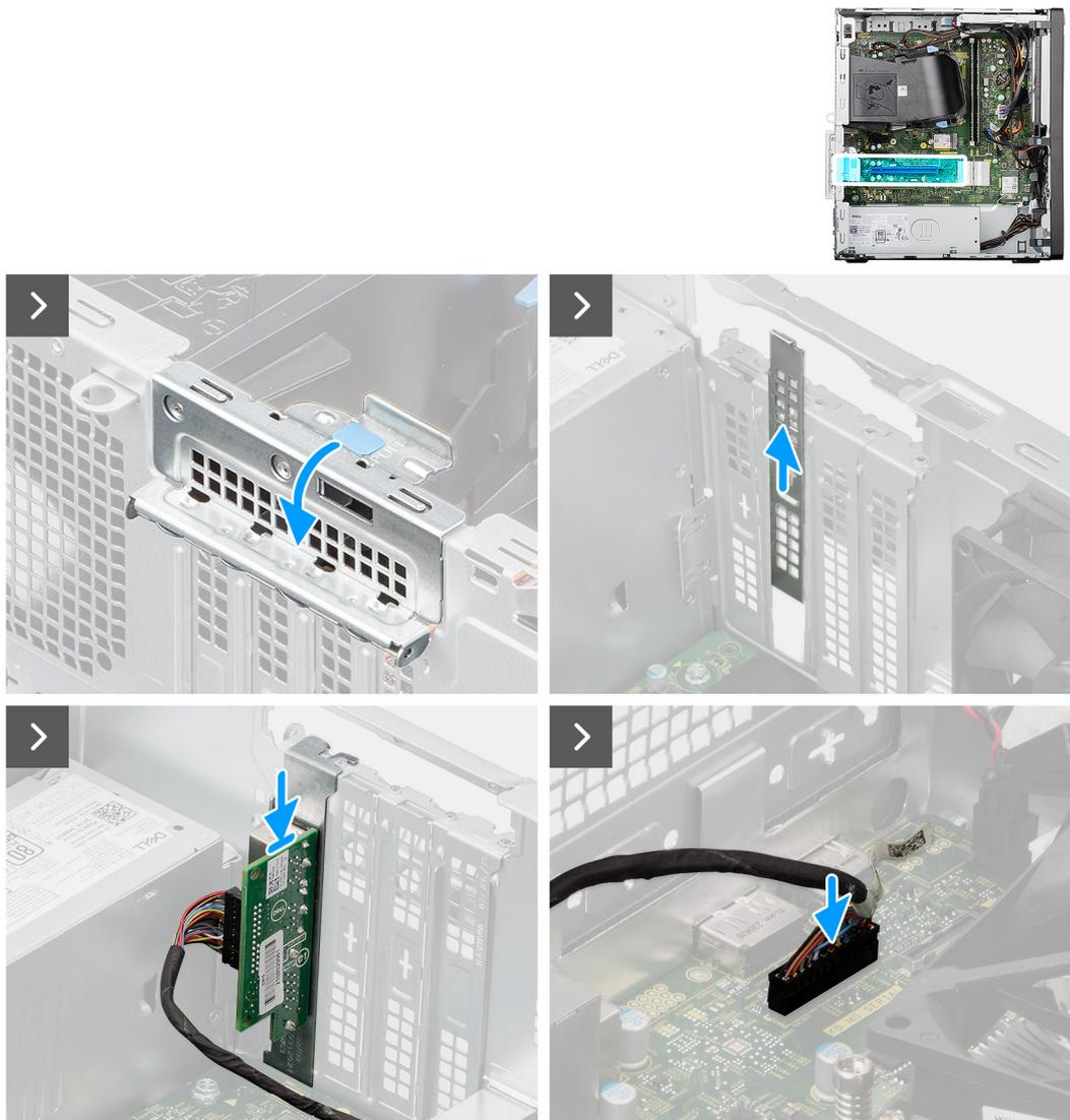
Figura 74. Installazione del modulo seriale e PS2 opzionale
