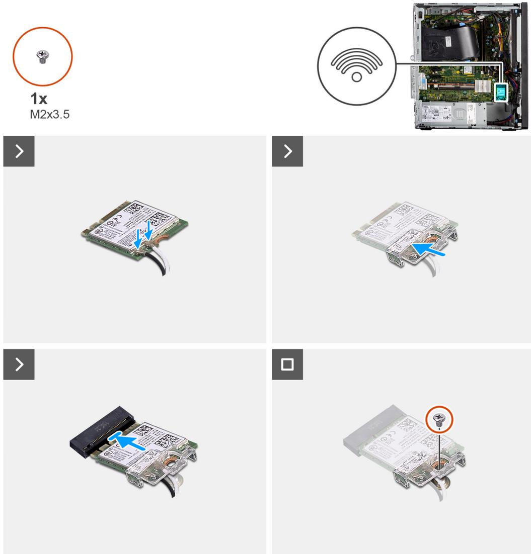
Figura 32. Installazione della scheda wireless
