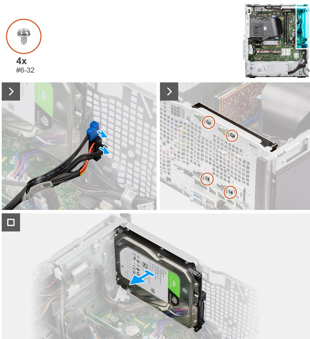
Figura 35. Rimozione del disco rigido da 3,5 pollici
