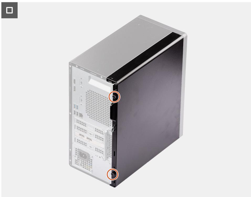
Figura 12. Installazione del coperchio laterale
