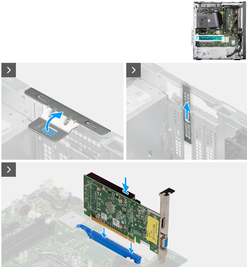
Figura 45. Installazione della scheda delle porte seriali/parallele
