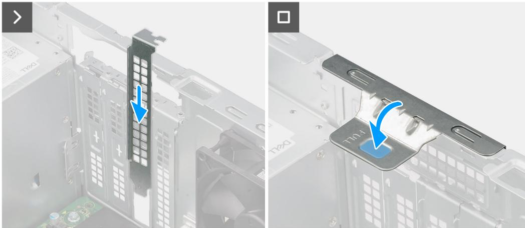
**Figura 57. Rimozione del modulo dell'antenna SMA esterna**
