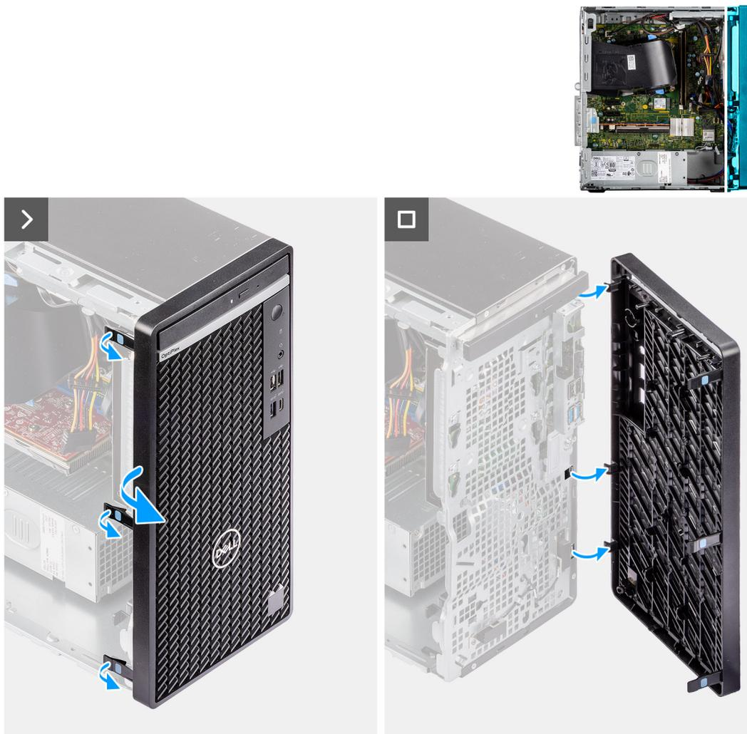
**Figura 15. Rimozione del pannello anteriore**
