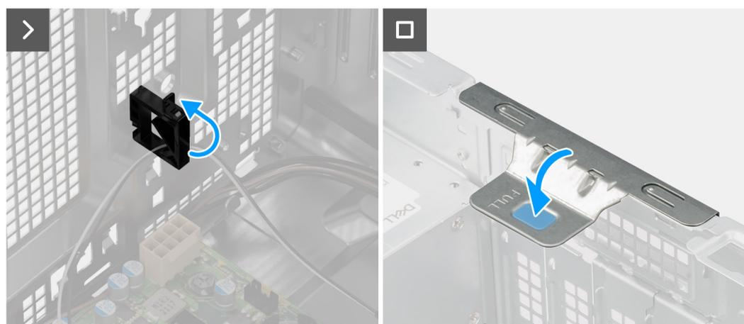
Figura 59. Installazione del modulo dell'antenna SMA esterna
