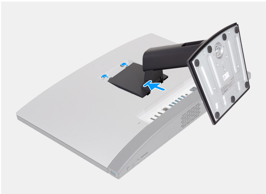
Figura 21. Installazione del supporto fisso
