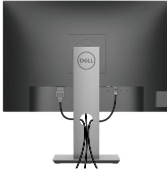
Dopo aver fissato tutti i cavi al monitor e al computer, (Si veda [Connessione del monitor](#) per i collegamenti dei cavi), usare il passacavi per organizzare i cavi in maniera ordinata, come mostrato sopra.
