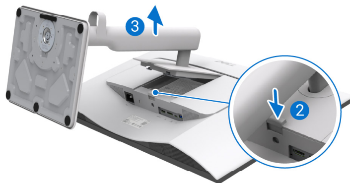
Figura 27. Rimuovere il supporto del monitor
