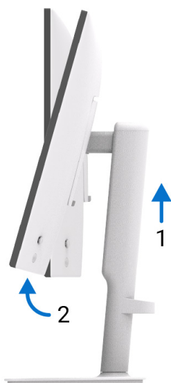
Figura 31. Regolazione della rotazione sul punto centrale
