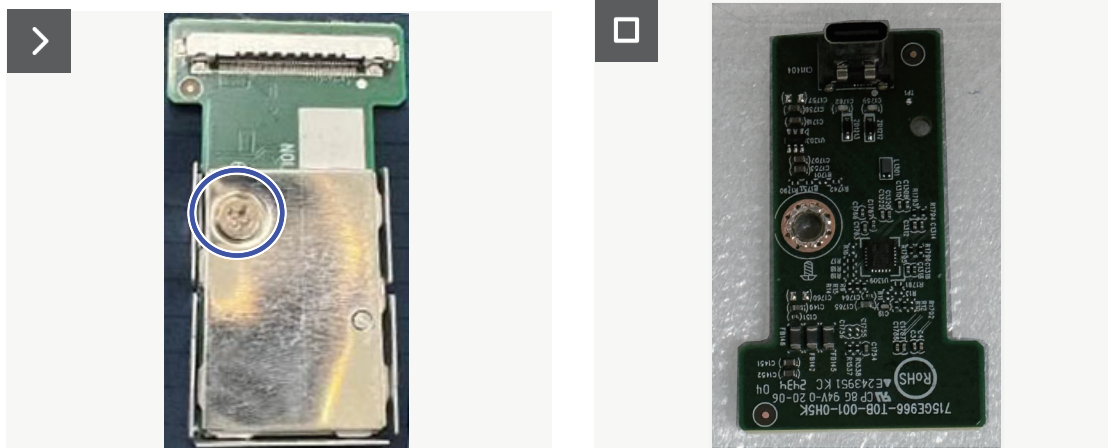
Figura 39. Rimozione della scheda USB
