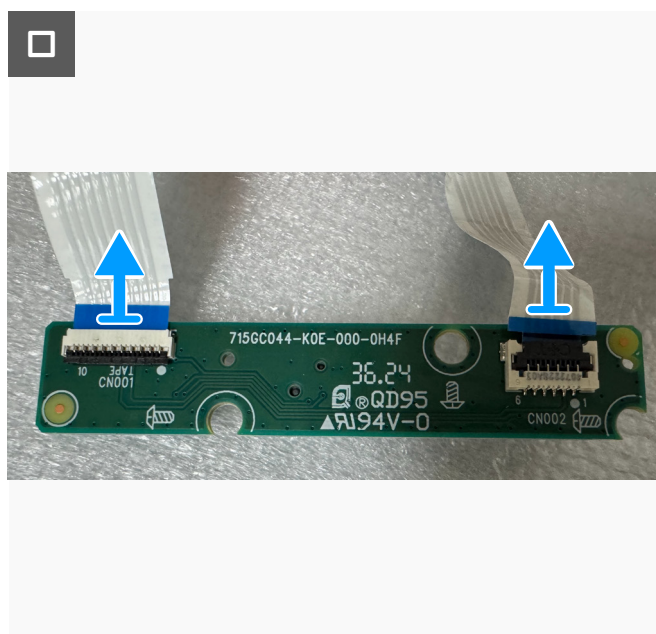
Figura 41. Rimozione della scheda del tastierino e scollegamento dei cavi
