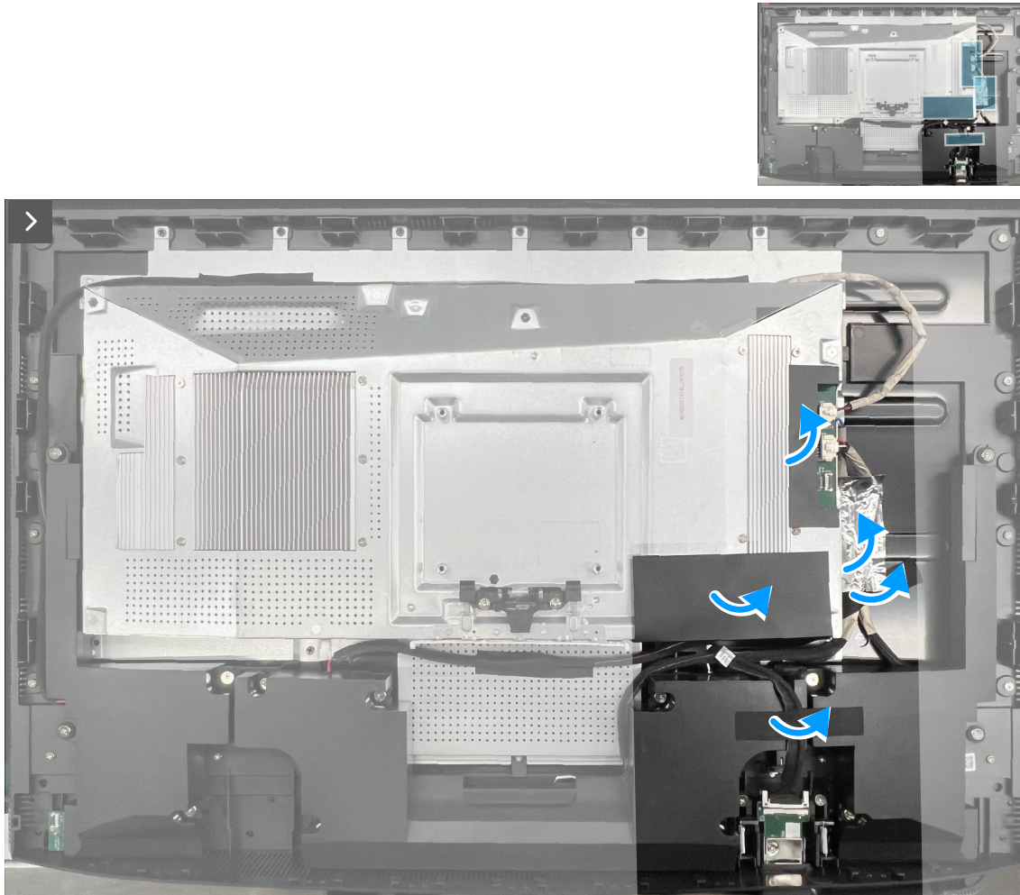
Figura 19. Staccare i nastri che fissano i cavi e il mylar
