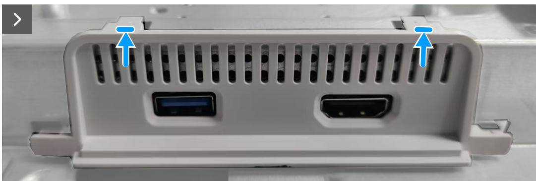
Figura 33. Riposizionamento del coperchio I/O della schermatura metallica
