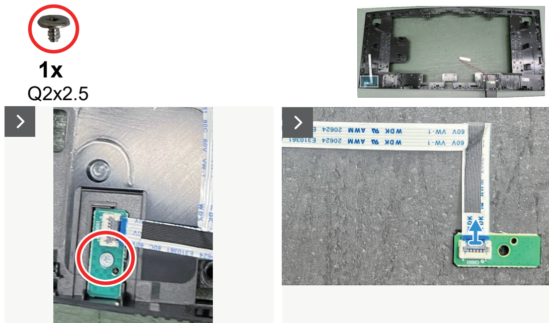
Figura 37. Rimozione della scheda Lens
