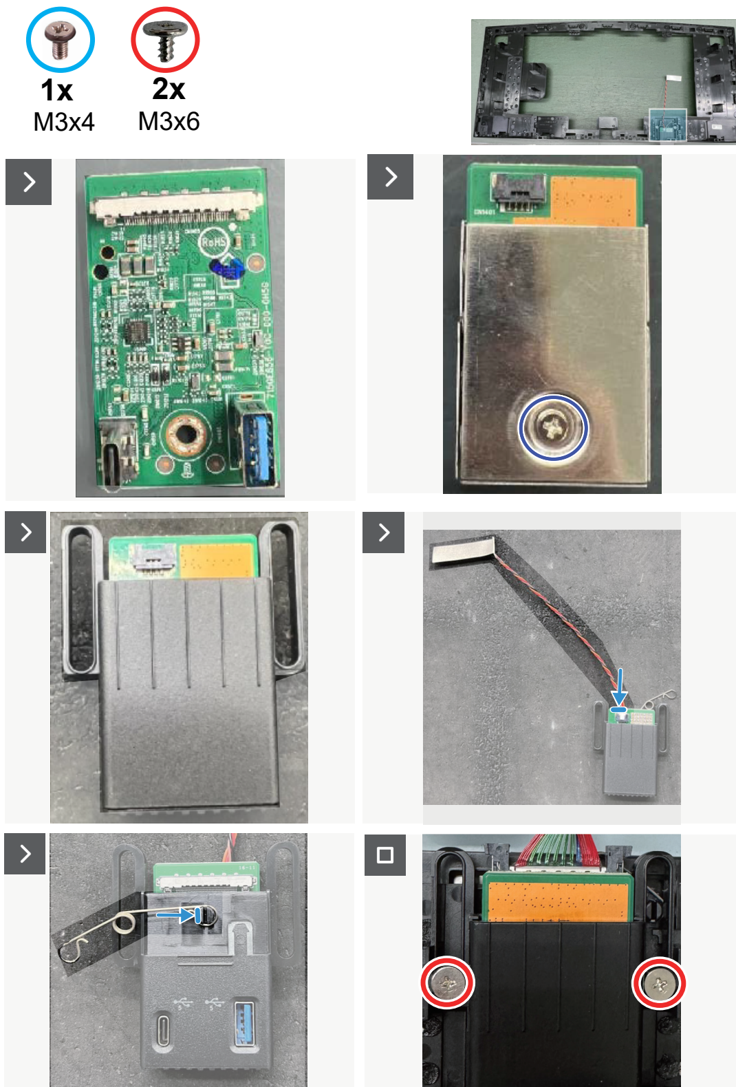
Figura 40. Installazione della scheda USB
