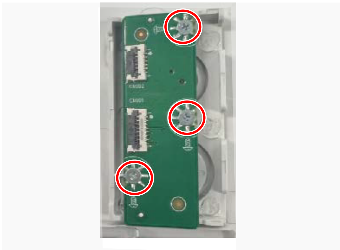
Figura 42. Installazione della scheda del tastierino
