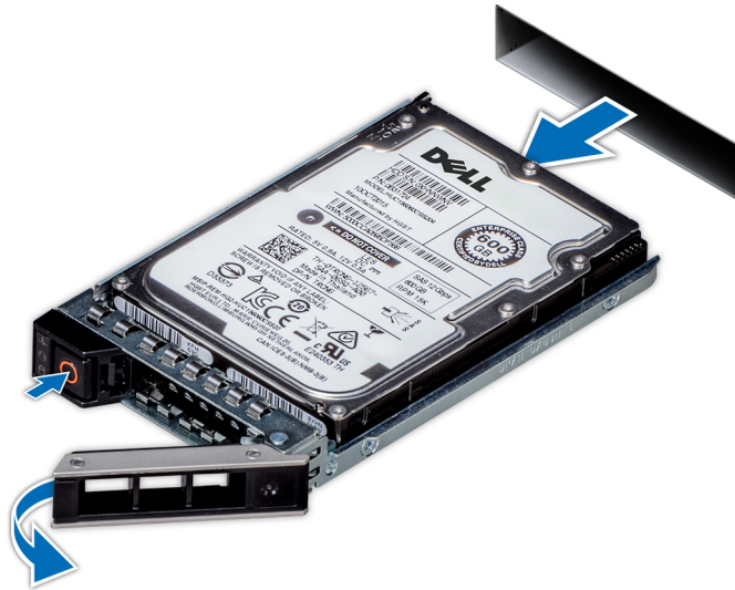
Figura 65. Rimozione dell'alloggiamento di un'unità
