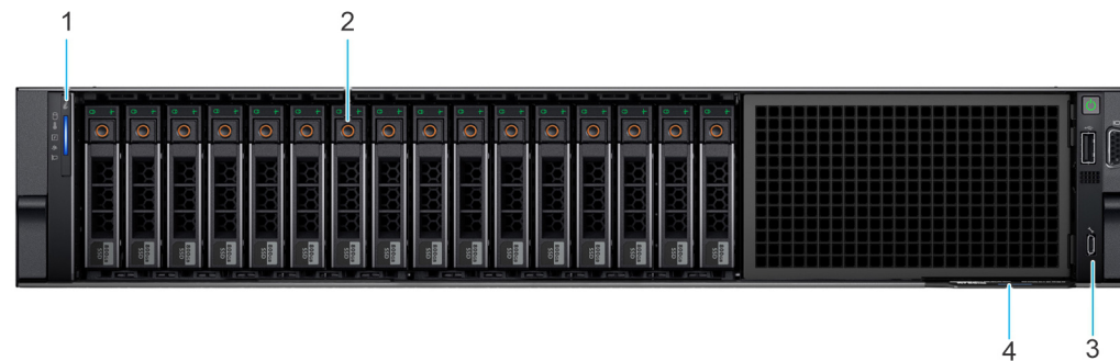
Figura 19. Vista anteriore del sistema 16 unità SAS/SATA da 2,5 pollici
