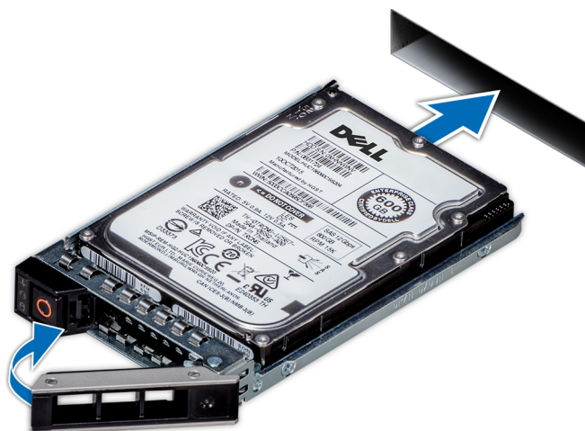
Figura 66. Installazione dell'alloggiamento di un'unità
