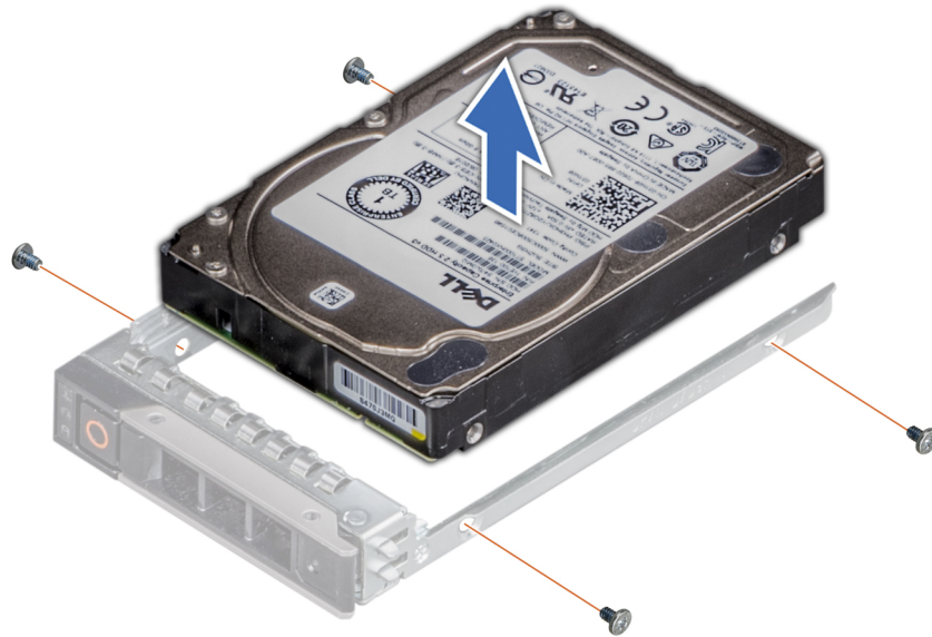
Figura 67. Rimozione di una unità dal relativo alloggiamento
