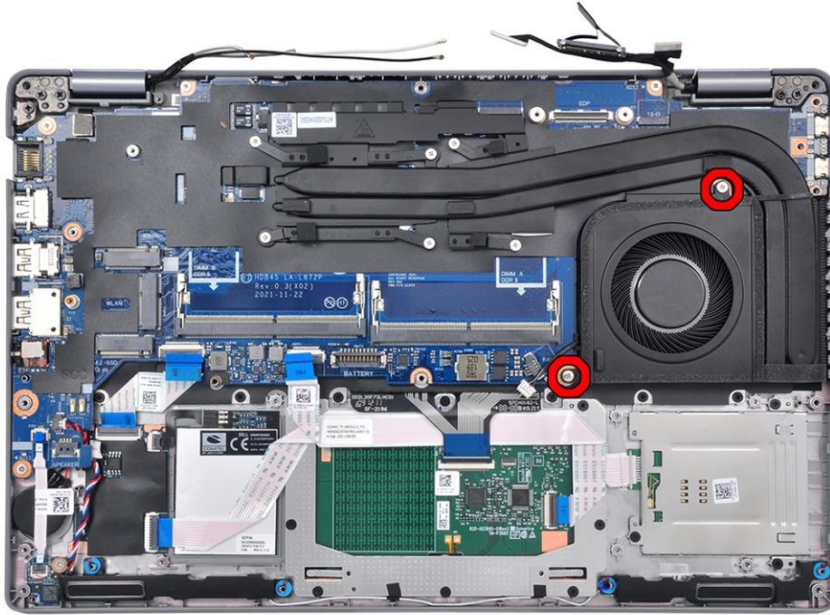
1. Rimuovere le due viti (M2x3) che fissano la staffa del cavo eDP/display alla scheda di sistema.
