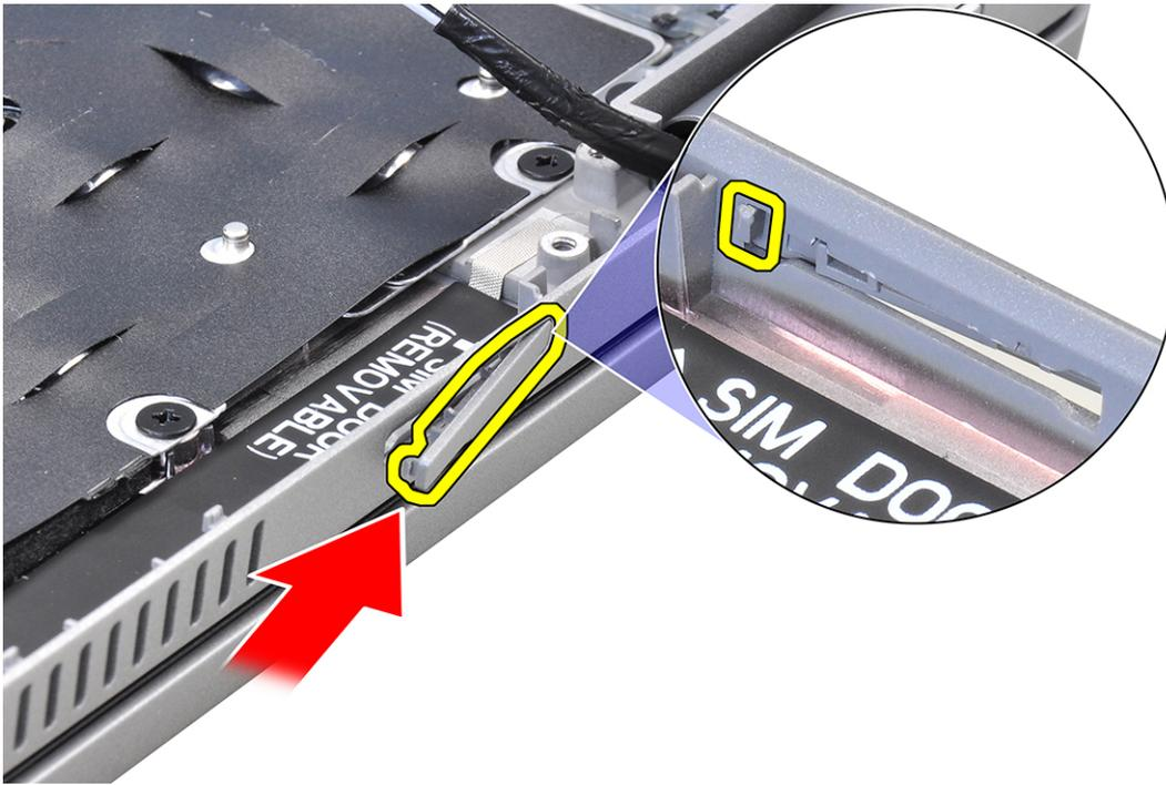
2. Premere il riempimento dell'alloggiamento della scheda SIM fittizia fino a quando non scatta in posizione e accertarsi che si adatti saldamente nello slot della scheda SIM.
