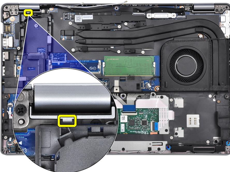
2. Ricollocare le due viti (M2x5) e le sette viti (M2x3) che fissano l'intelaiatura interna del gruppo alla scheda di sistema e al gruppo del poggiapolsi.
