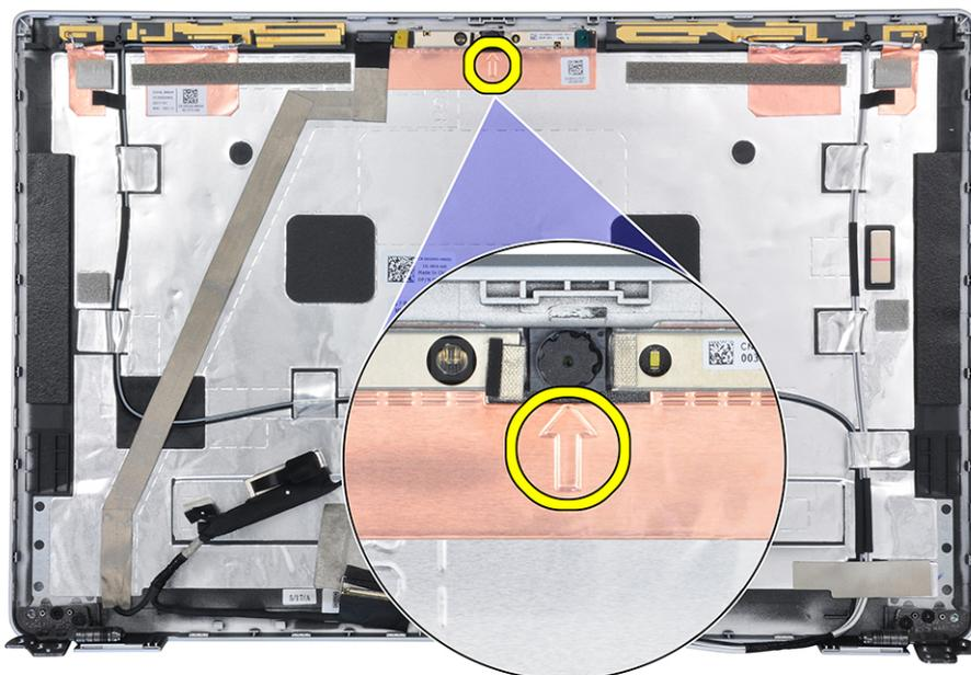
4. Sollevare il modulo della fotocamera accertandosi che i due piccoli perni usati per fissare il modulo in posizioni non siano danneggiati durante il processo di sollevamento. Sollevare con cura il modulo della fotocamera dal coperchio posteriore del display.
