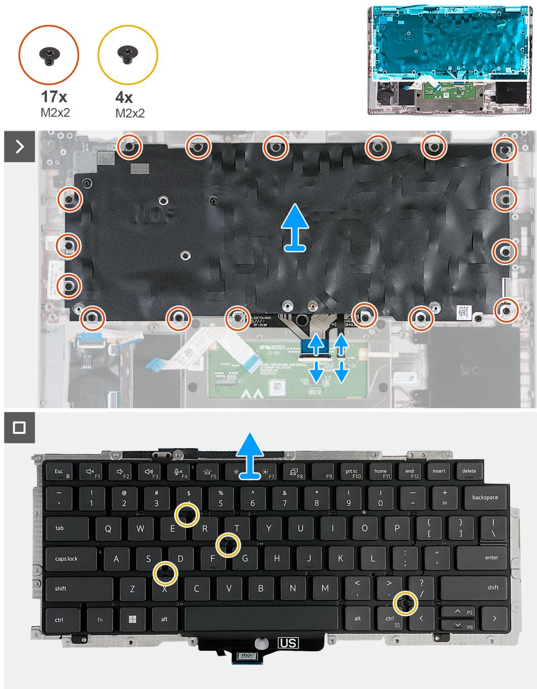
**Figura 61. Rimozione della tastiera**
