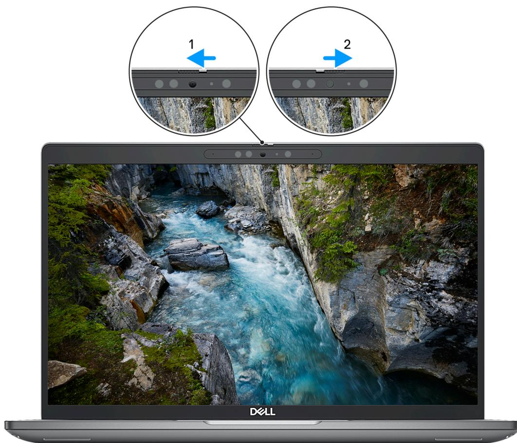
Figura 1. Otturatore fotocamera
