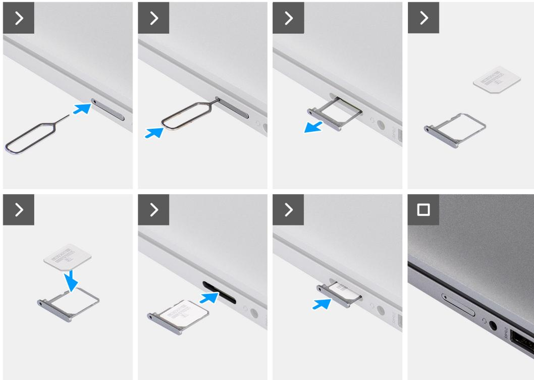
Figura 3. Installazione del vassoio per la scheda SIM
