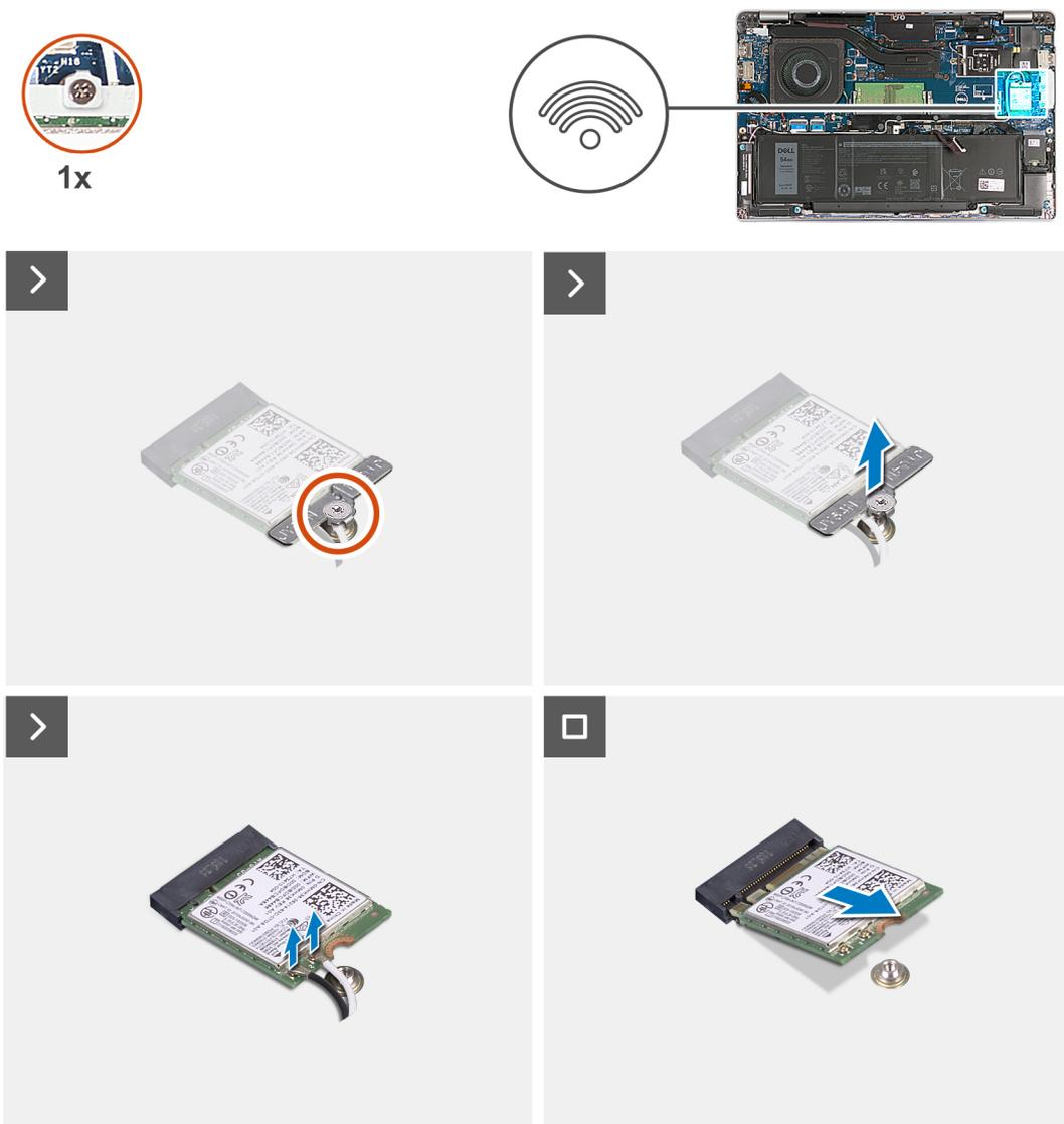
**Figura 10. Rimozione della scheda wireless**
