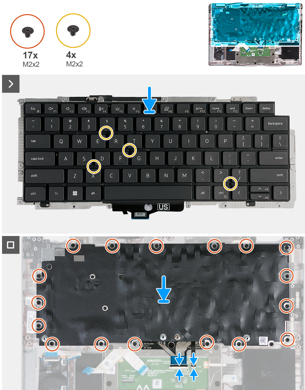
Figura 62. Installazione della tastiera
