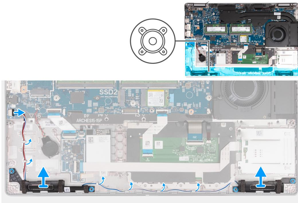
Figura 4. Rimozione degli altoparlanti
