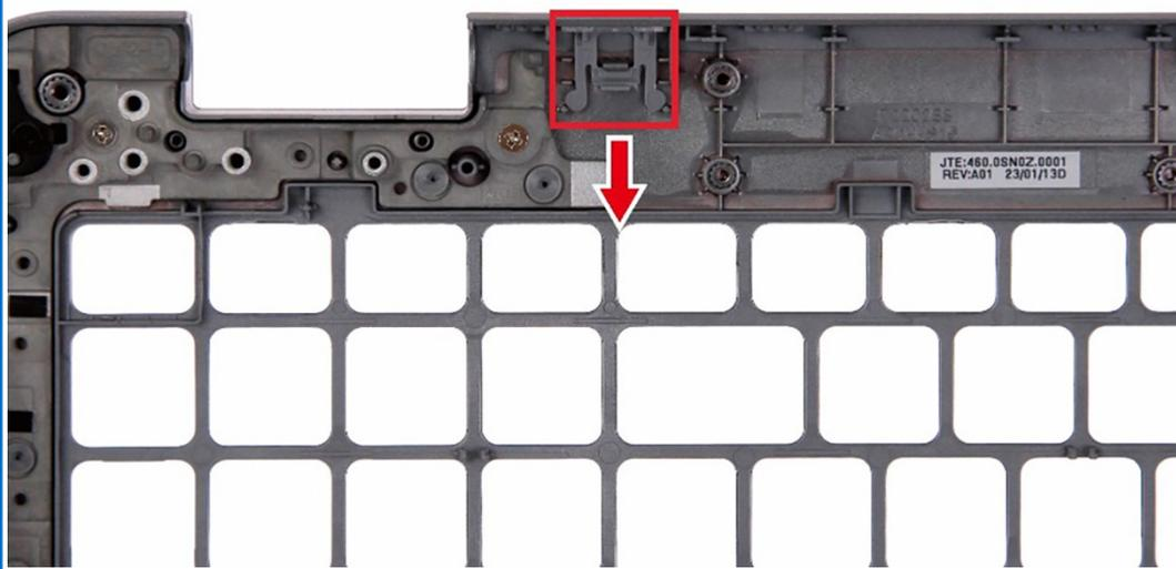
La figura seguente indica la posizione del gruppo poggiapolsi e fornisce una rappresentazione visiva della procedura di rimozione.
