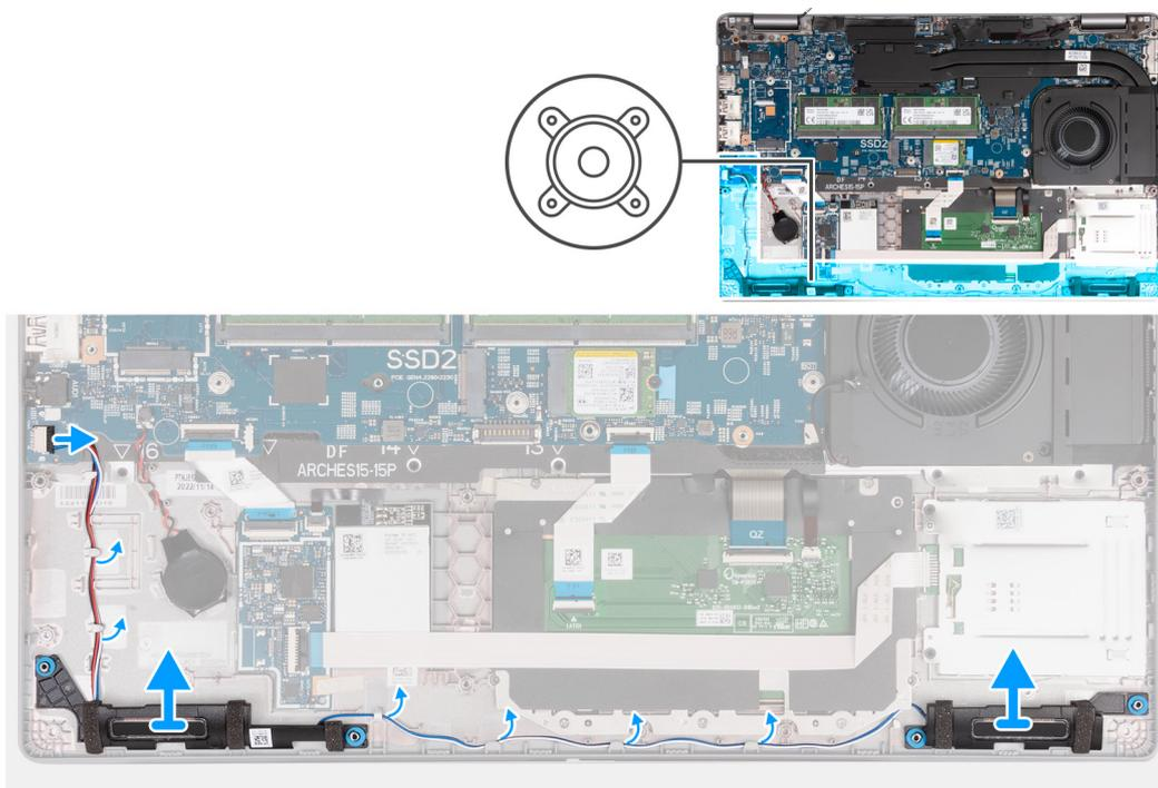
**Figura 4. Rimozione degli altoparlanti**
