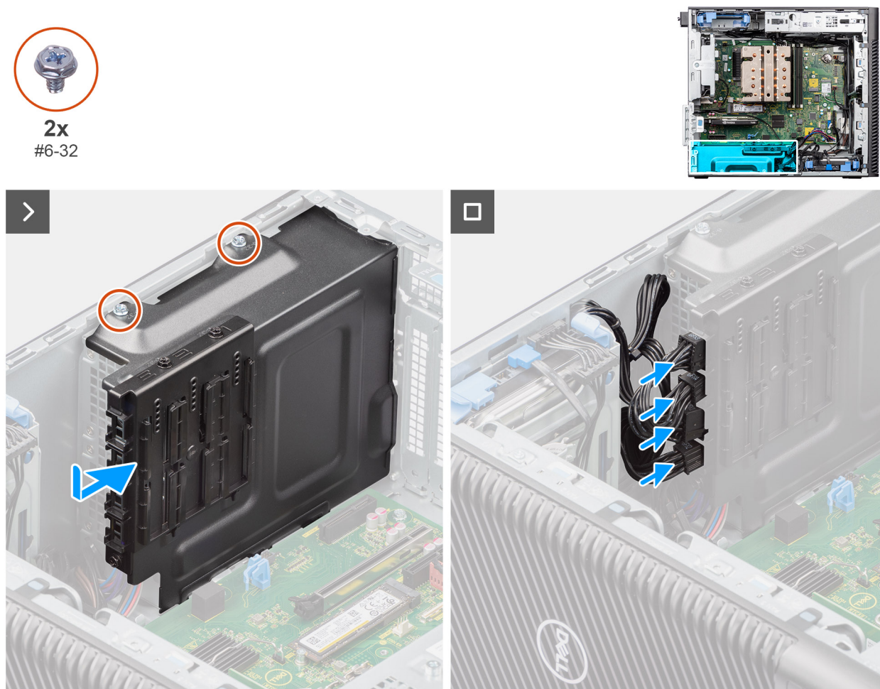
Figura 47. Installazione dell'unità di alimentazione (PSU)
