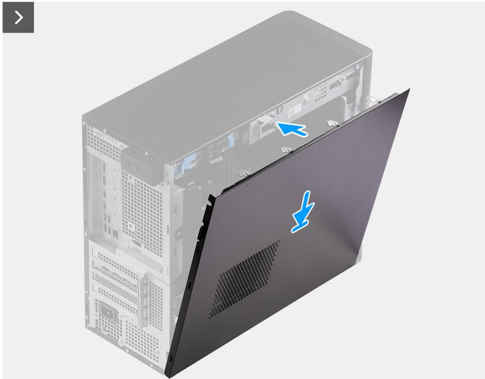
Figura 10. Installazione del coperchio laterale
