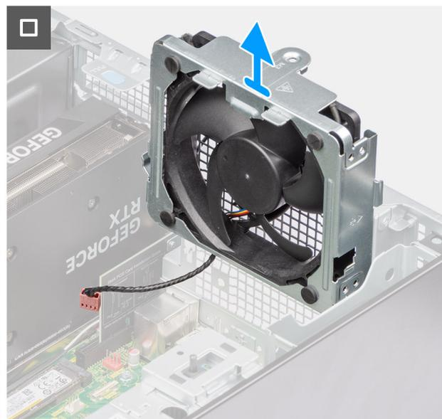
Figura 66. Rimozione della ventola posteriore (PSU da 1.000 W)
