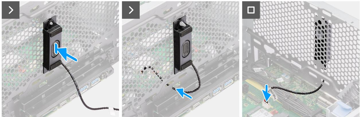
**Figura 73. Installazione dell'altoparlante interno**
