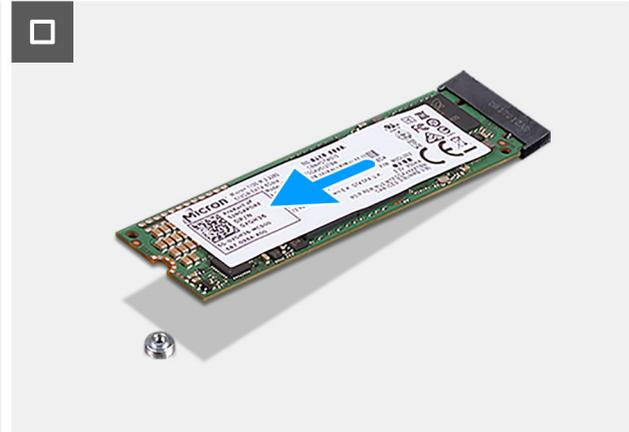
Figura 24. Rimozione dell'unità SSD M.2 2280 PCIe
