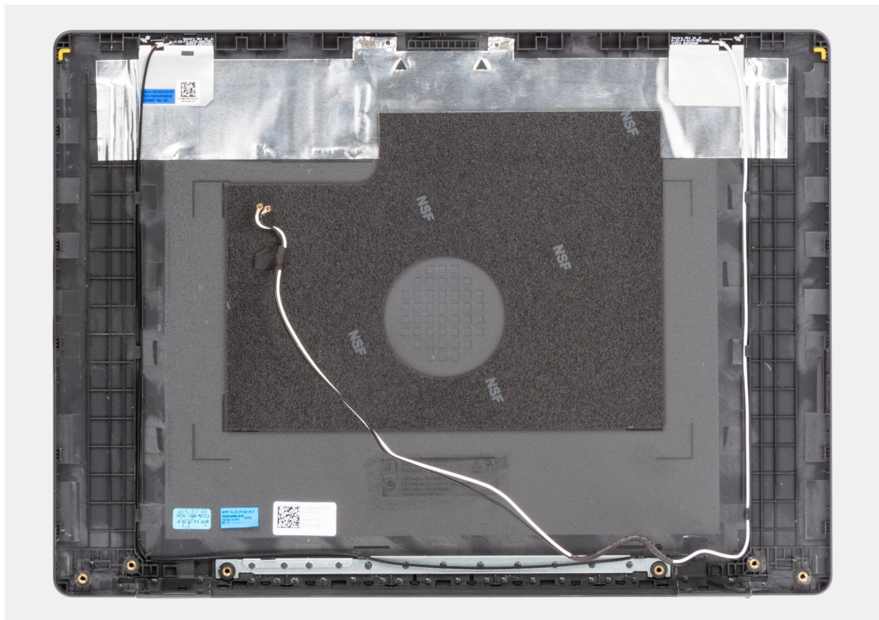
Figura 89. Gruppo del coperchio posteriore del display e antenna
