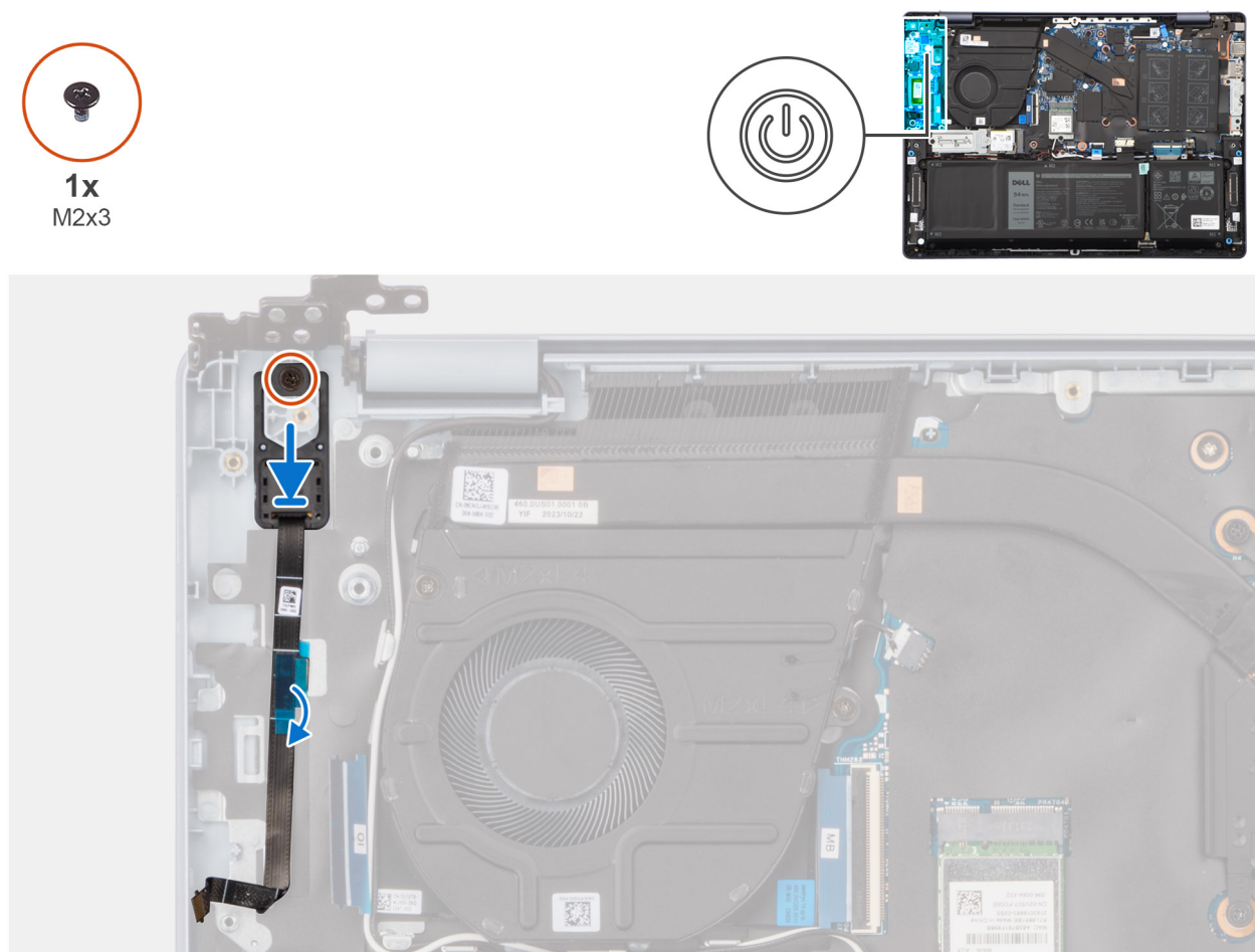
Figura 57. Installazione del pulsante di accensione con lettore di impronte digitali
