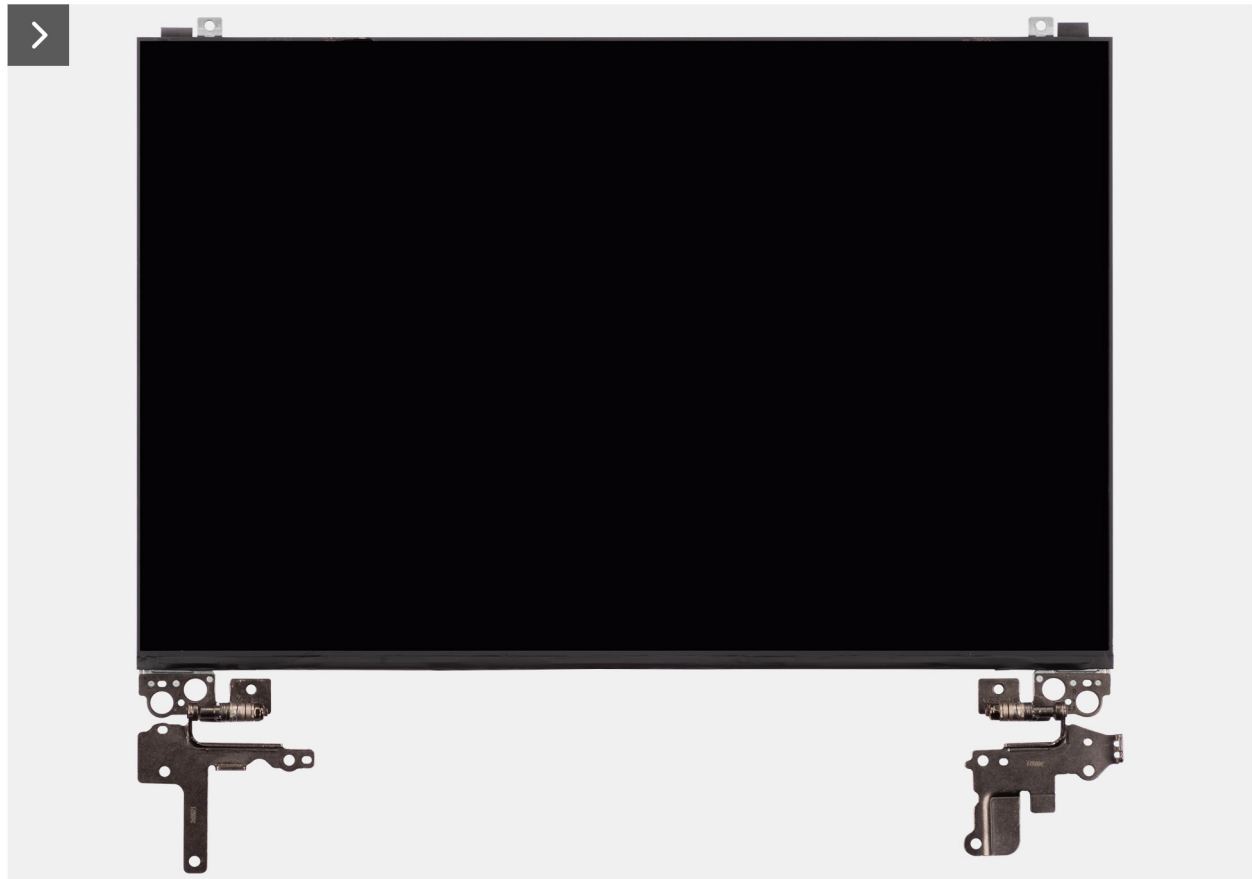
Figura 115. Installazione del gruppo del pannello del display
