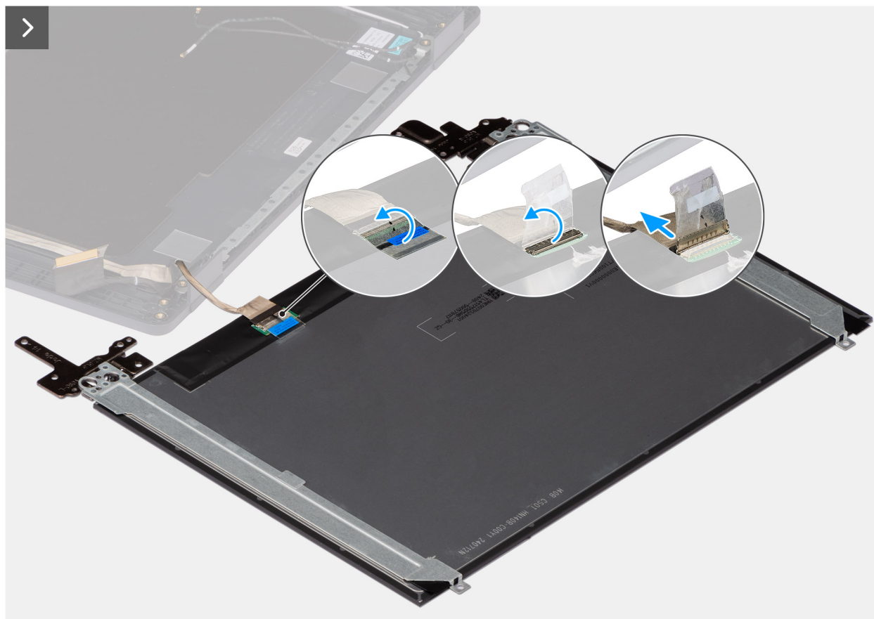
Figura 113. Rimozione del gruppo del pannello del display
