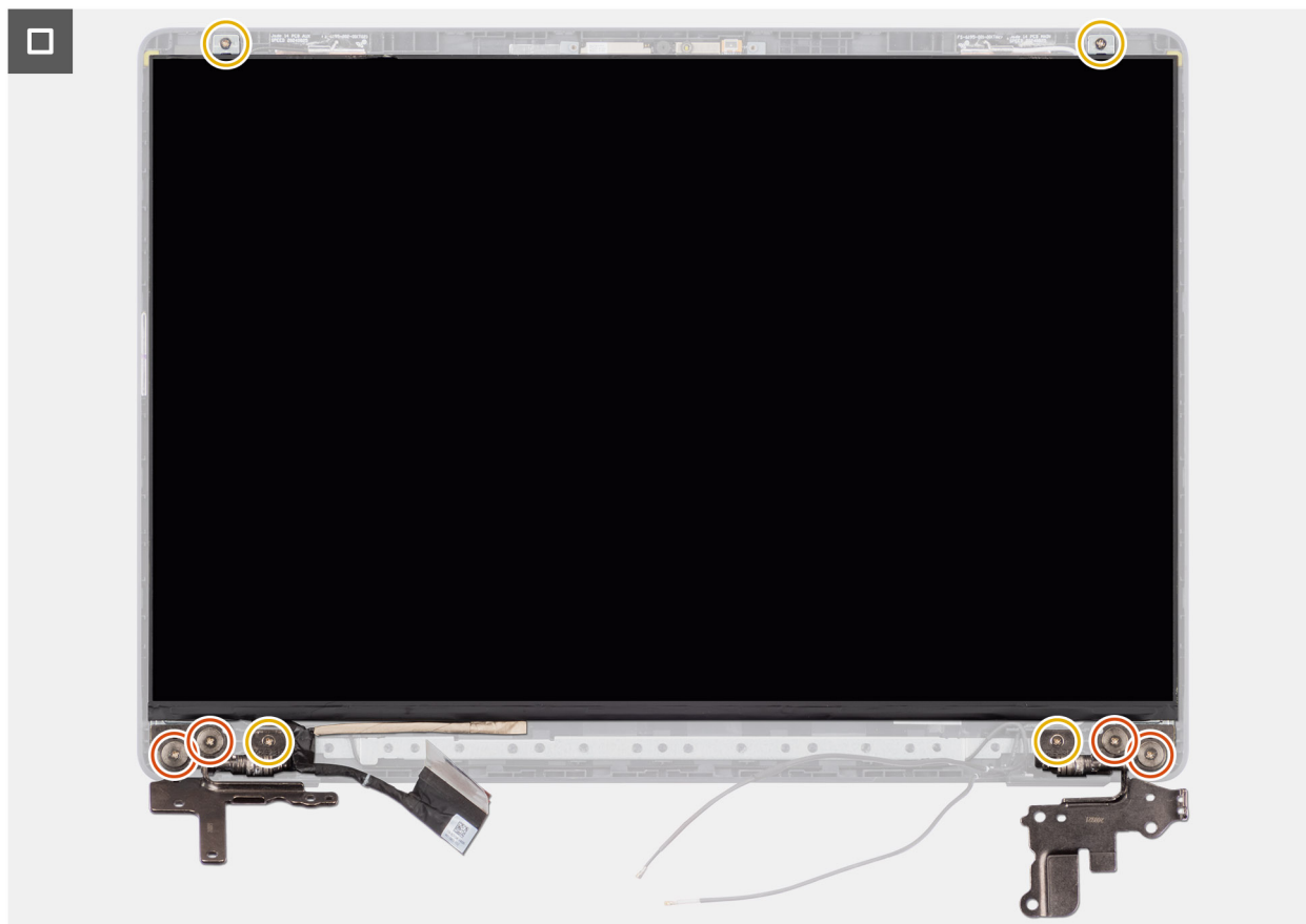
Figura 118. Installazione del gruppo del pannello del display
